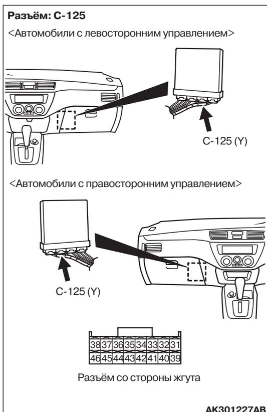
**ЭТАП 12. Измерение напряжения на контактах разъёма С-125 блока управления двигателем**
