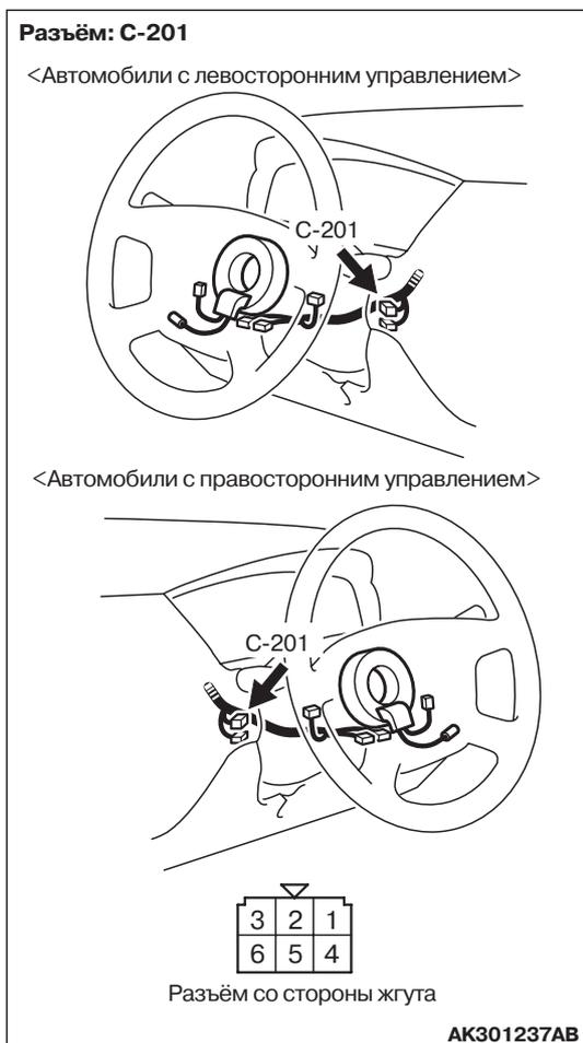
**ЭТАП 15. Проверьте жгут между разъёмом С-201 (контакт № 2) выключателя зажигания и контактом № 1 разъёма С-220 реле 2 электробензонасоса**
