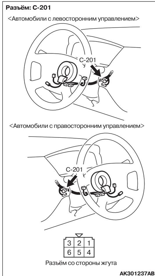
**ДА :** Проверьте промежуточные разъёмы С-04, С-13\*<sup>1</sup> или С-137\*<sup>2</sup>, С-03\*<sup>1</sup>, С-212 и С-210 и, если нужно, отремонтируйте. Если промежуточные разъёмы исправны, то проверьте и отремонтируйте жгут между промежуточным разъёмом В-18 (контакт № 5) и разъёмом С-201 (контакт № 2) выключателя зажигания.
