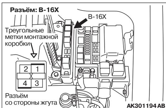
**ЭТАП 5. Проверьте жгут между разъёмом
