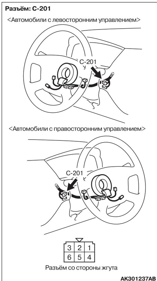
**ДА :** Проверьте промежуточные разъёмы С-14\*<sup>1</sup> или С-136\*<sup>2</sup> и В-18, если нужно, отремонтируйте. Если промежуточные разъёмы исправны, то проверьте и отремонтируйте жгут между разъёмом С-201 (контакт № 5) выключателя зажигания и разъёмом В-23 (контакт № 1) стартера.
