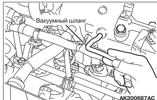
11. Отсоедините вакуумный шланг от регулятора давления топлива и измерьте давление, зажав пальцем открытый конец шланга.
