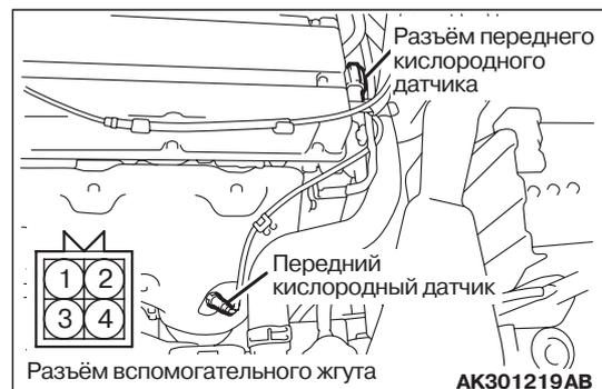
1. Отсоедините разъём от кислородного датчика и присоедините к датчику специальный жгут MD998464.
