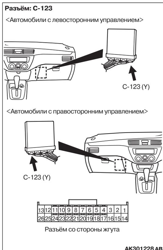
**ЭТАП 9. Проверьте жгут между разъёмом
