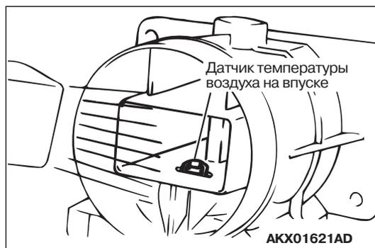
4. Измерьте сопротивление, подогревая датчик при помощи фена.
