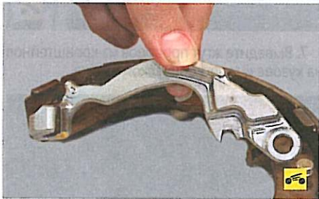
14. ...и рычаг. Установите разжимной рычаг на новую колодку в обратном порядке.
