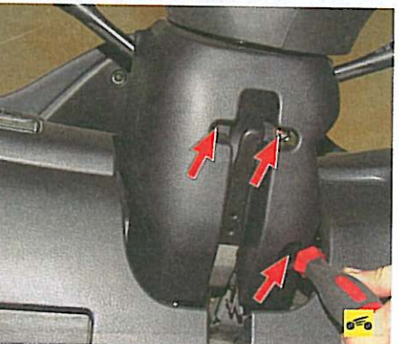
9. Выверните три стяжных винта крепления частей кожаной рулевой колонки...
