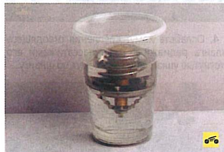
6. Для проверки опустите термостат в емкость с водой, подогретой до 78-80^\circ\text{C} . Постепенно нагревая воду, следите за температурой начала открытия клапана термостата.
