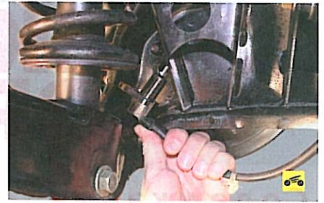
6. ...извлеките датчик частоты вращения заднего колеса из отверстия в продольном рычаге...
