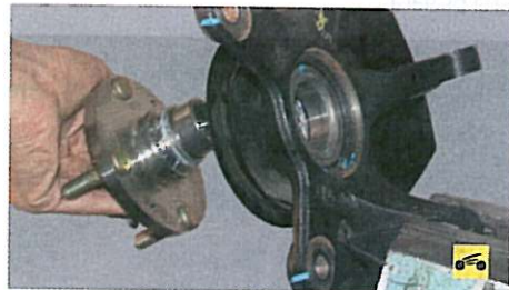
10. Снимите ступицу. Вероятнее всего, на ступице останется наружная половина внутреннего кольца подшипника.
