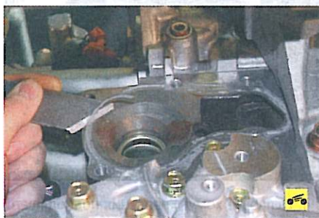
10. Очистите от герметика сопрягаемые поверхности блока цилиндров...
