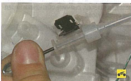
7. ...затем выньте наконечники оболочек тяг из пружинных фиксаторов.
