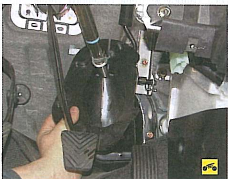
16. ...и снимите уплотнитель рулевого механизма.
