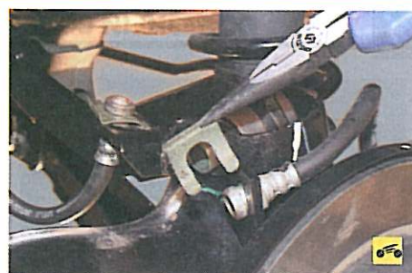
17. ...снимите скобу крепления наконечника...
