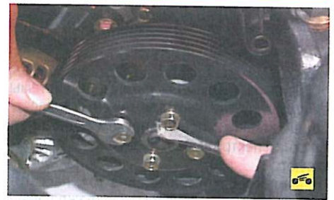
3. Ослабьте затяжку болтов крепления шкива водяного насоса, удерживая шкив от проворачивания отверткой...
