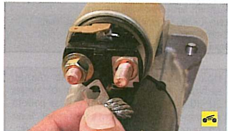
1. Отверните гайку на правом контактном болте тягового реле...
