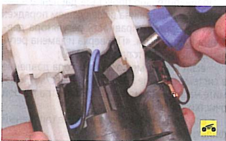
13. Поддев пластмассовый фиксатор...
