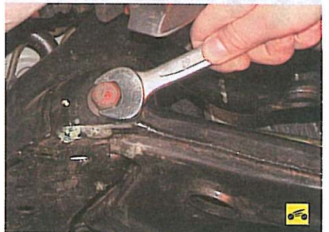
6. Ослабьте затяжку переднего болта крепления рычага подвески к поперечине...
