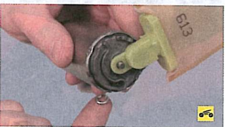
17. ...снимите фиксирующую шайбу фильтра грубой очистки топлива.
