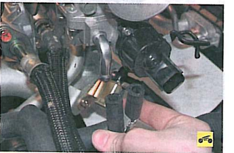
22. Отсоедините шланги от штуцеров клапана продувки адсорбера.
