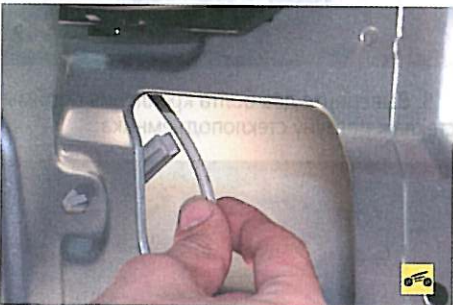
11. Выведите оболочку троса стеклоподъемника из зацепления с пластмассовым фиксатором в двери...
