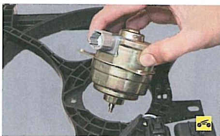
6. ...и извлеките электродвигатель вентилятора из кожуха.
