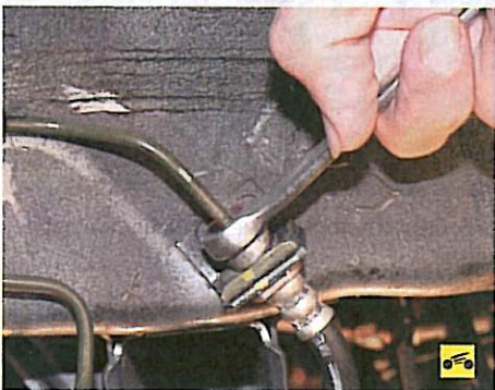
10. Для замены переднего шланга тормозного механизма заднего колеса отверните гайку крепления тормозной трубки к переднему наконечнику шланга...
