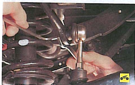
3. Придерживая шарнир стойки от проворачивания, отверните гайку его крепления к штанге стабилизатора...
