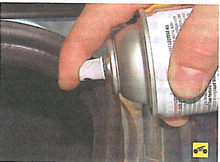
15. ...и проема багажника (силиконовая смазка в аэрозольной упаковке).
