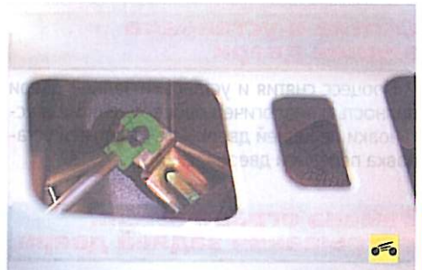
10. Внутри двери, отстегнув отверткой фиксатор, отсоедините от замка тягу блокировки.
