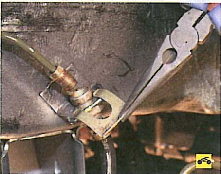
11. ...снимите скобу крепления наконечника...
