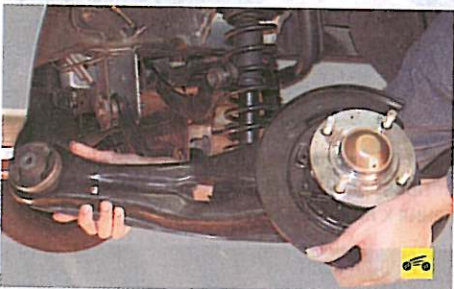
12. ...и снимите продольный рычаг в сборе со ступицей заднего колеса.
