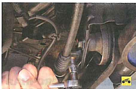
4. Выверните болт крепления кронштейна оболочки троса к рычагу задней подвески...
