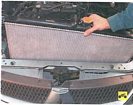
8. Извлеките радиатор из моторного отсека.
