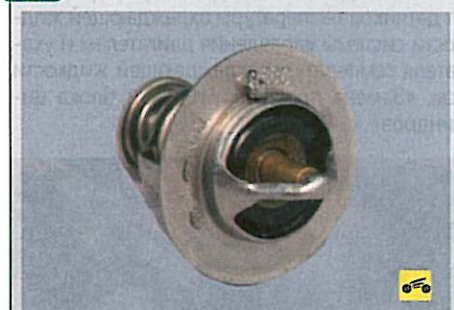
Так выглядит снятый с автомобиля термостат. Обратите внимание на его маркировку, чтобы при замене приобрести такой же.
