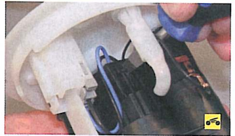
14. ...отсоедините колодку жгута проводов от электробензонасоса...
