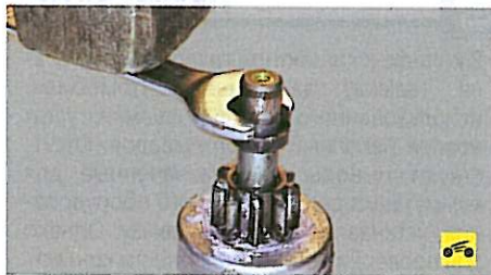
16. Для замены муфты привода сдвиньте по валу привода ограничительное кольцо, как показано на фото.
