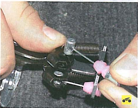
6. ...и, вынув наконечник троса из прорези рычага, отсоедините трос.
