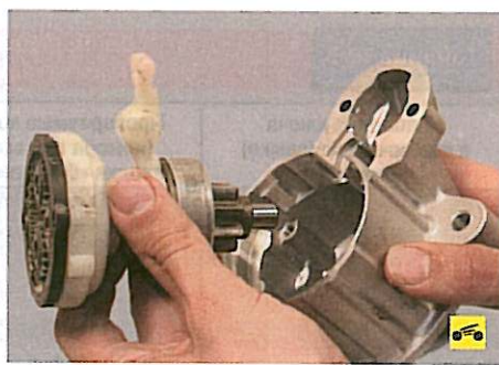
13. Извлеките из крышки вал привода вместе с рычагом...
