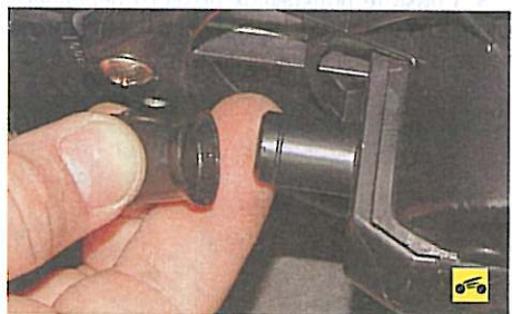
6. ...снимите с патрубка электродвигателя вентилятора шланг вентиляции щеточного узла электродвигателя...
