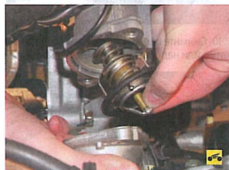
4. ...отведите крышку в сторону, не отсоединяя от нее шланг, и выньте термостат из корпуса.
