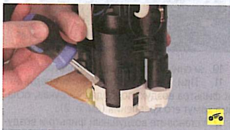
10. Поддев пластмассовые фиксаторы...
