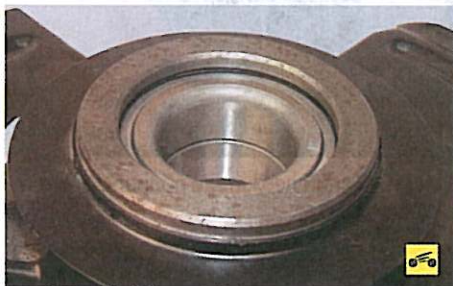
18. Запрессуйте новый подшипник в корпус поворотного кулака до упора.
