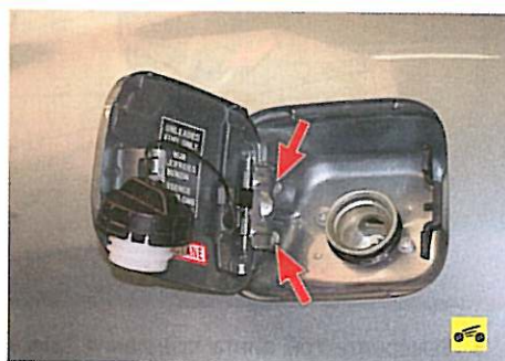
2. Выверните два болта крепления и снимите крышку. При необходимости отсоедините от крышки пробку горловины наливной трубы.
