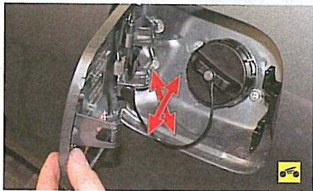
3. Устанавливайте крышку люка наливной трубы топливного бака в порядке, обратном снятию. При необходимости отрегулируйте положение крышки относительно проема люка, перемещая крышку в нужном направлении при ослабленных болтах ее крепления.
