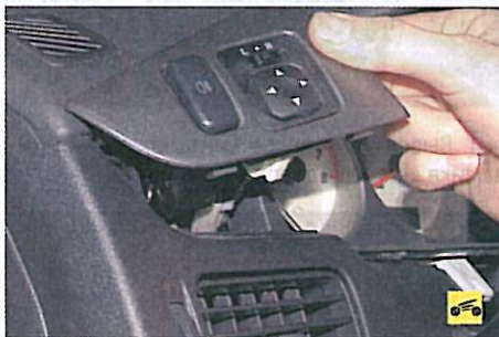
3. Извлеките блок управления наружными зеркалами из панели приборов.
