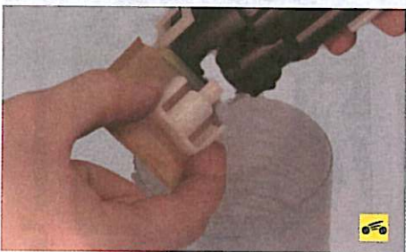
9. ...снимите заглушку топливного фильтра и слейте остаток топлива из фильтра.
