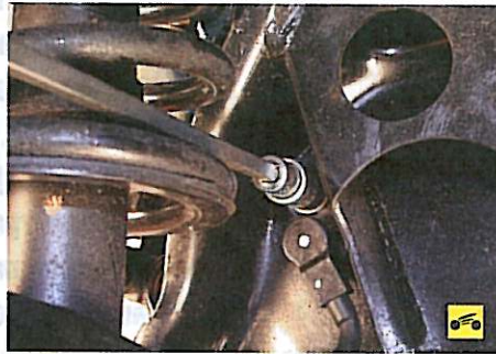
3. ...и заднего держателей. 4. Извлеките пластмассовый зажим из отверстия в продольном рычаге.
