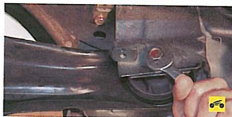
10. Выверните болт крепления продольного рычага к кронштейну на кузове...
