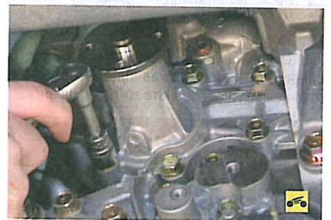
7. Выверните шесть болтов крепления водяного насоса...
