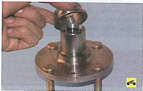
12. ...снимите со ступицы наружную половину внутреннего кольца подшипника.
