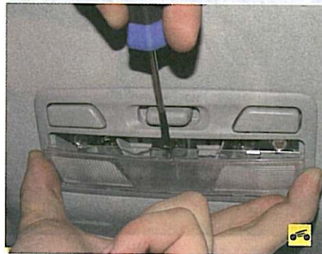
1. Подденьте рассеиватель плафона отверткой, обернутой изоляционной лентой...
