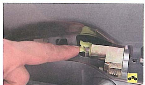
8. Отгибая пластмассовые фиксаторы, извлеките тягу привода замка из держателя...
