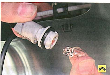
3. ...и извлеките лампу из патрона. 4. Установите лампы фонарей освещения номерного знака в порядке, обратном снятию. Для замены лампы фонаря освещения багажника вам потребуется отвертка с плоским лезвием.
