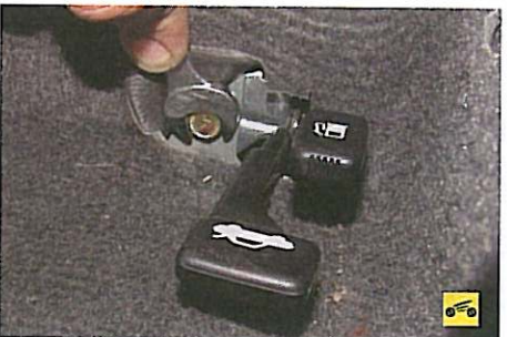
2. Выверните через окно в коврик пола болт крепления блока рукояток.
