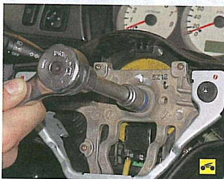
8. Ослабьте затяжку гайки крепления рулевого колеса к рулевому валу, удерживая рулевое колесо от проворачивания.
