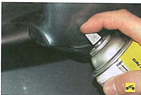
13. Шарниры наружных зеркал (силиконовая смазка или ВТВ-1 в аэрозольной упаковке).
