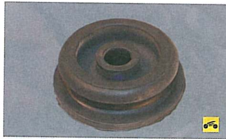
10. ...сильно деформированные или затвердевшие подушки замените.
