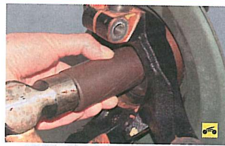
9. ...и выбейте ступицу из кулака молотком, используя оправку подходящего диаметра.
