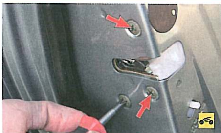
3. Выверните три винта крепления замка к панели двери и сдвиньте замок внутри двери вниз.
