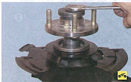
20. Запрессуйте съемником ступицу в подшипник до упора, установив под внутреннее кольцо подшипника опору.
