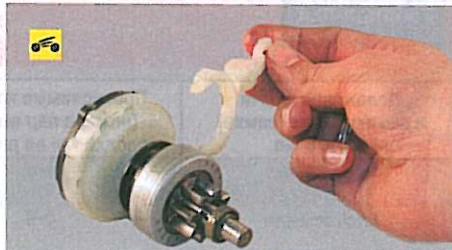
14. ...и снимите рычаг с муфты привода. 15. Снимите с оси водила три планетарные шестерни редуктора.
