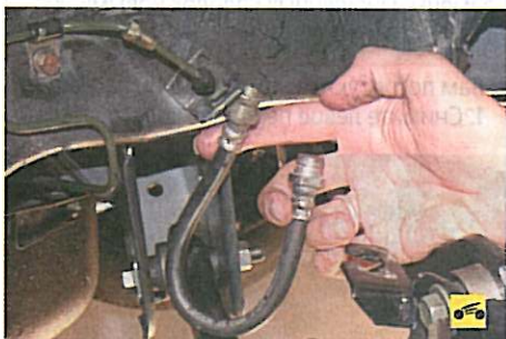
15. ...выньте наконечник из кронштейна на продольном рычаге и снимите шланг.
