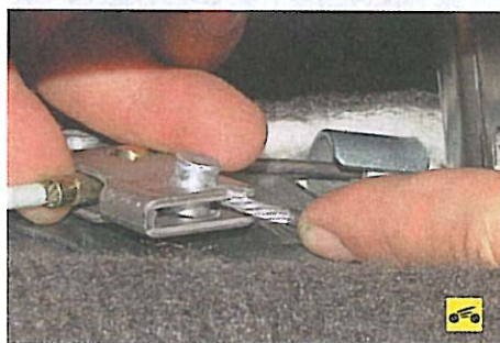
12. Выведите наконечники задних тросов из прорезей в уравниателе и снимите передний трос вместе с уравниателем.
