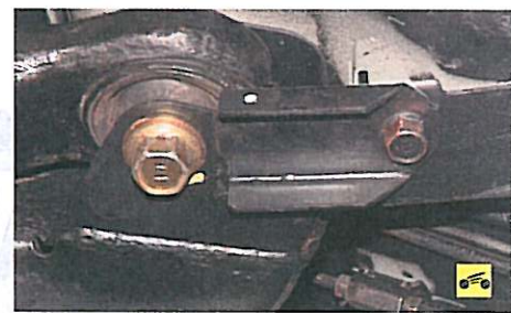
8. Выверните по два болта заднего крепления поперечины передней подвески с левой и правой стороны...
