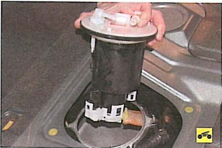
7. ...и извлеките из топливного бака топливный насос вместе с резиновой уплотнительной прокладкой.
