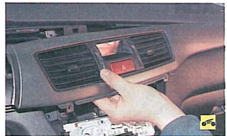
9. ...и, преодолевая сопротивление пластмассовых фиксаторов, извлеките облицовку из места установки.
