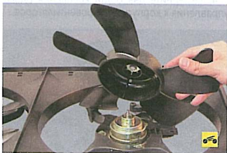
3. ...и снимите крыльчатку с вала электродвигателя.
