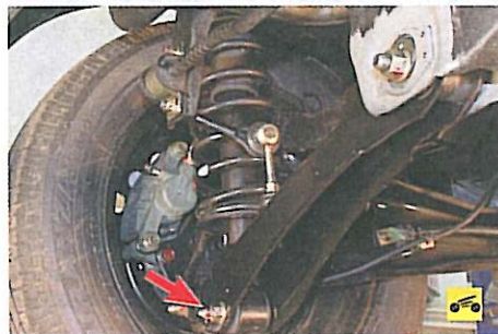
Рис. 4.4. Детали задней подвески: 1 – верхний поперечный рычаг; 2 – рычаг управления; 3 – продольный рычаг; 4 – нижний поперечный рычаг; 5 – стабилизатор поперечной устойчивости задней подвески; 6 – телескопическая стойка задней подвески
