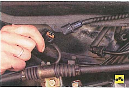
1. Разъедините колодку жгута проводов датчика.
