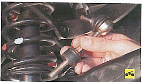
4. ...и снимите стойку стабилизатора.
