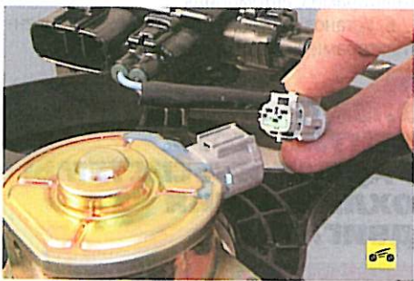
4. Отсоедините от выводов электродвигателя вентилятора системы охлаждения колодку жгута проводов.
