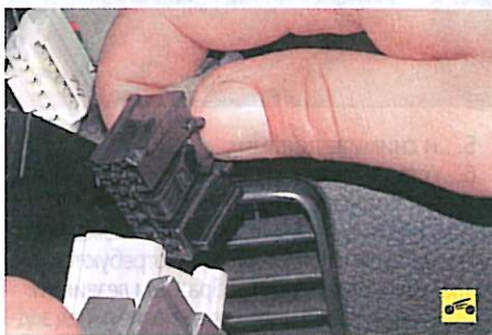
4. Отсоедините колодки жгута проводов от блока управления наружными зеркалами и от выключателя противотуманного фонаря.
