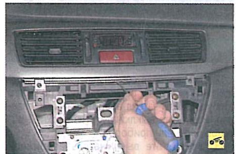
8. ...подденьте облицовку отверткой...
