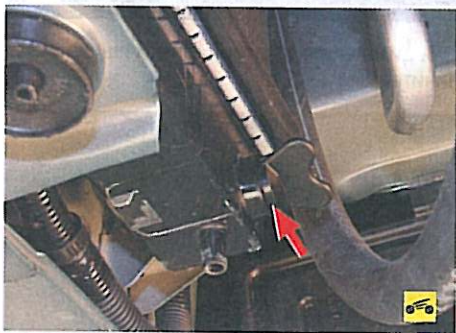
4. Подставьте емкость под отверстие сливного крана радиатора системы охлаждения, расположенного в правой части нижнего
