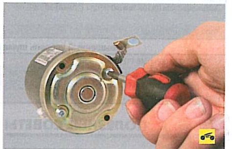
7. Выверните два винта крепления крышки со стороны коллектора к статору...
