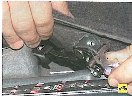
4. ...отогните край коврика и извлеките из-под коврика блок рукояток вместе с тросами приводов.
