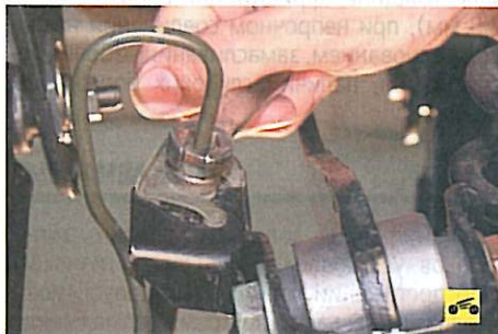
13. Отверните гайку крепления тормозной трубки к заднему наконечнику шланга...
