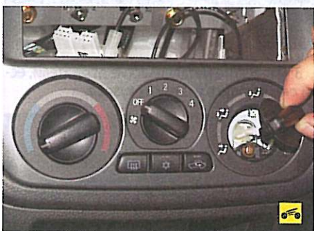
8. Снимите три рукоятки блока управления, преодолев упругое сопротивление деталей.
