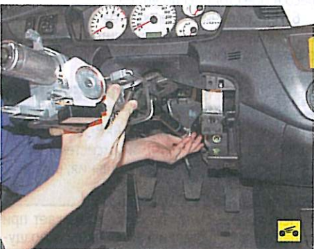
20. ...и снимите рулевую колонку, разъединив ее с валом-шестерней рулевого механизма.
