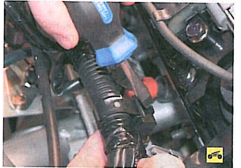
20. Отсоедините пластмассовые держатели моторного жгута проводов от кронштейнов крепления...
