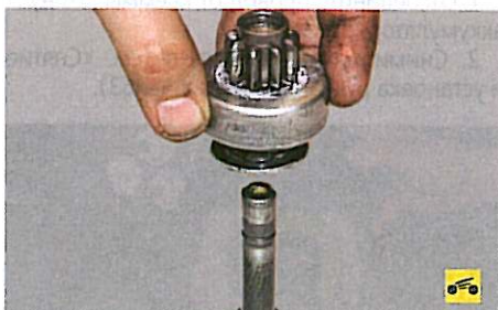
18. Снимите ограничительное кольцо и муфту с вала привода.
