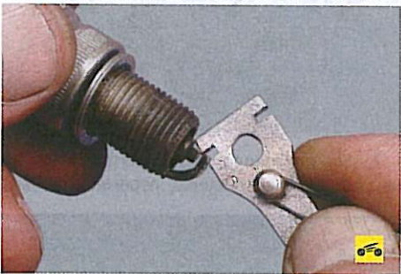
7. Если зазор отличается от указанного, отрегулируйте его, подгибая боковой электрод.
