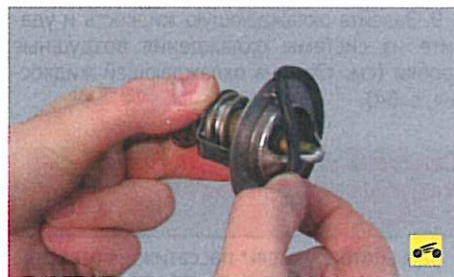
5. Снимите с термостата уплотнительное кольцо. Сильно обжатое, затвердевшее или надорванное кольцо замените.
