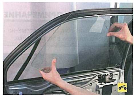
9. ...и аккуратно, не повреждая лакокрасочное покрытие двери, снимите опускное стекло, выводя его вверх из двери.
