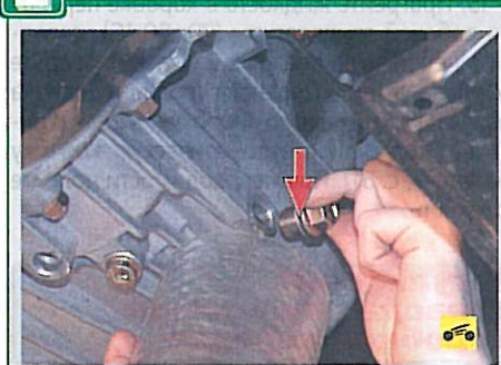
Рис. 4.5. Расположение пробки сливного отверстия автоматической коробки передач
