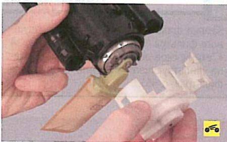
11. ...снимите крышку электробензонасоса.
