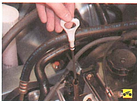
2. Маслоизмерительным щупом измерьте уровень масла. Он должен быть между верхней и нижней метками.
