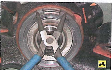
13. Снимите стопорное кольцо подшипника съемником стопорных колец.
