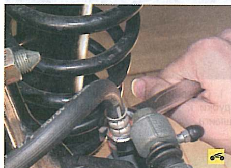
19. ...выверните второй наконечник тормозного шланга из колесного цилиндра и снимите шланг.
