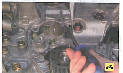
8. ...подденьте корпус водяного насоса отверткой за выемку...
