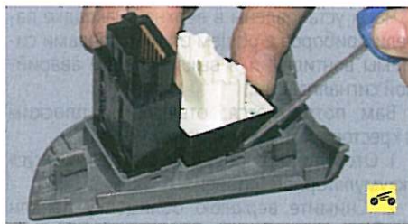
5. Поддев отверткой, извлеките из накладки блок управления наружными зеркалами заднего вида.
