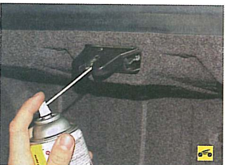
9. ...и крышки багажника (силиконовая смазка или ВТВ-1 в аэрозольной упаковке).
