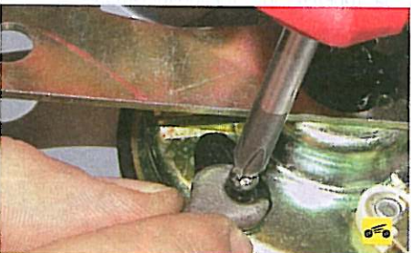
Замыкание контактов левого подрулевого переключателя
