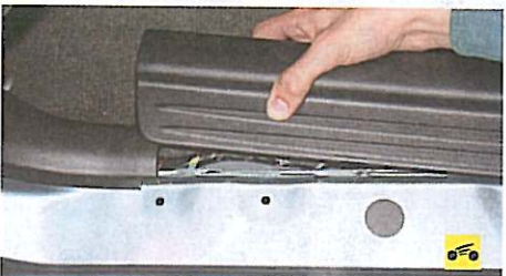
1. Преодолевая сопротивление пластмассовых держателей, снимите облицовку порога водительской двери.
