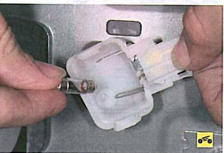
3. ...и извлеките из него лампу. 4. Установите лампу в порядке, обратном снятию.
