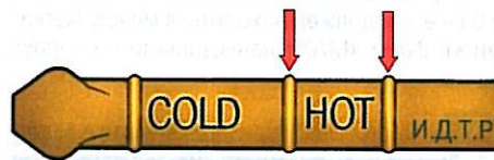
Рис. 4.2. Метки на указателе уровня рабочей жидкости (щупе) автоматической коробки передач
