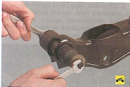
13. Выпрессуйте съемником наружный сайлентблок из проушины рычага.
