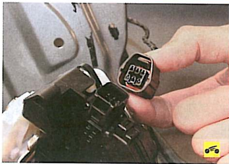
13. ...колодку жгута проводов...
