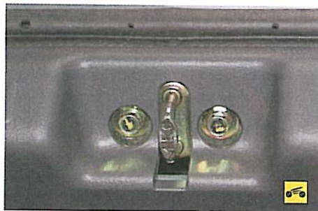
12. ...и крышки багажника (консистентная смазка, например ФИОЛ).
