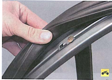
3. Отогните уплотнитель задней двери...
