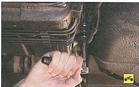
6. Выверните болт кронштейна крепления оболочки троса к кузову.
