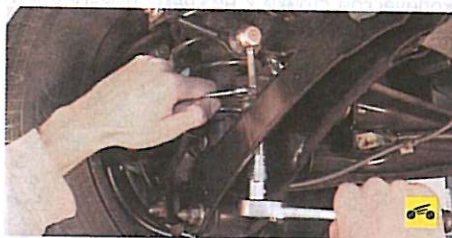
1. Удерживая ключом стойку стабилизатора от проворачивания, другим ключом отверните гайку крепления стойки к нижнему рычагу...
