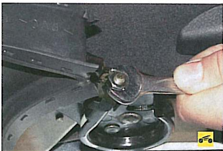
8. ...отверните регулировочную гайку наконечника переднего троса стояночного тормоза...
