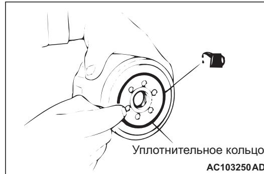
6. Нанести на уплотнительное кольцо нового масляного фильтра небольшое количество моторного масла.
