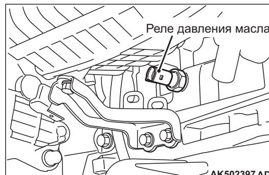
2. Снять реле давления масла (см. Снятие и установка реле давления масла [Стр.12-5](#)).
