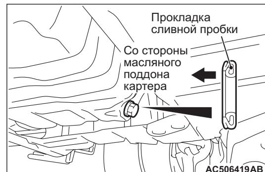
4. Установить новую прокладку пробки слива, направив ее, как показано на рисунке, затем затянуть пробку слива до указанного момента затяжки.
