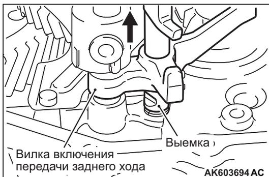
2. Совместите выемку на стержне вилки переключения передач № 3 с вилкой включения передачи заднего хода в нейтральном положении, и переместите ролик вилки включения передачи заднего хода на сторону вилки переключения передач № 3.
