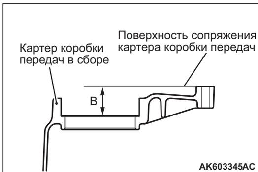
5. Установите прямой конец на ответную поверхность картера коробки передач и измерьте расстояние «В», используя штангенциркуль с нониусом.
