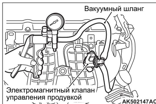
1. Снять электромагнитный клапан управления продувкой с впускного коллектора и закрыть установочное отверстие лентой или чем-либо еще.
