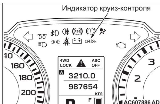
2. Считать код диагностики, следя за мигающими сигналами сигнальной лампы круиз-контроля, расположенной на комбинированном счетчике.
