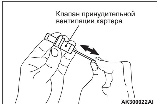
1. Вставить тонкий стержень в отверстие клапана принудительной вентиляции картера со стороны, показанной на рисунке (сторона установки в крышку коромысла), и перемещать стержень вперед и назад, чтобы проверить перемещение штока.
