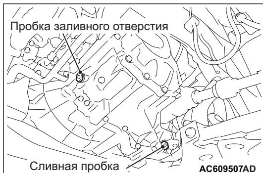
1. Снимите заливную пробку.
