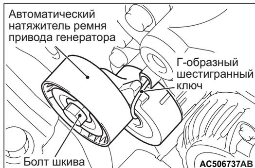
1. Для фиксации положения автоматического натяжителя ремня привода генератора, поверните натяжитель против часовой стрелки и вставьте в его отверстие Г-образный шестигранный ключ.
