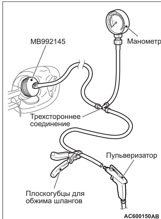
2. Установите шланг и манометр на специальный инструмент, как показано на рисунке.
