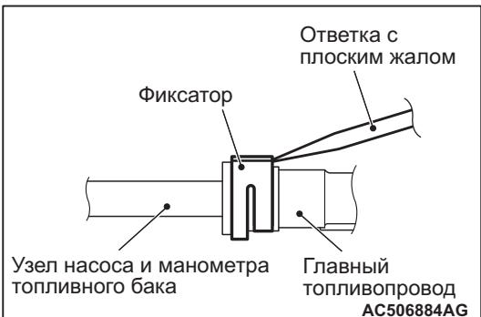
3. Вставить плоскую отвертку (ширина 6 мм и толщина 1 мм) в стопор главного топливопровода.
