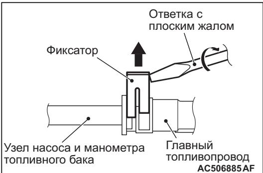
4. Повернуть плоскую отвертку, вставленную в стопор, на 90 градусов, чтобы поднять стопор, и отсоединить главный топливопровод от узла насоса и манометра топливного бака.
