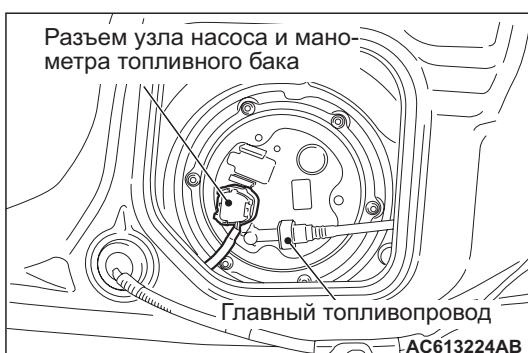
2. Снять смотровой люк пола (LH).
