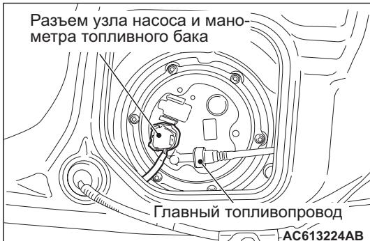
14. Подключить соединитель насоса и манометра топливного бака.
