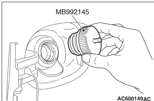
1. Снимите крышку горловины топливного бака, установите взамен крышку специального инструмента для проверки утечки топлива (MB992145).
