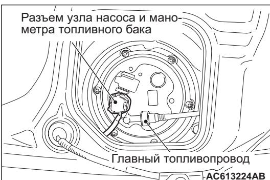
2. Отсоединить соединитель узла насоса и манометра топливного бака.
