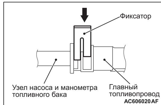
2. Надежно присоединить разъем главного топливопровода к узлу насоса и манометра топливного бака и опустить вниз стопор разъема для стопорения.
