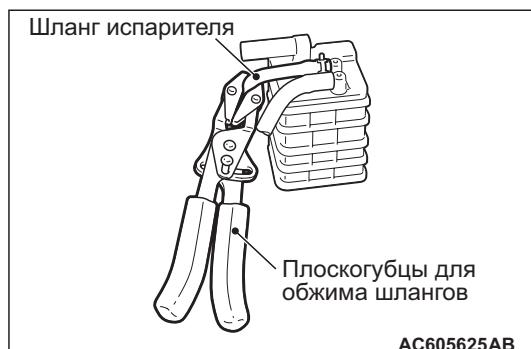
3. Заблокируйте шланг расширительного бачка (со стороны топливного бака).
