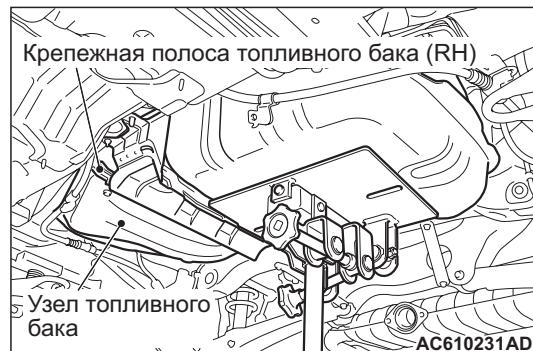
2. Поддерживая топливный бак с помощью подъемников, снимите крепежную полосу топливного бака (RH).
