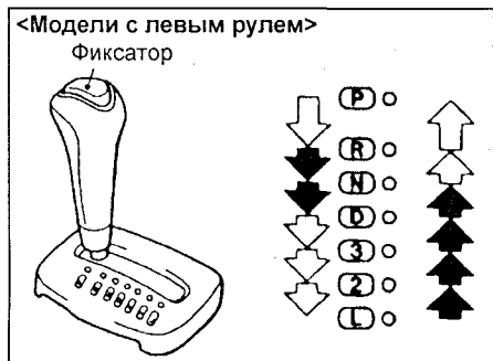
АКПП без режима "SPORT" (Рычаг селектора можно установить в позиции: "P", "R", "N", "D", "3", "2" и "L").
