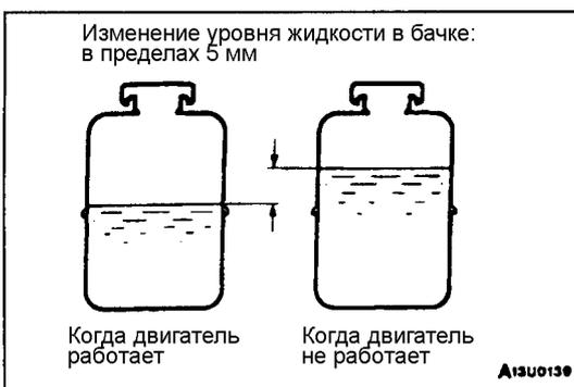
10. Проверьте, чтобы разница уровней рабочей жидкости в бачке при работающем и неработающем двигателе находилась в пределах 5 мм.
