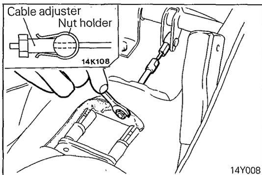
**PARKING BRAKE LEVER STROKE CHECK**
