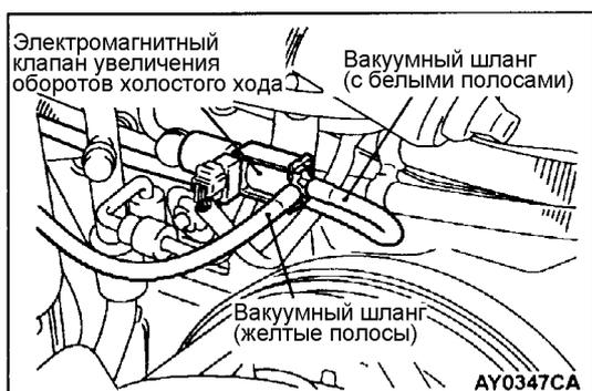
**ПРОВЕРКА ЭЛЕКТРОМАГНИТНОГО КЛАПАНА
