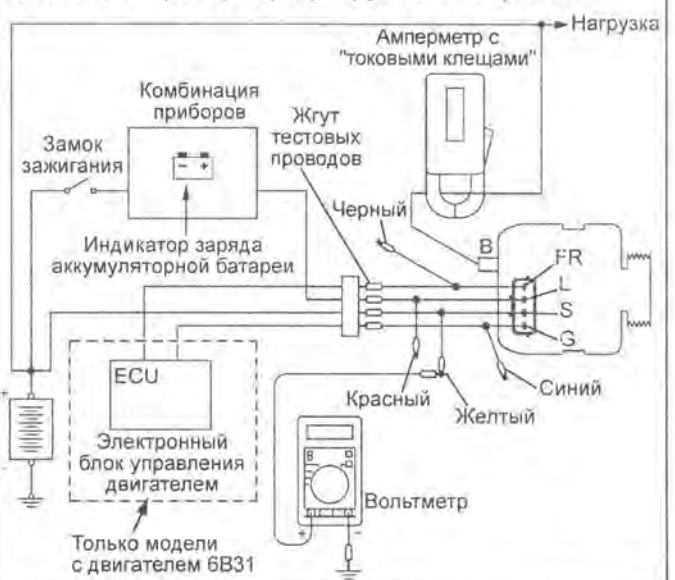
Схема для проверки регулируемого напряжения.
