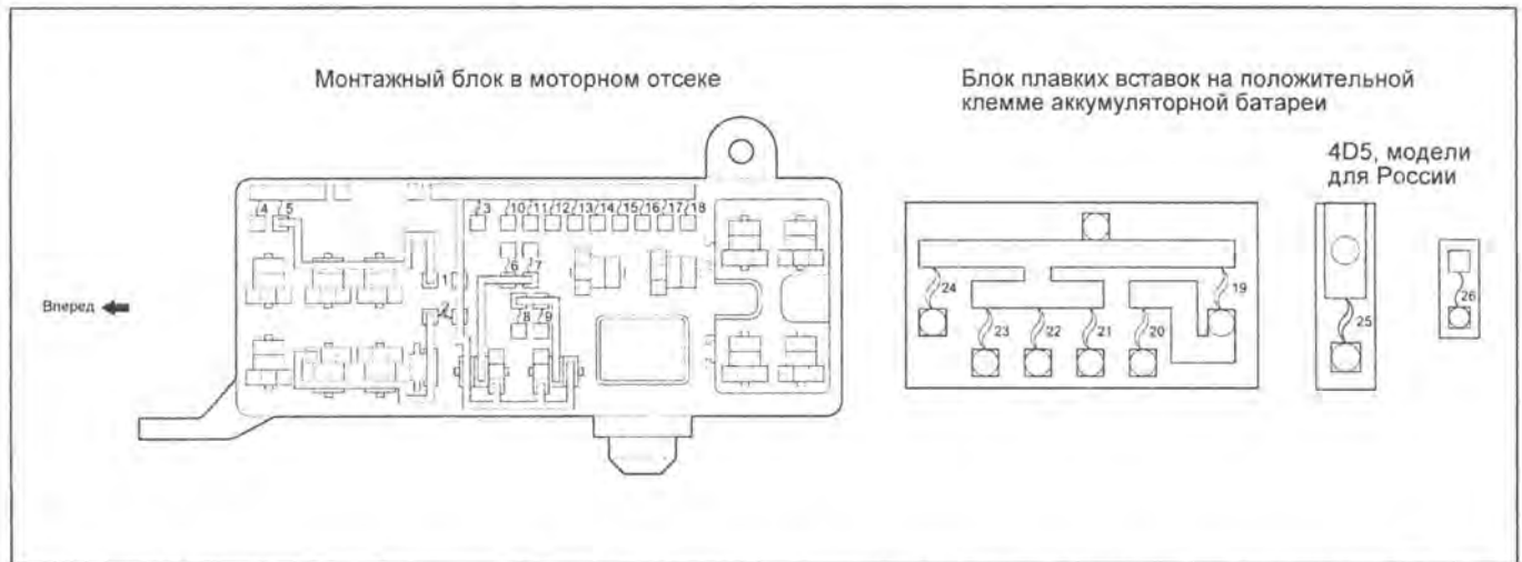
Монтажный блок в моторном отсеке и блок плавких вставок на положительной клемме аккумуляторной батареи (плавкие вставки и предохранители).
