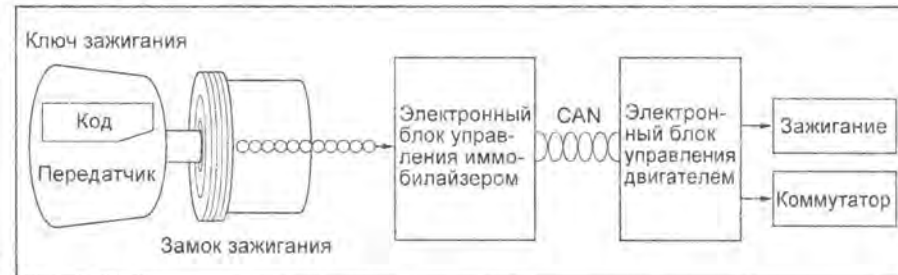
Схема структуры системы иммобилайзера.
