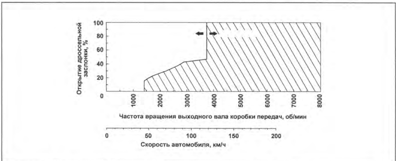
Диаграмма срабатывания муфты блокировки гидротрансформатора на 5-ой передаче (6B31).
