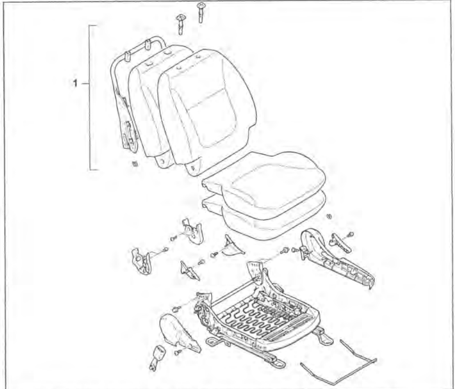
Снятие модуля боковой подушки безопасности. 1 - рама спинки переднего сиденья с интегрированным модулем боковой подушки безопасности.
