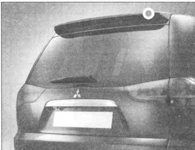
Спойлер задней двери (окрашен в цвет кузова): Белый (базовый) W32 ..... MZ330308 Коричневый C06 ..... MZ330717 Белый (перламутр) W54 ..... MZ330246 Серебристый A66 ..... MZ330247 Черный X08 ..... MZ330248 Серый A02 ..... MZ330250
