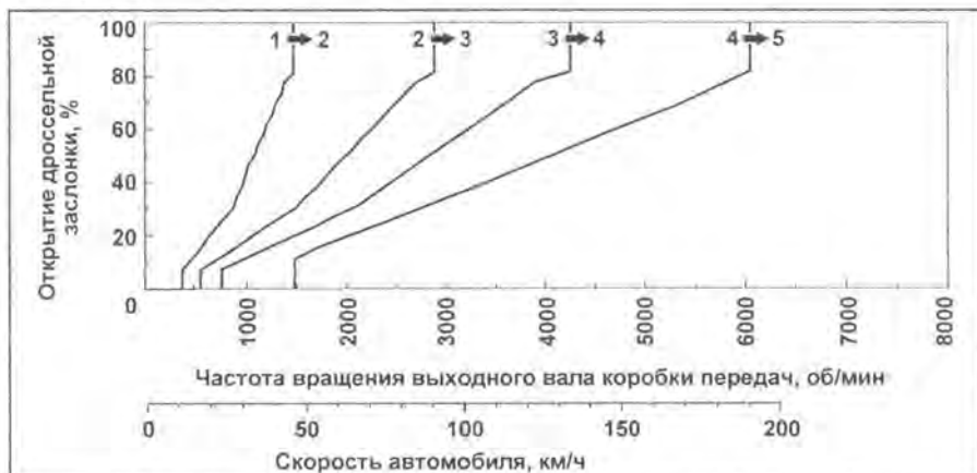
Диаграмма работы АКПП при переключении на повышающие передачи (6B31, 5AT).
