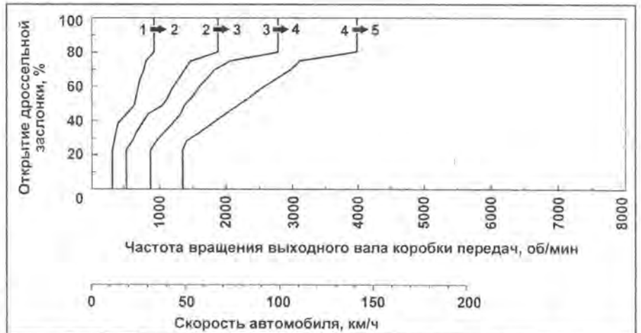
Диаграмма работы АКПП при переключении на повышающие передачи (4D56, 5AT, модели для России).
