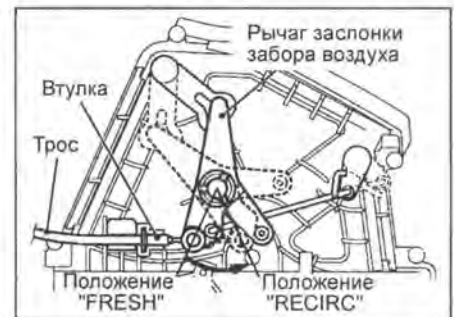
Снятие панели управления кондиционером и отопителем в сборе (кондиционер с ручным управлением). 1 - соединение троса привода заслонки забора воздуха, 2 - соединение троса привода заслонки смешивания потоков воздуха, 3 - соединение троса привода заслонки направления потока воздуха, 4 - центральная отделка панели приборов в сборе, 5 - рукоятка переключателя режима забора воздуха, 6 - центральная отделка панели приборов, 7 - панель управления кондиционером и отопителем.
