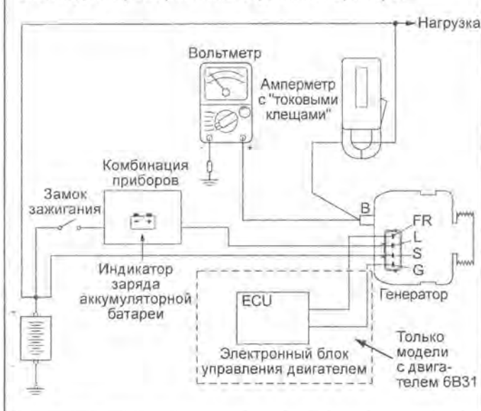
Схема для проверки тока отдачи генератора.
