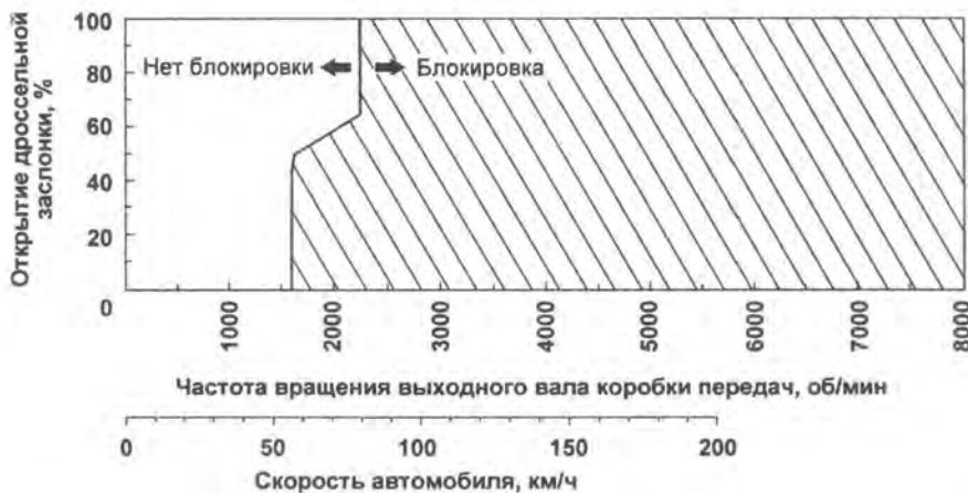
Диаграмма срабатывания муфты блокировки гидротрансформатора на 4-ой передаче (4D56, 5AT).
