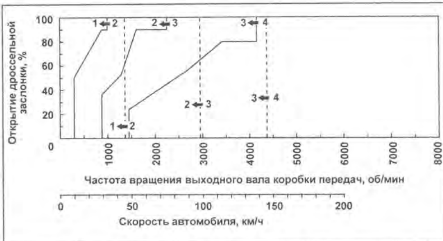
Диаграмма работы АКПП при переключении на понижающие передачи (4M41, 4AT).
