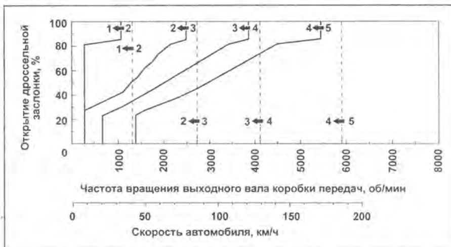
Диаграмма работы АКПП при переключении на понижающие передачи (6B31, 5AT).
