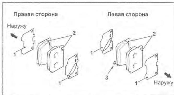
Комплекты тормозных колодок задних колёс. А - правая сторона, В - левая сторона, С - внешняя сторона, 1 - прокладки, 2 - тормозные колодки, 3 - индикатор износа.
