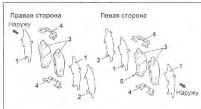
Комплекты тормозных колодок передних колес. А - правая сторона, В - левая сторона, С - внешняя сторона, 1, 2 - прокладки, 3 - тормозные колодки, 4 - фиксатор, 5 - индикатор износа.
