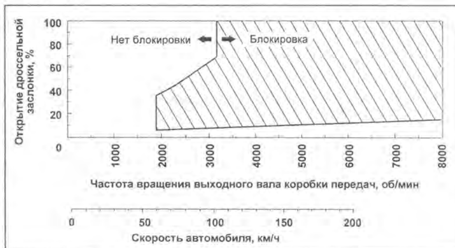
Диаграмма срабатывания муфты блокировки гидротрансформатора на 4-ой передаче (4D56, 4AT).
