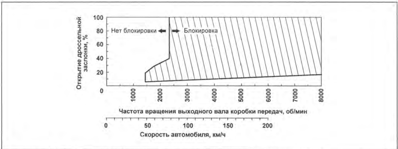
Диаграмма срабатывания муфты блокировки гидротрансформатора на 3-ой передаче (4M41).
