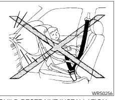
CHILD RESTRAINT INSTALLATION ON FRONT BENCH PASSENGER SEAT CENTER POSITION
