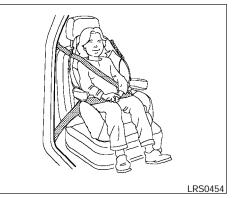
BOOSTER SEAT INSTALLATION ON RIGHT FRONT PASSENGER SEAT
