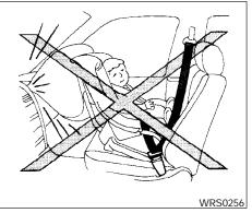
CHILD RESTRAINT INSTALLATION ON FRONT PASSENGER SEAT OUTBOARD POSITION
