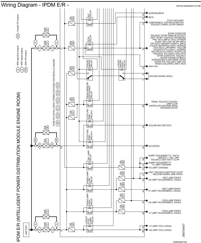
IPDM E/R (INTELLIGENT POWER DISTRIBUTION MODULE ENGINE ROOM)
