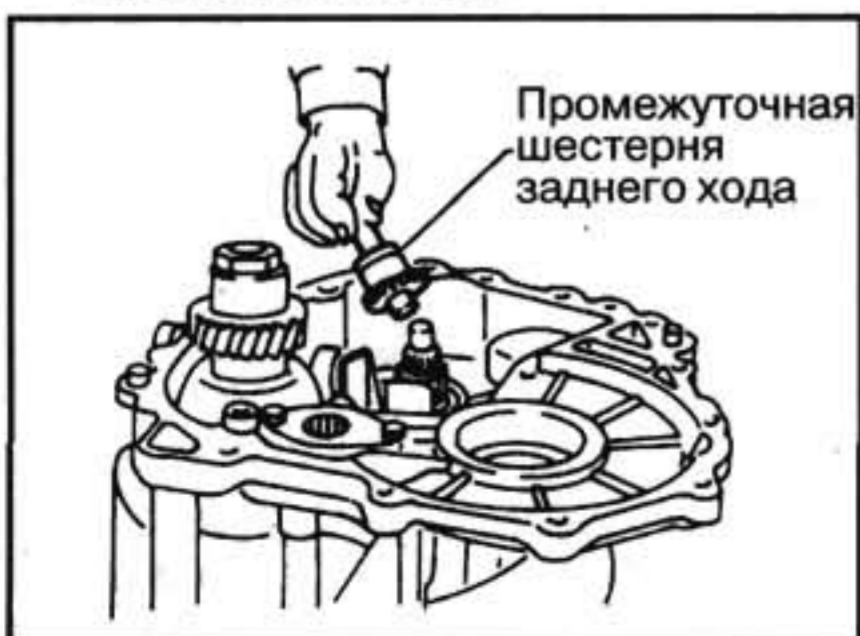
28. Снимите игольчатый подшипник. 29. Снимите промежуточную шестерню заднего хода и вал.
