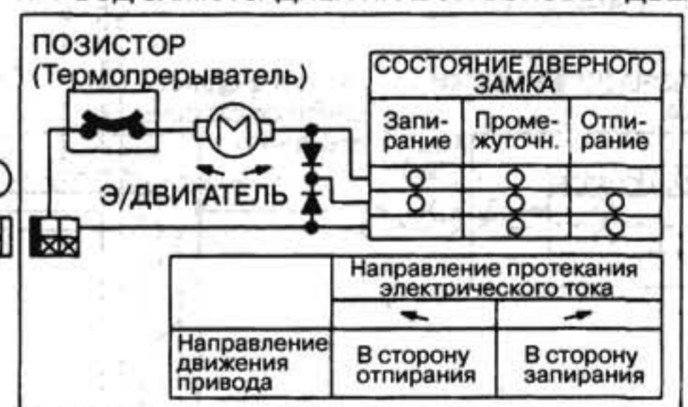
ПРИВОД ЗАМКА ЗАДНЕЙ ПРАВОЙ БОКОВОЙ ДВЕРИ
