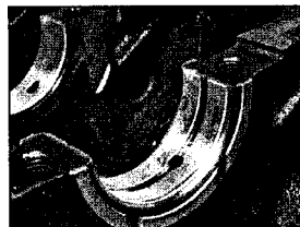
20.2А Вкладыш центрального коленчатого подшипника с упорными фланцами
