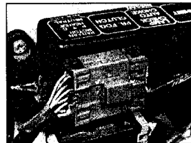
4.162Н...и большой разъемы на колпаке стойки передней подвески...
