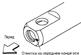
Рис. 1.24 Отметка, служащая для правильной установки оси коромысел (См. Раздел 17)
