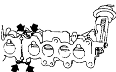
13.28 Болты регулировки разъемной поверхности всасывающего коллектора на двигателях CA16DE
