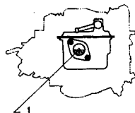
Рис. 3.9 Смотровое окошко и отметка уровня топлива поплавковой камеры карбюратора (См. Раздел 10) 1. Уровень топлива должен поддерживаться на уровне этой отметки
