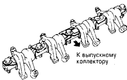
Рис. 1.25 Вырез на центральном креплении должен быть обращен к выпускному коллектору (См. Раздел 17)
