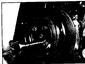
5.8 Снимите шкив водяного насоса
