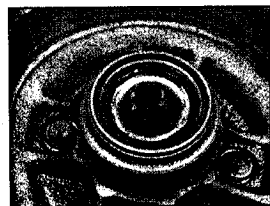
7.7 Внутренний сальник и подшипник ступицы
