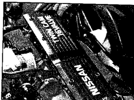
9.15Б ...и снимите крышки свечей
