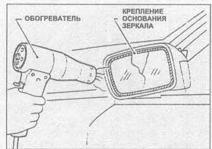
Рис. 11.18 Разогрейте основание стекла, чтобы снять стекло наружного зеркала (Глава 32)
