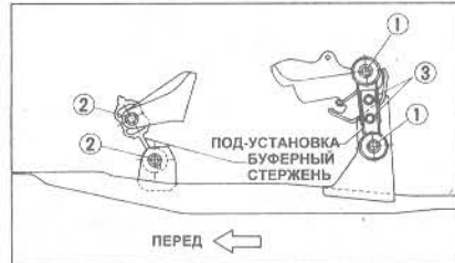
Рис. 1.21 Последовательность сжатия переднего и заднего крепления двигатель/трансмиссия (Глава 10)
