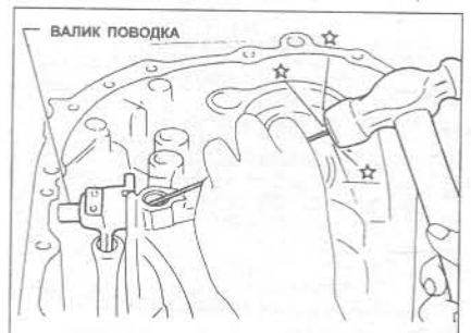
Рис. 6.28 Выбивание валика поводка (Глава 12)
