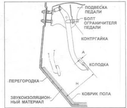
Рис. 5.3 Детали регулировки сцепления, у педали (Глава 2)
