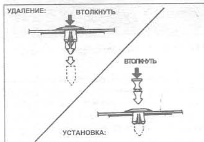
Рис. 11.5 Детали крепления переднего спойлера (Глава 11)
