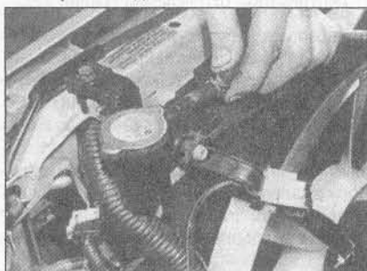
9.22 Ослабьте скобу и отсоедините шланг расширительного бачка от радиатора
