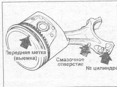
Рис. 1.34 Установка сборки поршень-шатун (Глава 18)
