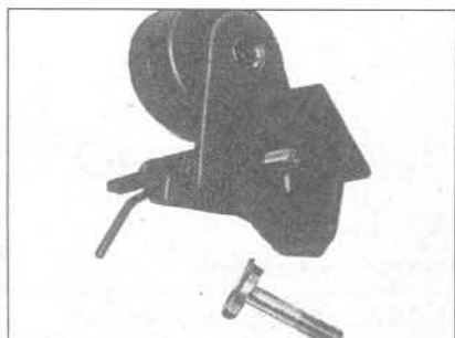
5.16 Механизм натяжения зубчатого ремня привода
