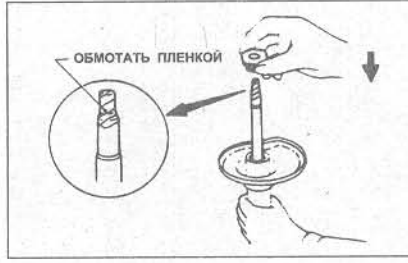
Рис. 10.25 Обмотайте липкой лентой верхний конец стержня поршня стойки и установите поджимную гайку набивного сальника (Глава 15)
