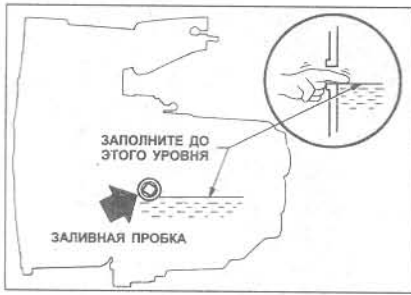
Рис. 6.1 Проверка уровня трансмиссионного масла - модели 1.6 литров (Глава 2)
