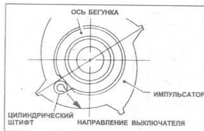
Рис. 4.8 Правильное расположение цилиндрического штифта в импульсаторе (Глава 4)
