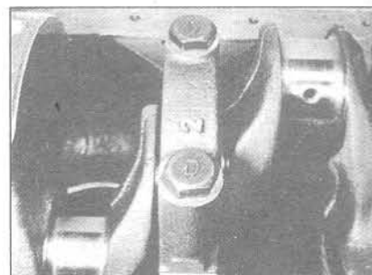
16.13 Крышки коренных подшипников идентифицированы номерами
