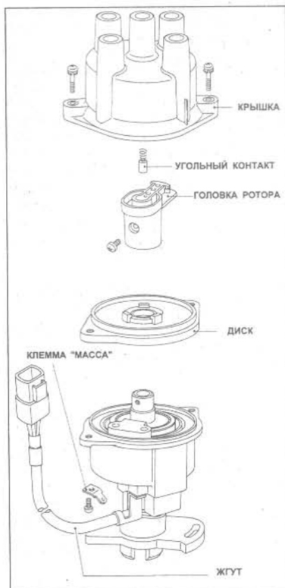
Рис. 4.15 Распределитель/датчик угла поворота коленвала Hitachi D4P83 (Глава 11)
