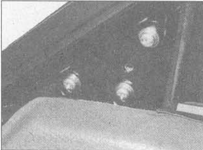
31.2 Крепежные винты наружного зеркала
