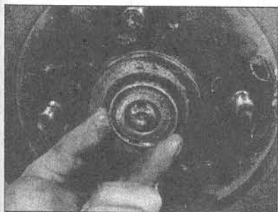
13.7 Снятие внутреннего кольца наружного подшипника задней ступицы
