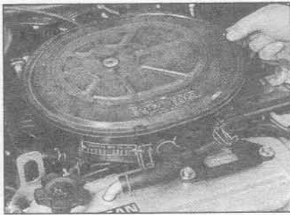
4.1B ... снимите крышку воздушного фильтра...
