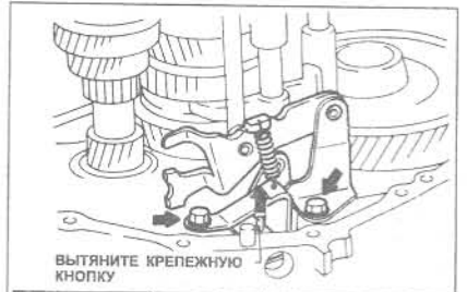
Рис. 6.21 Откручивание болта промежуточного вала заднего хода (отмечен стрелкой), пробки фиксаторов и болта выключателя положения (Глава 12)
