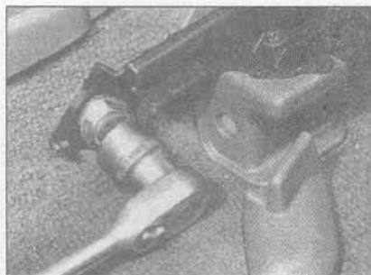
34.3В Обратите внимание, что стопорные болты салазок переднего сидения завинчены в центральный канал пола
