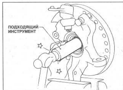
Рис. 10.5 Снятие ступицы с крепежного элемента (Глава 4)
