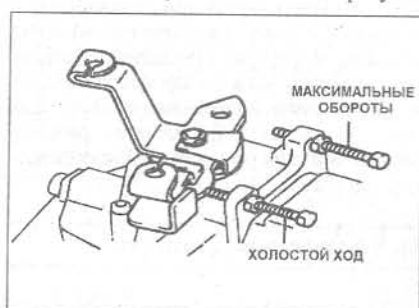
Рис.1.43 Регулировочные винты ТНВД (Глава 35)
