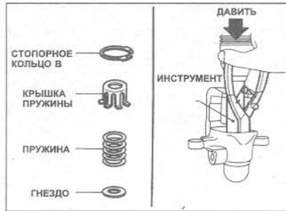
Рис. 9.27 Установка гнезда пружины, пружины и крышки пружины в корпус суппорта (Глава 25)
