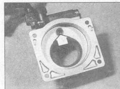
43.4 Не нарушайте провод измерителя воздушного потока
