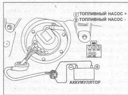
Рис. 3.43 Проверка электрического топливного насоса (Глава 34)
