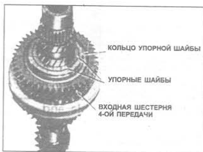
Рис. 6.35 Установка упорных шайб и кольца шестерни 40ой передачи (Глава 14)
