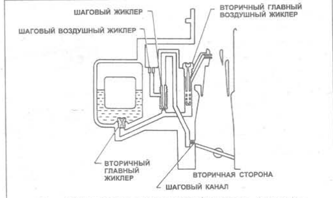
Рис. 3.11 Шаговая система карбюратора - типичная (Глава 16)
