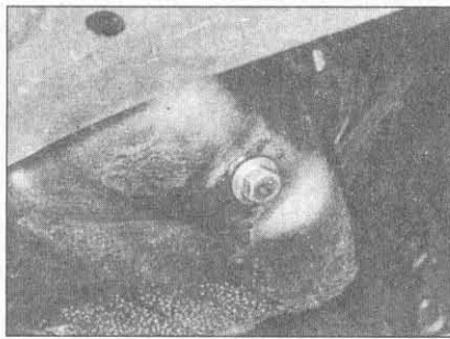
2.13 Сливная пробка моторного масла в поддоне
