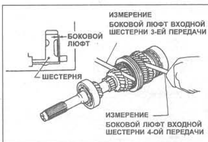
Рис. 6.30 Измерение бокового люфта - показаны шестерни 3-ей и 4-ой передач входного вала (Глава 12)
