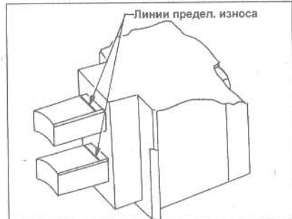
Рис. 12.2 Метки предельного износа щеток генератора (Глава 6)
