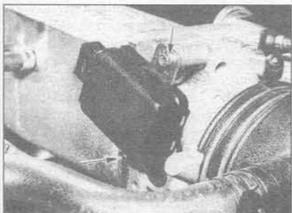
80.0 Монтажные болты выключателя дроссельной заслонки (отмечены стрелками)
