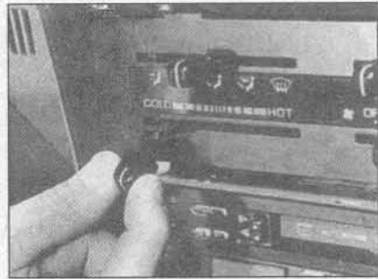
39.5 Снятие рычага управления отопительным прибором
