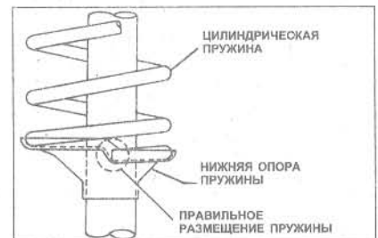
Рис. 10.28 Правильное положение цилиндрической пружины задней подвески (Глава 15)
