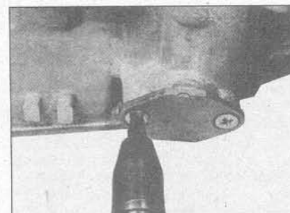
8.12 Снятие винтов сборки плунжера фиксатора заднего хода
