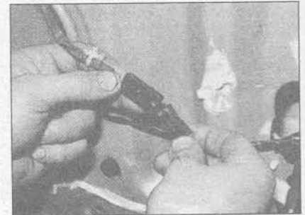
28.14A Отсоединение электропроводки двигателя, окна с сервоприводом стекла
