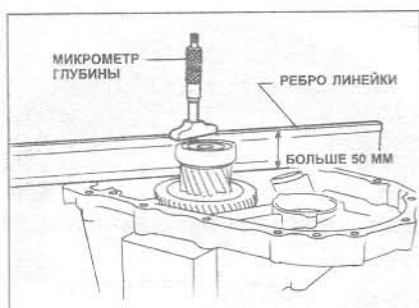
Рис. 6.42 Предварительный натяг подшипника выходного вала - размер 'А' (Глава 15)
