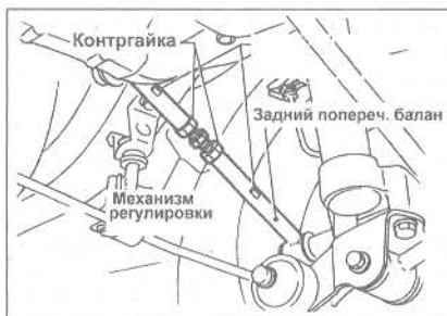
Рис.10.40 Компоненты регулировки схождения задних колес (Глава 36)
