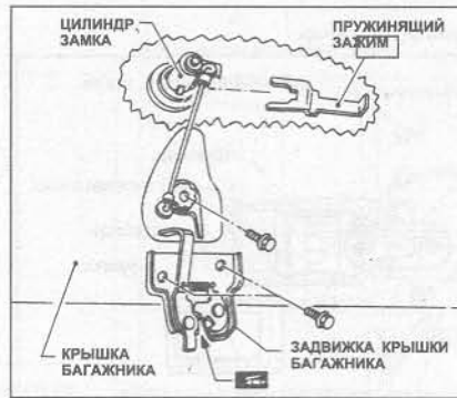
Рис. 11.14 Задвижки крышки багажника и цилиндр замка - Седан (Главы 22 и 23)
