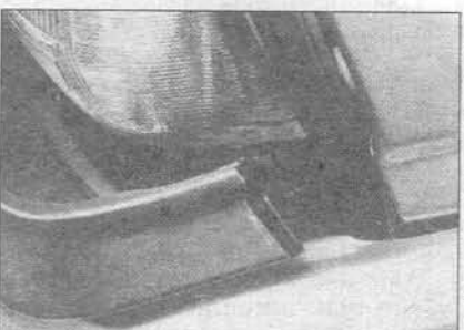
10.7В ... и снимите концы панели из уплотнений крыла (только на более поздних моделях)
