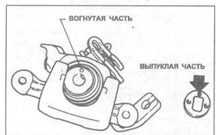
Рис. 9.25 Правильное совмещение стопорной пластины с корпусом суппорта (Глава 25)
