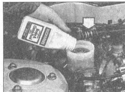
2.2 Дозаправка главного цилиндра позднего типа - заметьте расположение контрольного клапана вакуумного усилителя (отмечен стрелкой)
