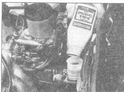
2.1 Используйте только жидкость указанного типа при дозаправка главного цилиндра сцепления
