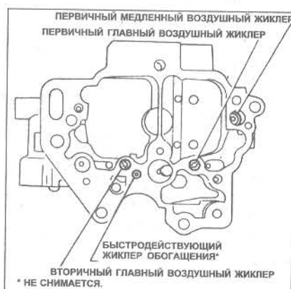
Рис. 3.34 Расположение жиклеров (камера заслонки) - модели 2.0 литра (Глава 21)
