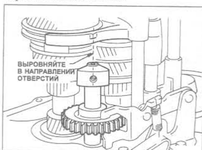
Рис. 6.40 Правильное выравнивание промежуточного вала заднего хода (Глава 14)
