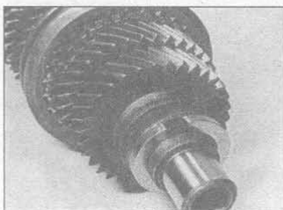
10.24 С-кольца выходного вала могут иметь различную толщину
