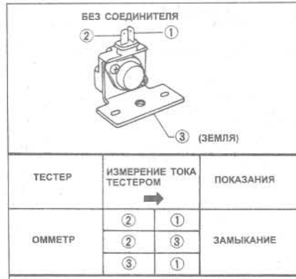
Рис. 4.18 Прозвонка транзистора мощности (Глава 14)
