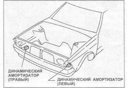
Рис. 1.24 Расположение динамических амортизаторов - автоматическая трансмиссия (Глава 10)
