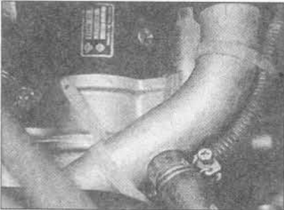
8.2С Соединение возвратного шланга отопителя с возвратной трубой охлаждения
