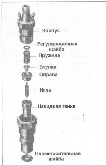
Рис.1.44 Детали топливной форсунки (Глава 37)
