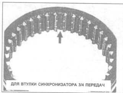
Рис. 6.34 Расположение вставки пружины на втулке синхронизатора 3/4 передач (Глава 14)
