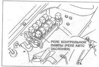
Рис. 3.27 Расположение реле контрольной лампы/авто заслонки (Глава 17)
