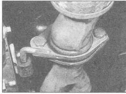
24.2В Фланцевое соединение и крепеж распределительной трубы к промежуточной части
