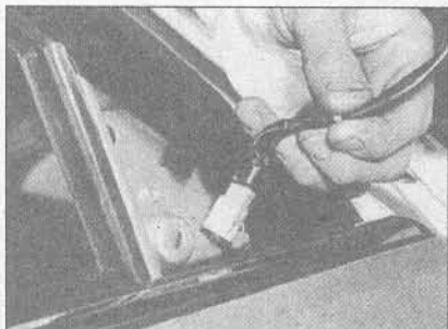
31.7А Вытащите электрический провод из двери
