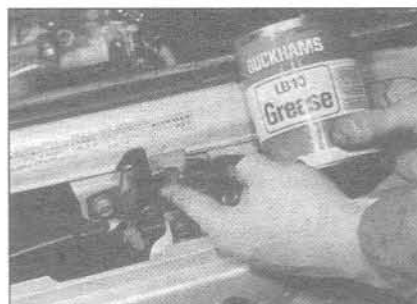
4.2 Смажьте механизм выпуска капота и дверные замки
