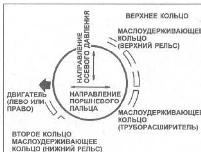
Рис. 1.18 Расположение зазоров разрезов поршневых колец (Глава 9)
