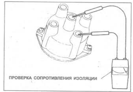
Рис. 4.4 Проверка изоляции крышки прерывателя-распределителя (Глава 4)
