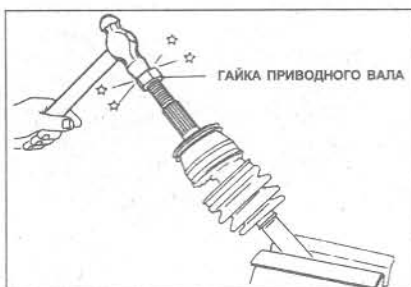
Рис. 8.6 Установка внешнего ШРУСа на приводной вал (Глава 4)
