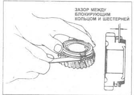
Рис. 6.13 Проверка износа блокирующего кольца (Глава 9)
