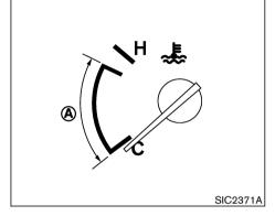
ENGINE COOLANT TEMPERATURE GAUGE
