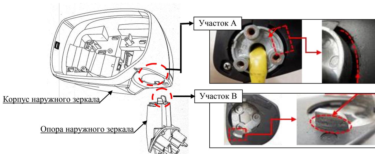
Наружное зеркало, предназначенное для устранения проблемы, имеет немного больший зазор между Участком А корпуса наружного зеркала и Участком В опоры наружного зеркала.
