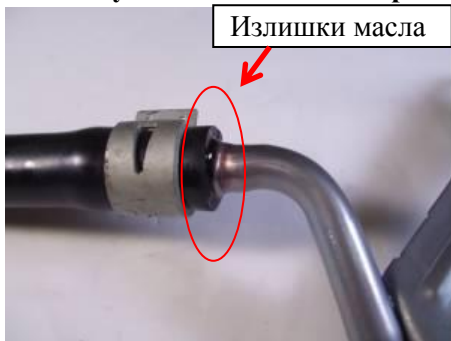
Фото 3. Пример излишков масла в результате утечки ATF из соединения после запуска двигателя
