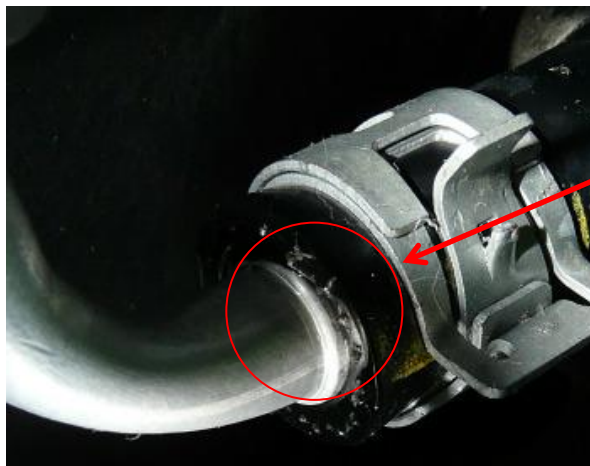
Фото 2. Место соединения, протертое тканью, находящееся в сухом состоянии
