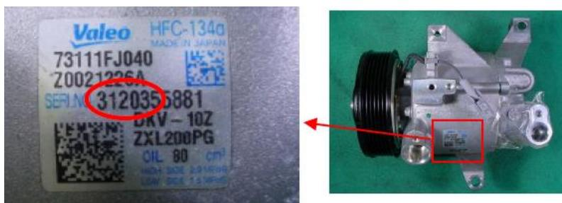
Для проверки используется поле “SERI No.” (Серийный номер). Например, данный серийный номер означает 3 декабря 2013 г.”
