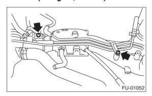
4) Install the fuel injector pipe LH.
