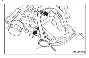
18) Remove baffle plate.
