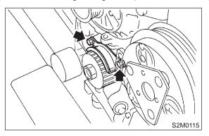
17) Remove crankshaft sprocket.
