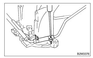
27) Remove fuel injector pipe.
