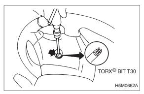
4) Using TORX<sup>®</sup> BIT T30, remove two TORX<sup>®</sup> bolts.
