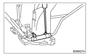
28) Remove fuel injector pipe.
