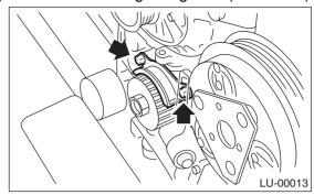
13) Remove the crank sprocket.
