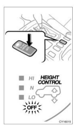
(d) Turning off the rear height control air suspension
