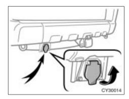
TOWING CONNECTOR FOR TRAILER LIGHTS
