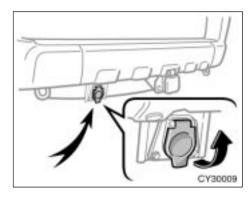
TOWING CONNECTOR FOR TRAILER LIGHTS
