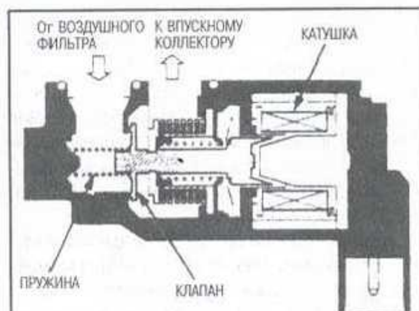
Рис. 21 Вид клапана IAC в разрезе. Для поддержания частоты оборотов холостого хода постоянной, клапан регулирует расход воздуха, подаваемого в обход дроссельной заслонки во впускной коллектор
