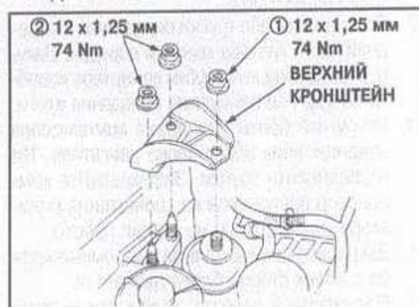
Рис. 1 Порядок затяжки гаек верхнего кронштейна - модели CR-V
