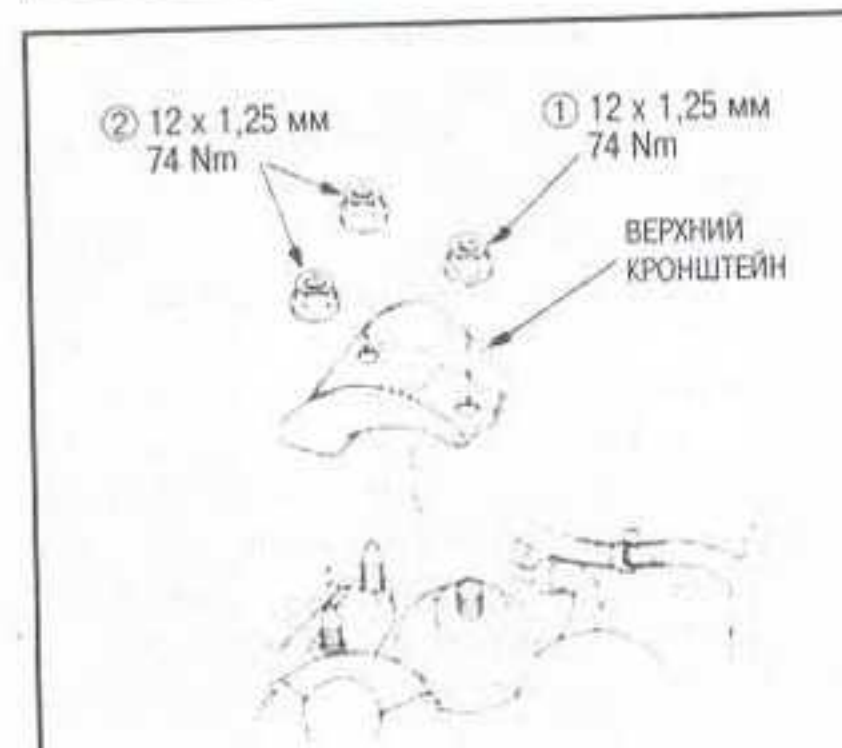
Рис. 5 Порядок затяжки верхнего кронштейна - модели CR-V
