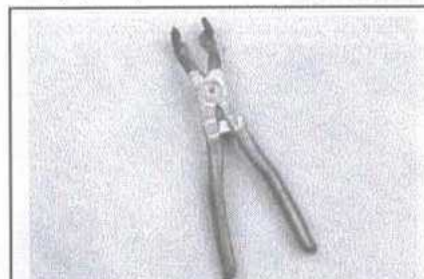
Рис. 5 Ручки на этих кусачках имеют изоляцию для защиты от поражения электрическим током. Они также сохраняют целостность проводов
