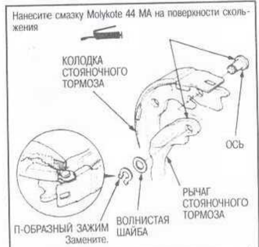
Рис. 88 Рычаг крепится к тормозной колодке при помощи оси и П-образного зажима
