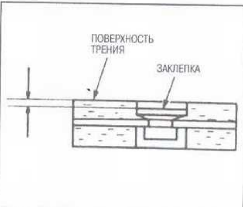
Рис. 45 Диск сцепления также подлежит замене, если расстояние между поверхностью фрикционного материала и заклепкой составляет 0,2 мм или менее
