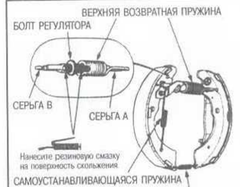
Рис. 61 Нанесите подходящую смазку для резины на ось и резьбовой участок болта регулятора – показана модель CR-V
