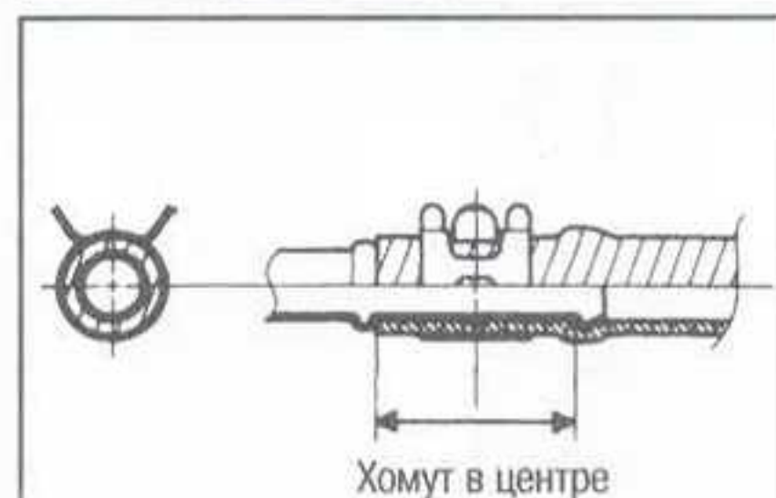
Рис. 2 Хомут с механической затяжкой следует устанавливать по центру штуцера и затягивать с требуемым усилием. Не перетягивайте
