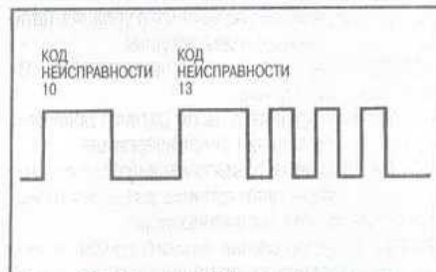
Рис. 42 Модуль ECM может хранить в памяти многочисленные коды неисправностей. Они могут оказаться полезными для диагностики
