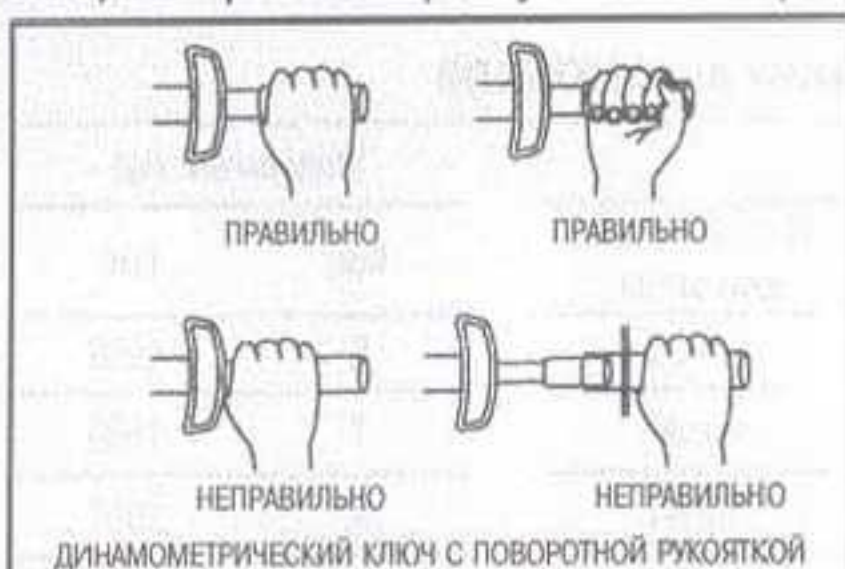
Рис. 29 Динамометрические ключи с поворотной головкой следует держать и использовать надлежащим образом во избежание неточных показаний
