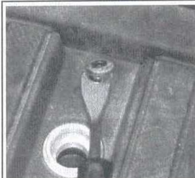
Рис. 11 При снятии уплотняющих втулок с клапанной крышки очень удобно пользоваться съемником для декоративных панелей
