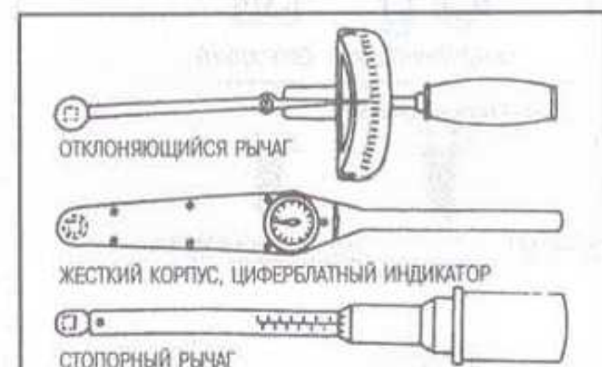
Рис. 24 В магазинах автозапчастей обычно предлагаются динамометрические ключи различных типов
