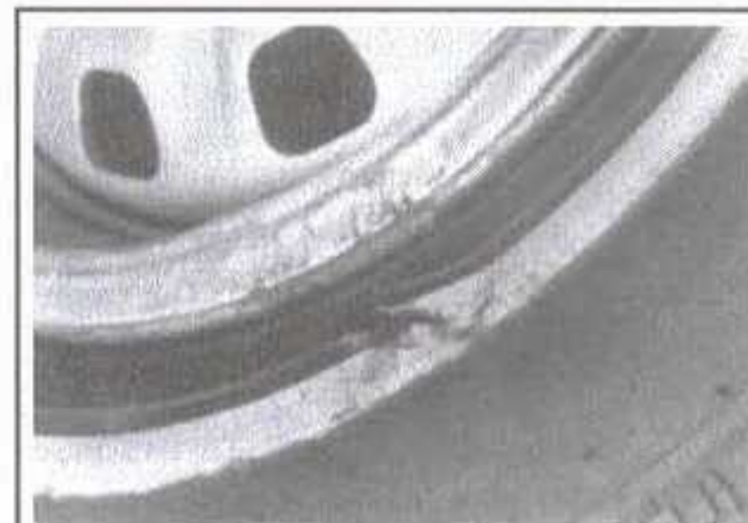
Рис. 140 Шины с глубокими порезами или порезами со вспучиванием следует немедленно заменять
