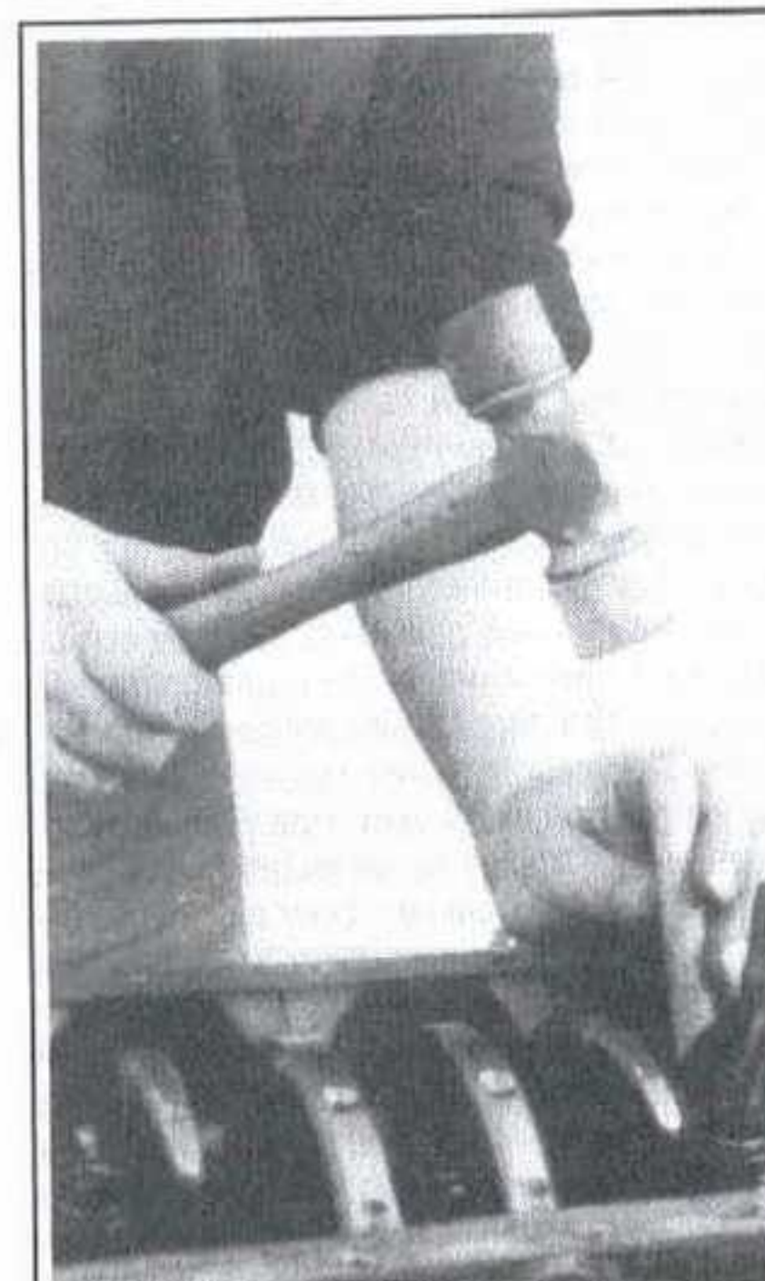
Рис. 148 Осторожно выбейте поршень из цилиндра при помощи деревянного штифта
