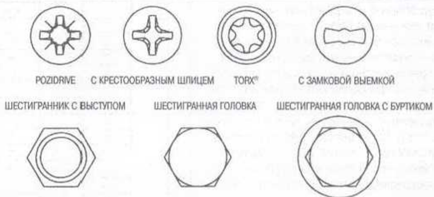
Рис. 20 Вот несколько примеров наиболее распространенных поверхностей винтов/болтов, передающих крутящий момент
