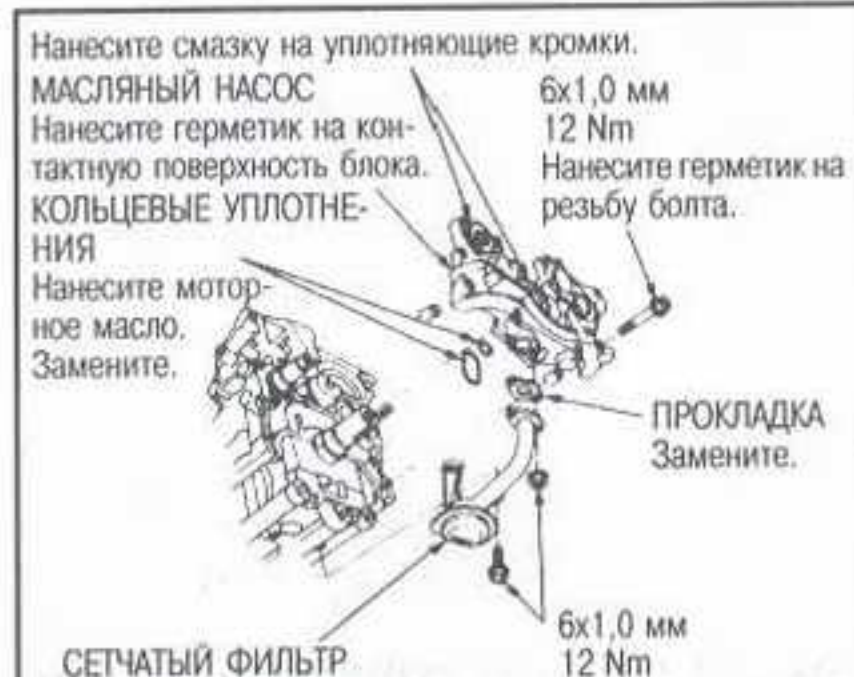
Рис. 51 Масляный насос и сетчатый фильтр - 4-цилиндровые двигатели моделей Odyssey
