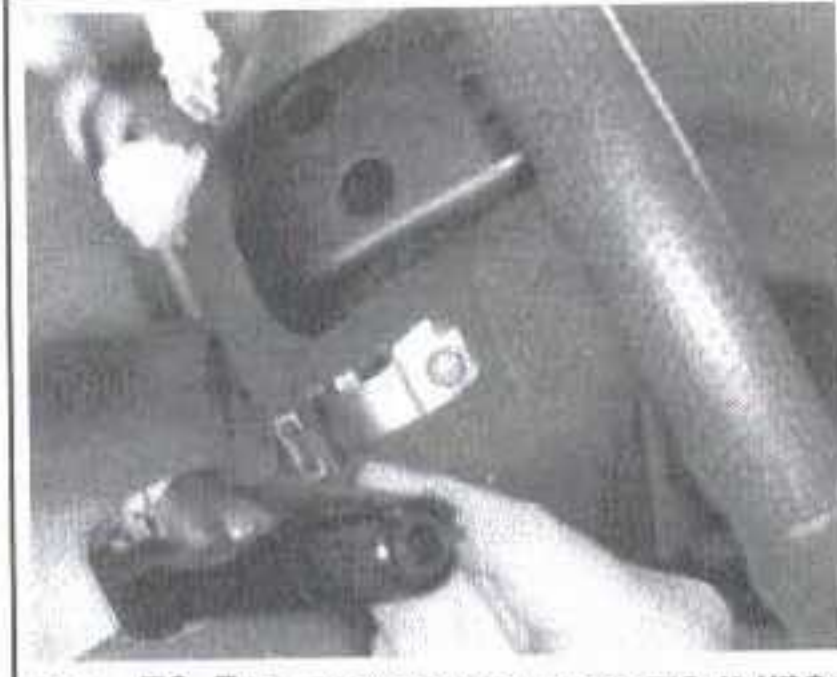
Рис. 70 Для получения доступа к крепежным винтам надувной подушки снимите боковые панели — показана модель CR-V
