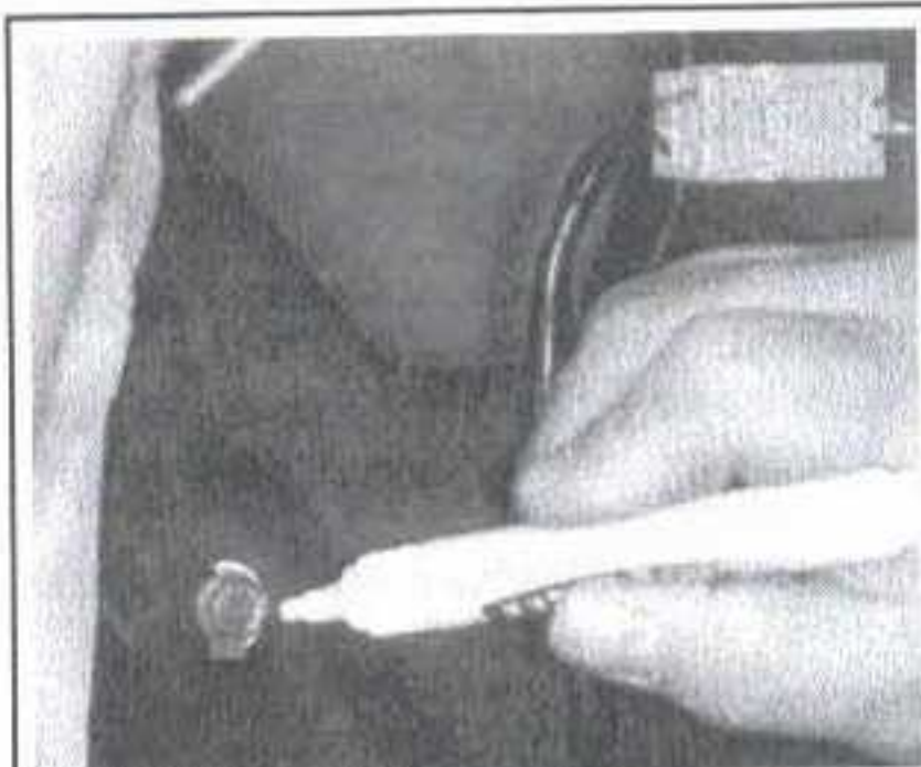
Рис. 46 Всегда наносите метки на крепежные детали, которые устанавливаются через прорези. Этот болт применяется для регулировки положения окна
