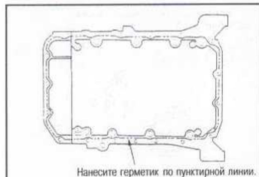
Рис. 47 Нанесите герметик на резьбу отверстий под болты и блок двигателя на участке, указанном пунктирной линией - модели V6
