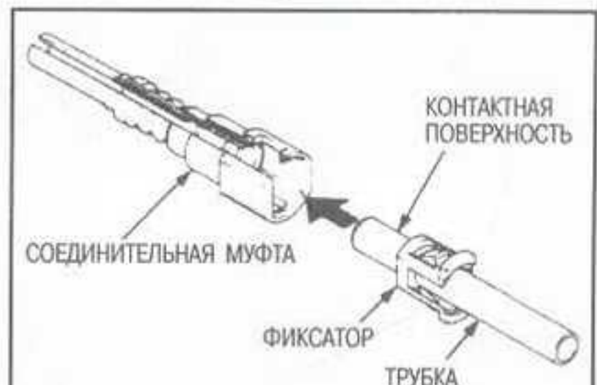
Рис. 11 После отсоединения проверьте соединительную муфту топливопровода и замените фиксатор. Нанесите на контактную поверхность трубки тонкий слой свежего моторного масла
