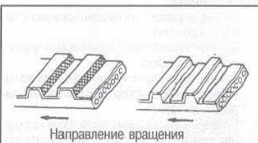
Рис. 77 Износ зубьев из-за чрезмерного натяжения ремня, неправильного вращения распределительного вала или распределителя или попадания жидкости
