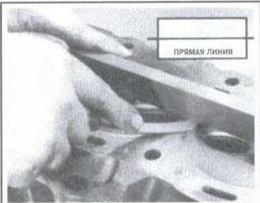
Рис. 144 Проверьте головку на коробление по центру поверхности под прокладку при помощи мерной линейки и набора щупов
