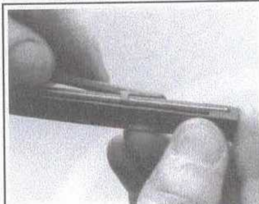
Рис. 131 Для снятия и установки сменной щетки фирмы Lexor® сдвиньте старую вставку и наденьте новую
