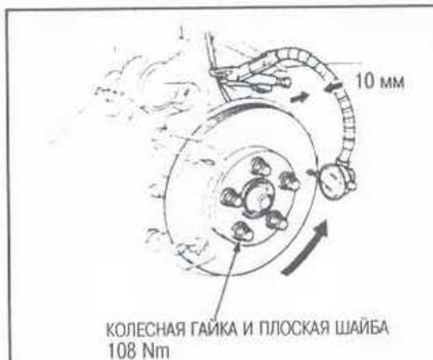
Рис. 49 Измеряйте биение тормозного диска индикатором
