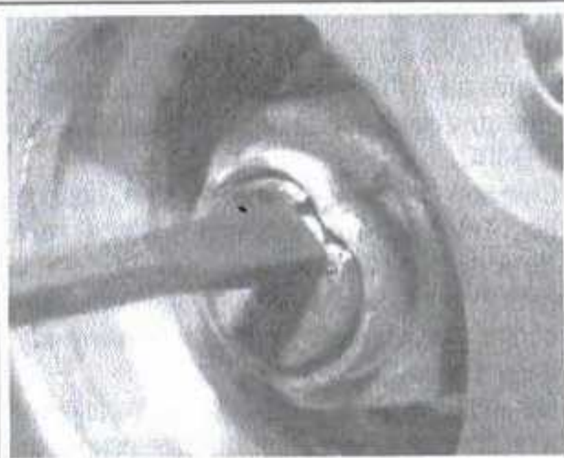
Рис. 31 Перед откручиванием гайки, выбейте фиксирующую лапку из канавки на оси
