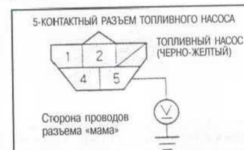
Рис. 25 На моделях Odyssey V6 электропитание на топливный насос подается от главного реле системы PGM-FI на контакт № 5
