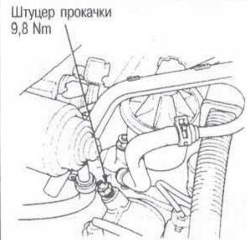
Рис. 28 Штуцер прокачки системы охлаждения расположен возле корпуса термостата на моделях Odyssey с 4-цилиндровыми двигателями
