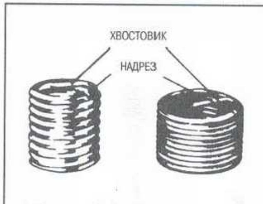
Рис. 124 Стандартная ремонтная резьбовая вставка (слева) и резьбовая вставка под свечу зажигания
