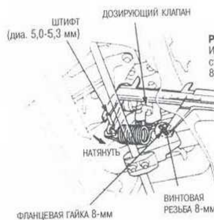
Рис. 11 Использование штангенциркуля с нониусом для измерения расстояния от вставленного штифта до винтовой резьбы 8-мм
