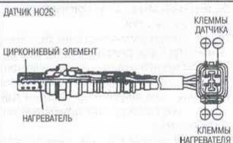
Рис. 15 У подогреваемого датчика кислорода имеется две цепи: цепь датчика, которая измеряет концентрацию кислорода в выхлопных газах, и цепь подогревателя, используемая для стабилизации датчика
