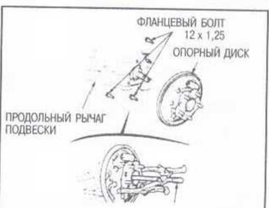
Рис. 66 На моделях 4WD после снятия тормозной гидравлической линии и фланцевых болтов снимите ступицу со шлицевой полуоси при помощи съемника с двумя захватами
