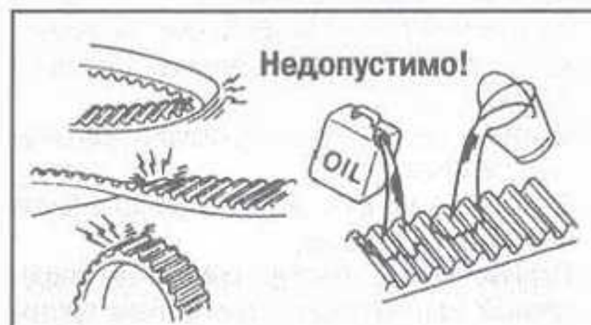
Рис. 72 Не сгибайте и не перекручивайте ремень привода ГРМ и не допускайте попадания на него растворителей, антифриза, бензина, кислоты или масла
