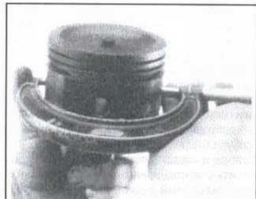
Рис. 150 Измерьте микрометром наружный диаметр поршня перпендикулярно поршневому пальцу
