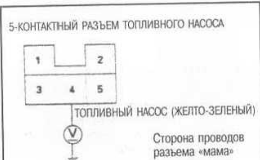
Рис. 22 На моделях CR-V электропитание на топливный насос подается от главного реле системы PGM-FI на контакт № 4
