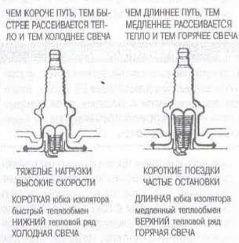
Рис. 86 Тепловой ряд свечей зажигания
