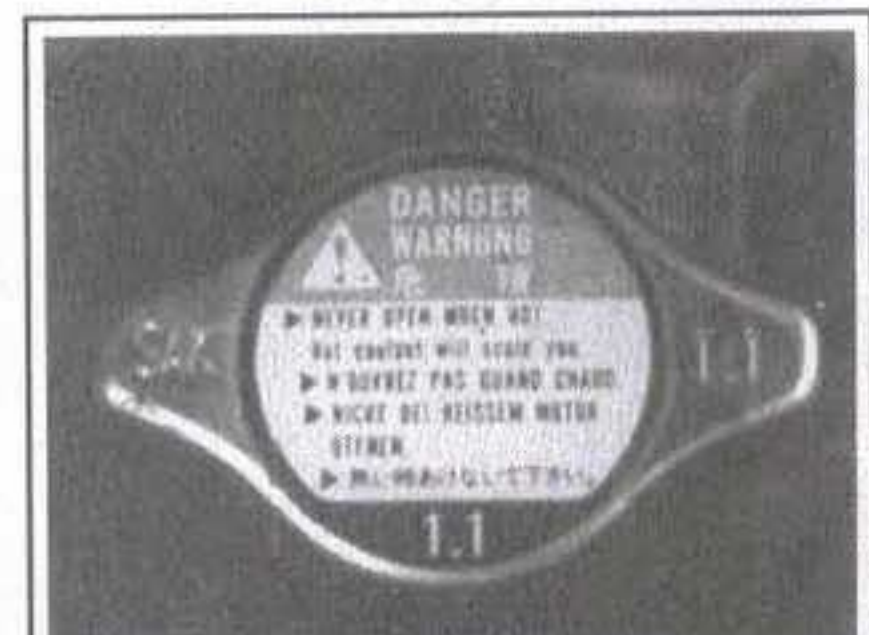
Рис. 171 Число «1.1» на крышке радиатора указывает на номинальное давление срабатывания крышки радиатора, измеренное в атмосферах. Эта крышка выдерживает 1,1 атмосферного давления
