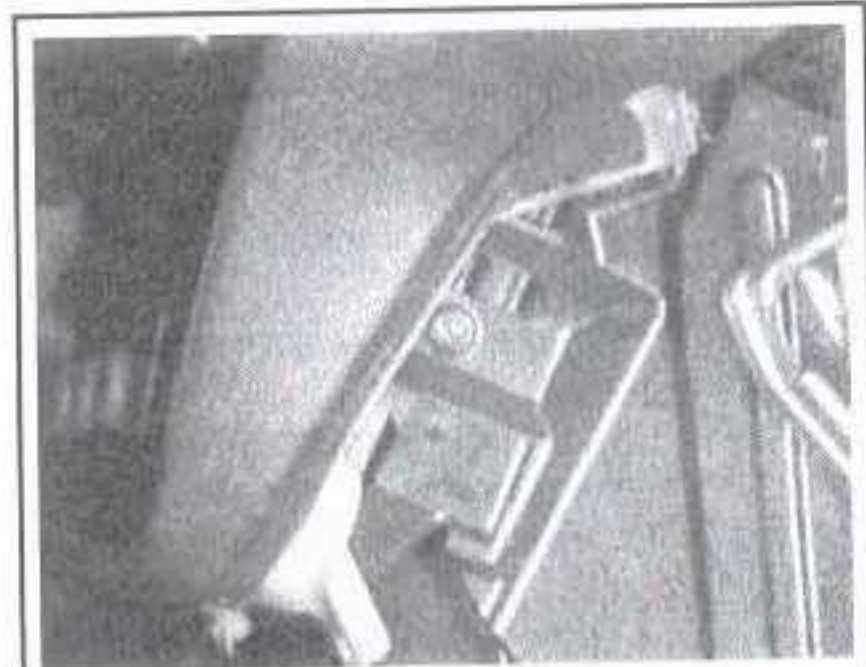
Рис. 32 Сдвинув нижнюю крышку в сторону, снимите крепежные детали с левой и правой сторон...
