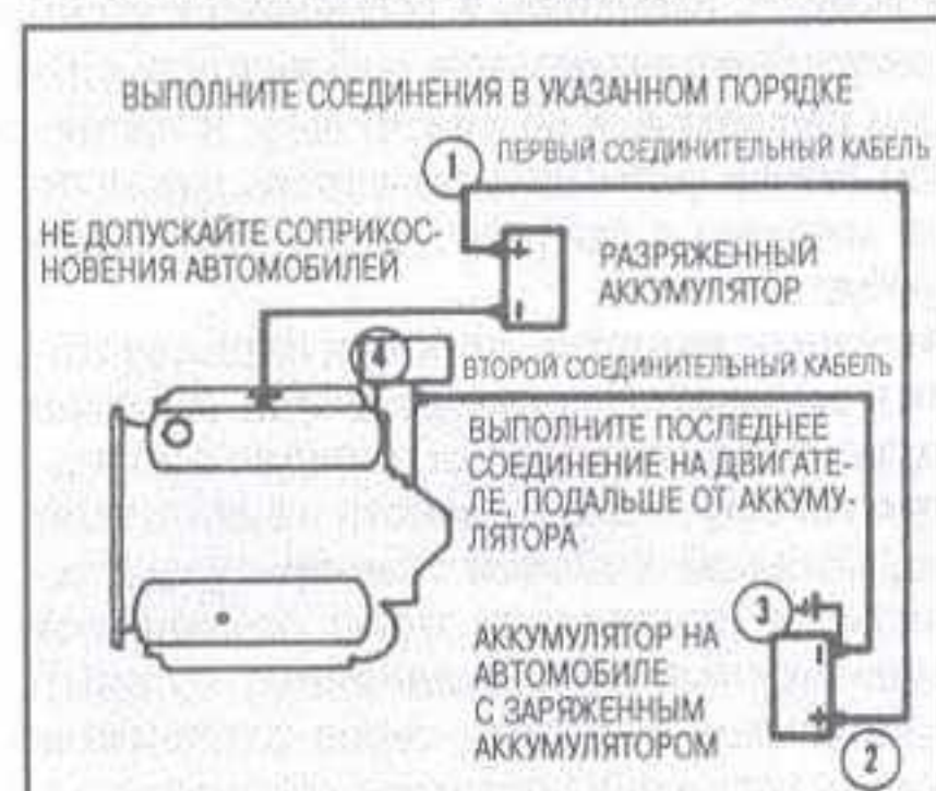
Рис. 191 Подсоедините соединительные кабели к аккумуляторам и двигателю в указанном порядке
