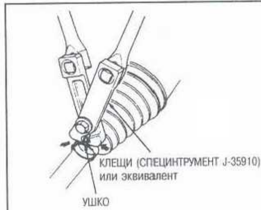
Рис. 38 Хомут чехла с проушинами подтягивают, сжимая основание ушка при помощи клещей
