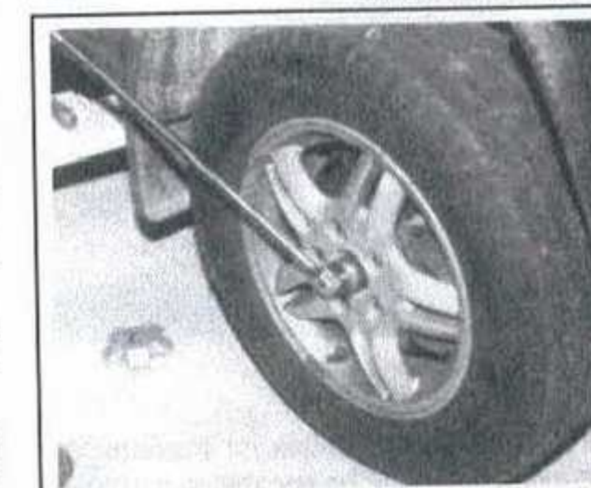
Рис. 12 Отогнув стопорный язычок гайки оси, ослабьте гайку при помощи 1/2-дюймового прутка и 32-мм головки
