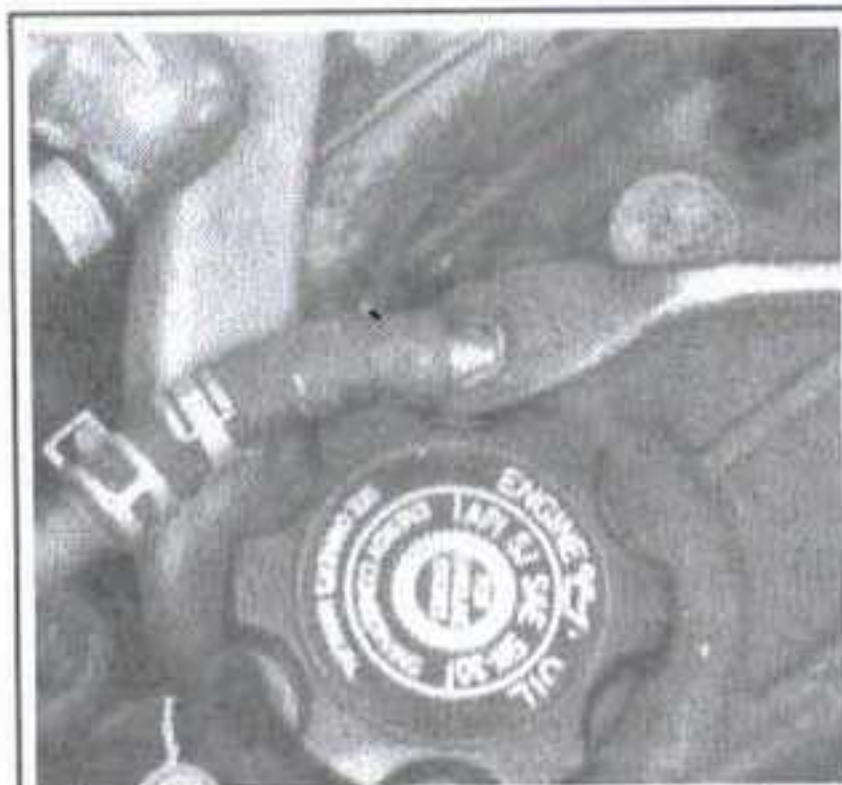
Рис. 13 Сожмите хомут для ослабления натяжения и оттяните его назад, затем осторожно стяните шланг сапуна со штуцера
