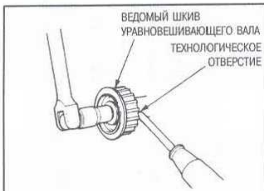
Рис. 49 При откручивании крепежного болта шкива зафиксируйте уравнивающий вал, вставив инструмент в технологическое отверстие
