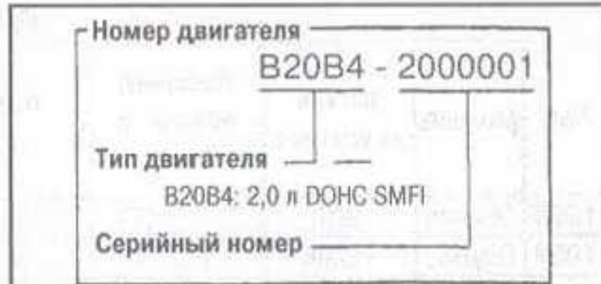
Рис. 37 Разбивка номера двигателя для моделей CR-V 1997г
