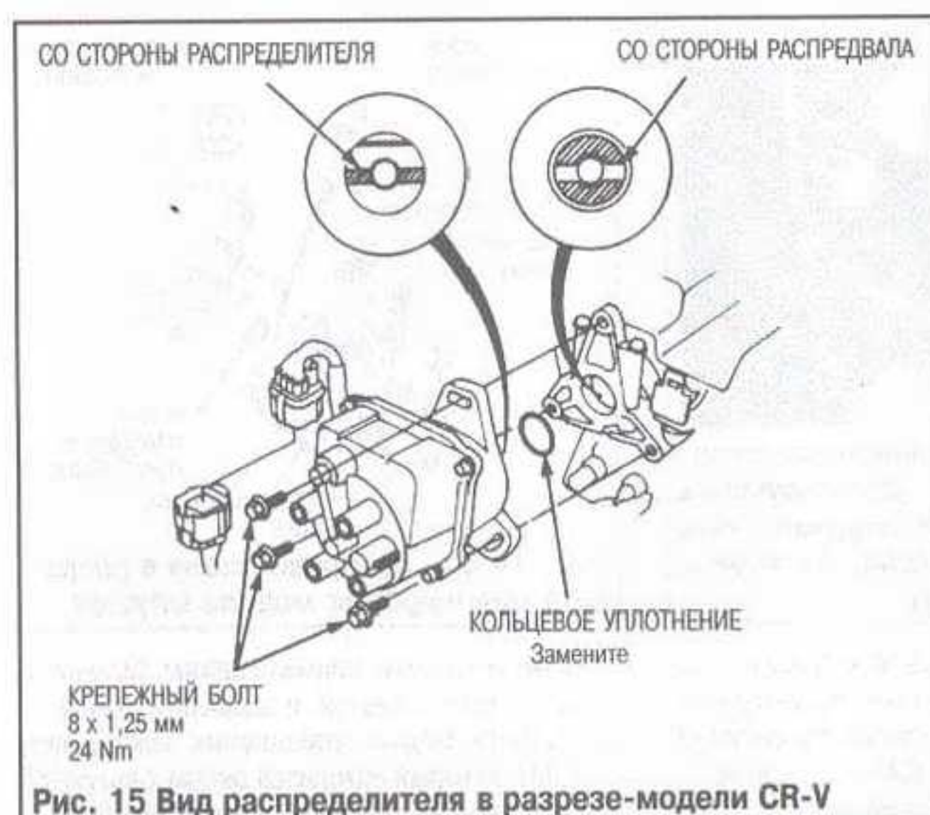
Рис. 16 Шпоночная канавка распределителя смещена и может устанавливаться только в одном направлении
