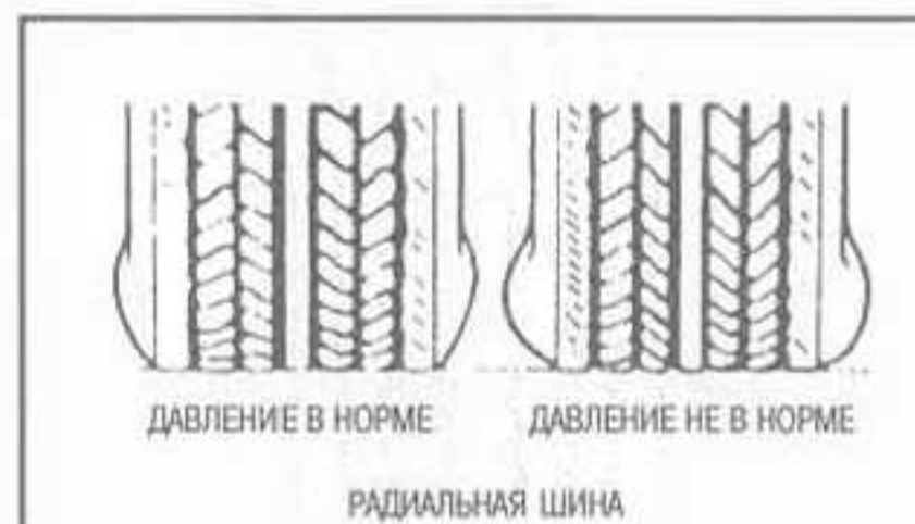
Рис. 142 У радиальных шин имеется характерное вздутие на боковинах; не пытайтесь измерить давление по внешнему виду шины. Воспользуйтесь качественным манометром.
