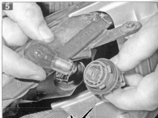
5 Toyota Auris, Toyota Corolla Verso Нажав на лампу, поворачиваем ее до упора против часовой стрелки и вынимаем из патрона. Устанавливаем новую лампу указателя поворота в обратной последовательности
