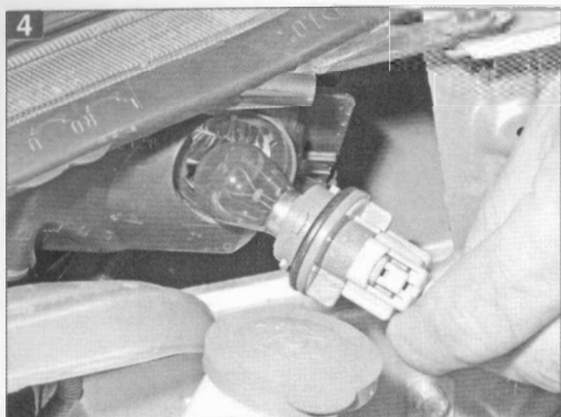
4 Toyota Auris, Toyota Corolla Verso Чтобы демонтировать лампу указателя поворота, необходимо повернуть патрон лампы против часовой стрелки и вынуть его из корпуса блок-фары
