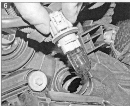
6 Toyota Corolla Патрон лампы габаритного света поворачиваем против часовой стрелки и аккуратно вынимаем из корпуса блок-фары. Затем вынимаем лампу из патрона, не прилагая большого усилия
