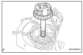
(d) Install the rear planetary gear assembly.
