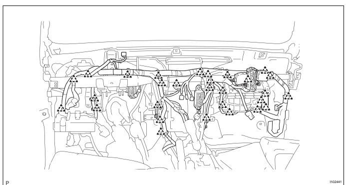
(d) Remove the 5 bolts and the 2 nuts.
