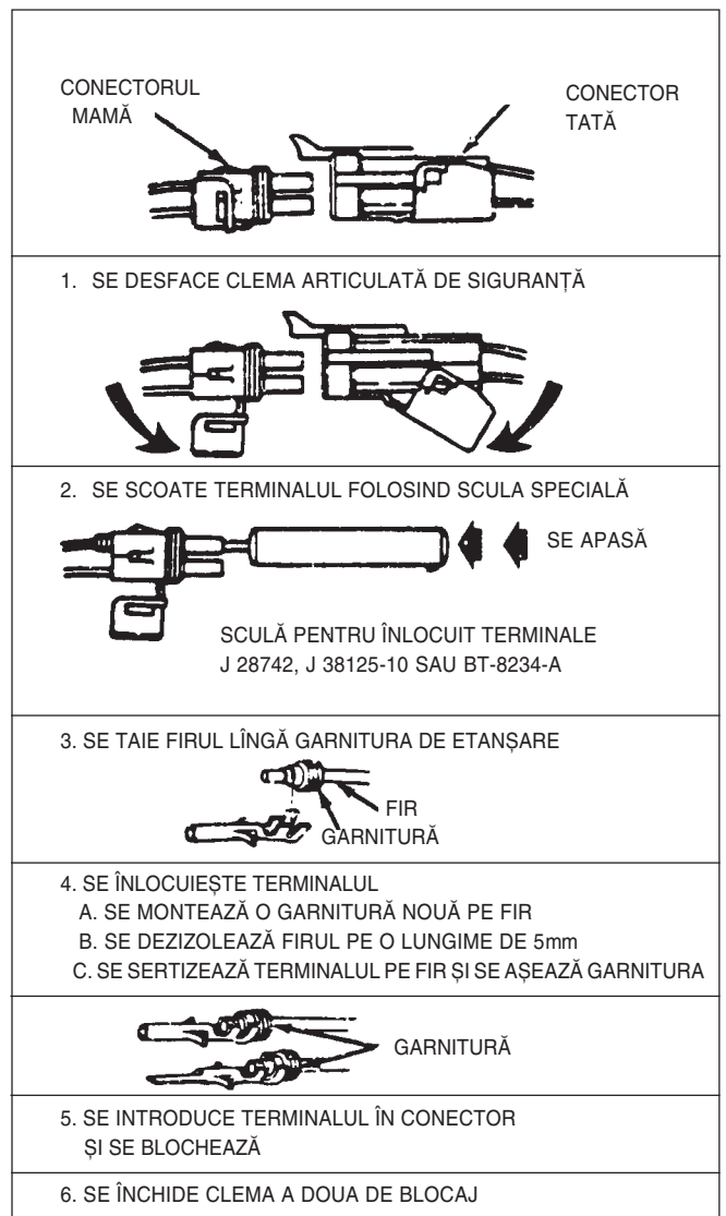
Fig. 2 Repararea unui conector „etanș”
