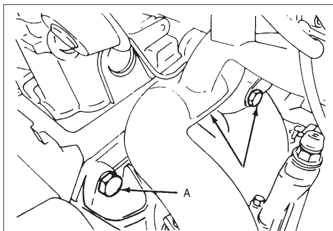
A. TREI ȘURUBURI DE PRINDERE A CUTIEI DE MOTOR
