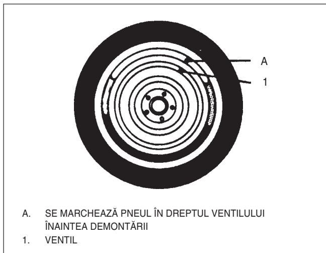
Fig. 7 Montarea împerecheată a jenții și pneului
