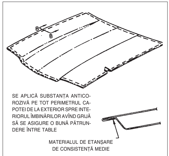
Fig. 22 Etanșarea tablelor capotei
