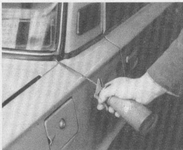
Bild 3-18 Konservierung des Bereiches unter dem Gummiprofil der Heckscheibe mittels Spritzölkanne und Elaskon K 60 ML
