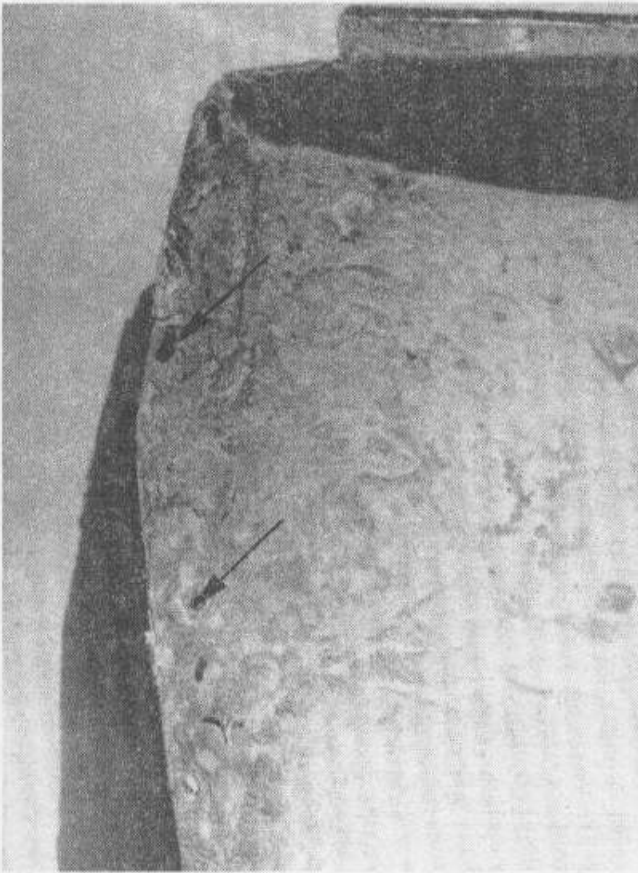
Bild 4-9 Typische Korrosion am hinteren Radkasten des Wartburg 353 W Limousine; Befestigungsflansch stark korrodiert
