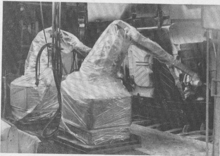
Bild 1-39 Auftragen von Unterbo- denschutz auf den Boden der Trabant-Karosserie mittels frei programmier- barer Roboter
