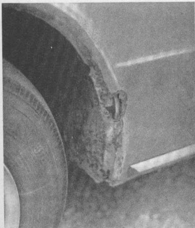
Bild 1-4 Typische Korrosionserscheinung am Radausschnitt eines Lada
