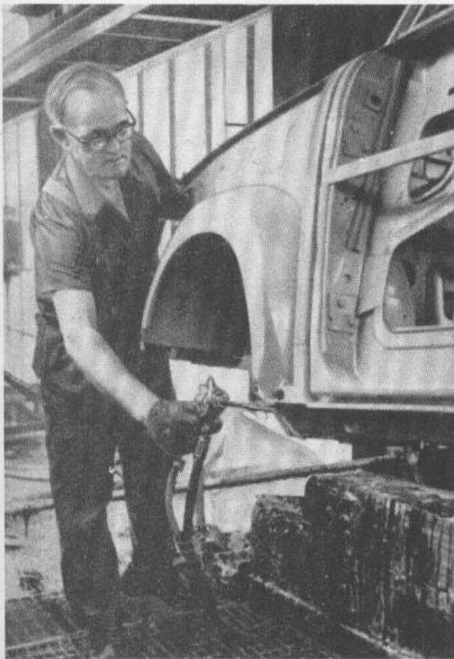
Bild 1-40 Hohlraumbeschichtung der Längsträger des Trabant
