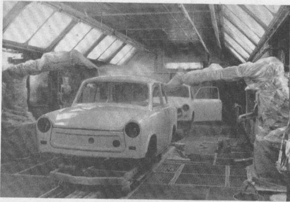
Bild 1-38 Lackierung der Trabant- Karosserie mit frei pro- grammierbaren Robotern
