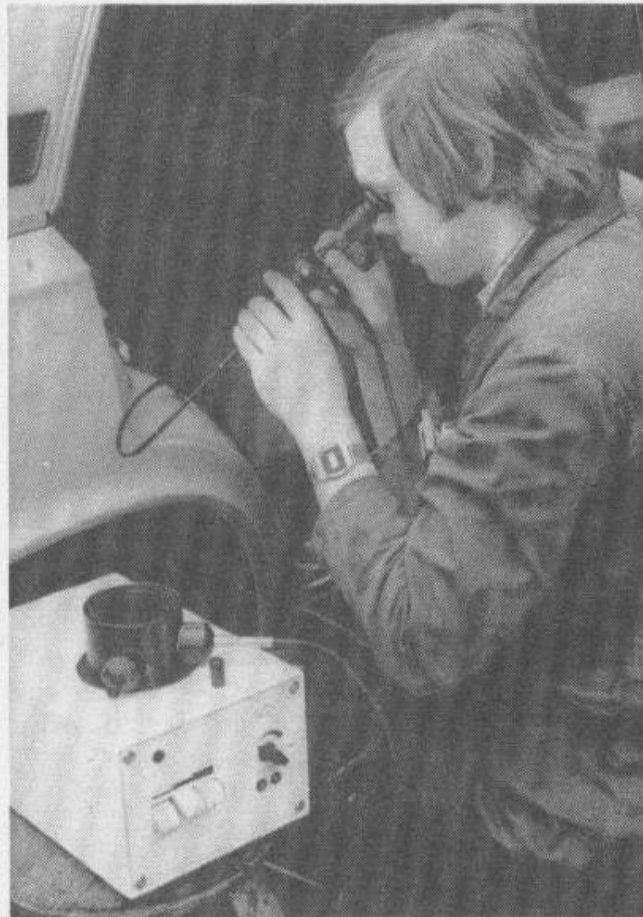
Bild 3-15 Endoskop mit Glasfaseroptik, geeignet für beliebig geformte Hohlprofile
