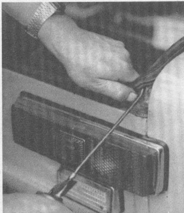
Bild 4-17 Konservierung des Bereiches unterhalb des Kofferraumdichtgummis mittels Spritzkanne und Elaskon K 60 ML
