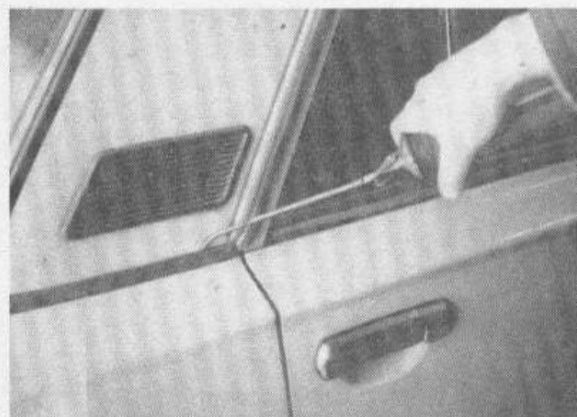
Bild 3-20 Konservierung der Zierleisten mittels Spritzölkanne und Elaskon K 60 ML
