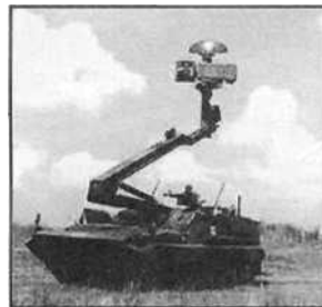
Вместо оптических приборов на мачту можно установить пусковые установки ПТУР и ЗРК Instead optical unit an anti-tank guided missile launcher or anti-aircraft rocket system could be mounted on the mast
