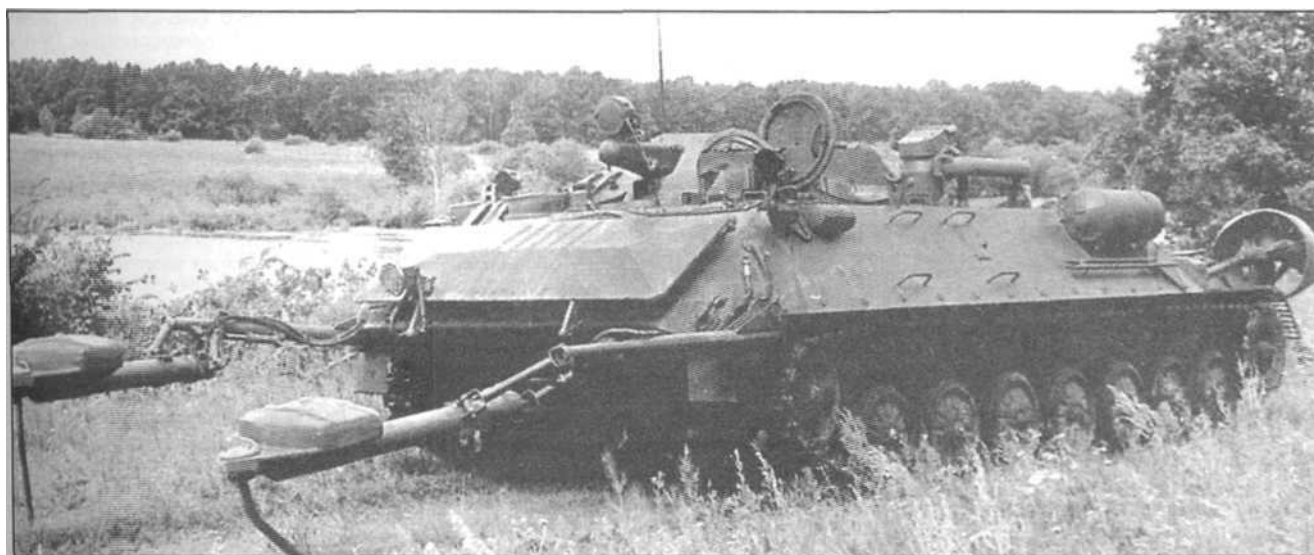
Инженерная разведывательная машина «Жук» (ИРМ) с выдвинутым в рабочее положение речным широкозахватным миноискателем РШМ-2 Performing reconnaissance of a minefield
