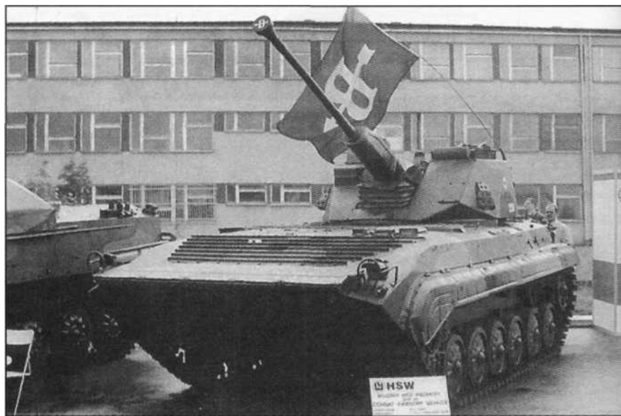
BWP-40 - на стандартном корпусе БМП-1 установлена башня шведской боевой машины пехоты CV 90
