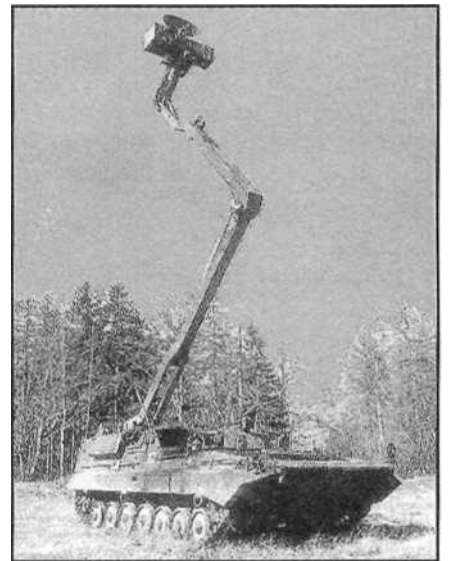
Высота подъема мачты составляет около 10 метров Mast height is about 10 m
