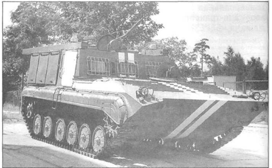
Один из первых образцов ЛПМ-2. Схема окраски с двумя белыми полосами позже применялась очень редко. Проблесковые маячки позже также не устанавливались. Фото из архива 140-го ремонтного завода
