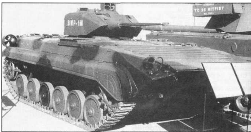
БМП-1М с башней производства United Defence
