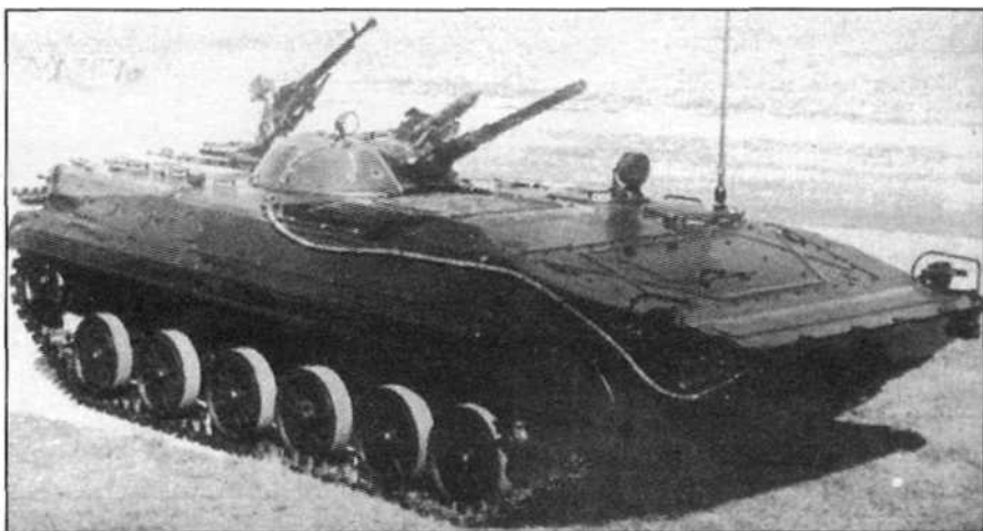
MLI-84. Обратите внимание на установленный за башней зенитный пулемет БШК Note the anti-aircraft BShK machine gun instated above the turret
