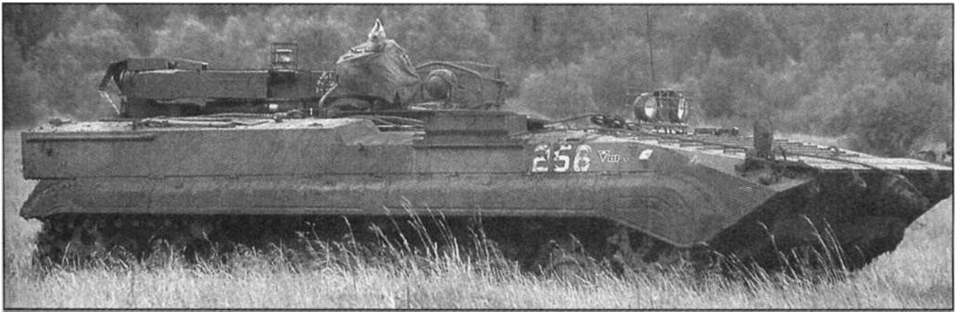
VPV В походном положении. Обратите внимание на размещение фар и проблесковых маячков VPV marching. Note the headlight and rotating beacon arrangement
