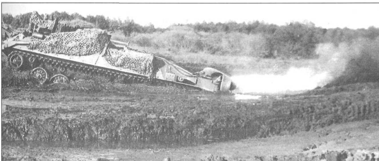
Показательное использование реактивных твердотопливных двигателей для самовытаскивания машины Self-recovery of an ERV with the crew remaining inside the vehicle
