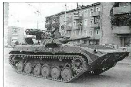
БМП-1 с установкой ПТУР 9М14М «Малютка» демонтированной с боевой машины 9П122. Степанакерт, июль 1993 года. Фото из коллекции М. Барятинского
