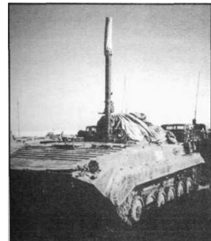
БМП-1КШМ с развернутой антенной
