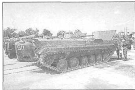
Обратите внимание на поднятый щит и на расположение 6 мортир 902В для постановки дымозавес
