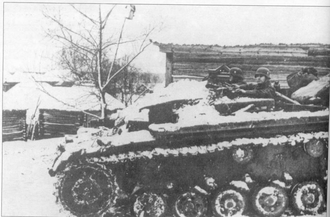
Снег являлся даже лучшей маскировкой, чем белая окраска. Нестойкая краска быстро слезала, обнажая базовый серый цвет. Однако, у экипажей танков и другой техники панцерваффе зимой 1941-1942 г.г. не имелось другого выбора, кроме как окраши- вать свои машины в белый цвет краской на водной основе. Очень часто маскировочную окраску добавляла маскировка есте- ственная - сугробы на броне: см. фотографию.
