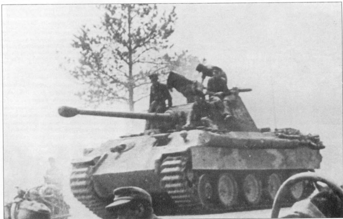
Окрашенная в трехцветный камуфляж «Пантера» сфотографирована недалеко от стыка границ Польши, Украины и Белоруссии. Производство танков Pz.Krfw. V Ausf. G «Пантера» началось в марте 1944 г. и продолжалось до конца войны.
