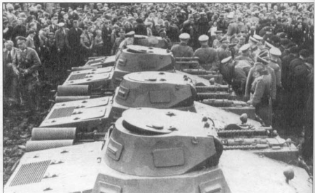
Танковое подразделение на учениях в Пруссии. На танках Pz.Krfw. I хорошо различимы пятна камуфляжной окраски. От танка к танку форма пятен несколько отличается, однако общая схема нанесения камуфляжа одинаковая. Башни окрашены в два цвета, корпуса - в три - зеленый, серый и коричневый. Камуфляжную окраску танков упростили в 1935 г.
