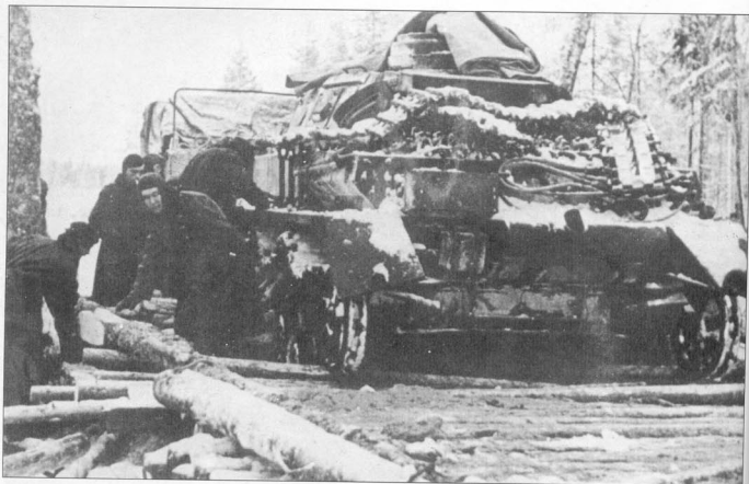
На лесной дороге застрял танк Pz.Kpfw. IV. Под машиной проломился деревянный мостик, бревна заблокировали два прова- лившихся опорных катка. Суровой зимой 1941-42 г.г. немцам пришлось бросить большое количество боевых машин из-за не- хватки горючего, тягачей и времени.
