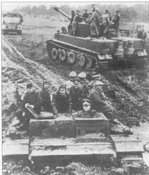
Еще один снимок, сделанный во время обучения пехотинцев приемам борьбы с танками. Обратите внимание - у штурмового орудия StuG III в белый цвет перекрашены только верхние поверхности, борта корпуса в районе ходовой части и нижний лобовой бронелист остались серыми.
