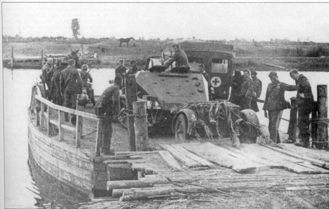
Переправа через реку под Смоленском. На пароме полугусеничный транспортер боеприпасов Sd.Kfz. 252 из батареи самоходных гаубиц, сентябрь 1941 г. Полугусеничный транспортер Sd.Kfz. 252 имел общую базу с бронетранспортером Sd.Kfz. 250.
