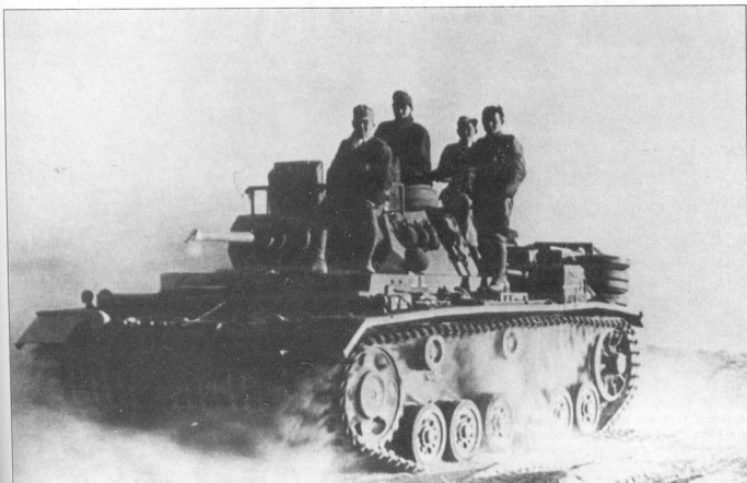
Вооруженный короткоствольной 50-мм пушкой танк Pz-Kpfw. III Ausf. J на марше через североафриканскую пустыню, февраль 1942 г. На крыше башни и крыше моторного отделения закреплены канистры с водой и горючим. На танке для простоты крепления канистр наварены специальные рамы-багажники.
