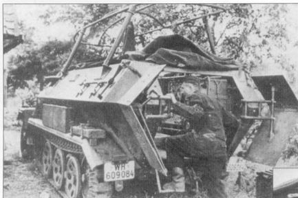
Через открытую кормовую дверь штабного бронетранспортера Sd.Kfz. 251/6 Ausf. В хорошо видно радиоборудование. Широкое использование радиосвязи обеспечивало гибкое управление моторизованными подразделениями вермахта.
