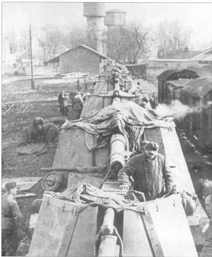
Снимок сделан в окрестностях Ковеля в марте - апреле 1944 г. Самоходные гаубицы вероятно принадлежат подразделению 3-й танковой дивизии СС «Мертвая Голова». Самоходки погружены на железнодорожные платформы. На переднем плане - самоходка Sd.Kfz. 124 «Веспе» на шасси танка Pz.Krfw. II, вооруженная 105-мм орудием. За ней - 150-мм самоходно-артиллерийская установка «Хуммель», САУ «Хуммель» выпускались на шасси танков Pz.Krfw. III и Pz.Krfw. IV. Все боевые машины имеют типичную камуфляжную окраску - зеленые и коричневые пятна поверх базового темно-желтого тона. На рубке САУ «Веспе» видна выполненная готическим шрифтом надпись «Rolf Sirb», ниже - дата «28.8.1943».
