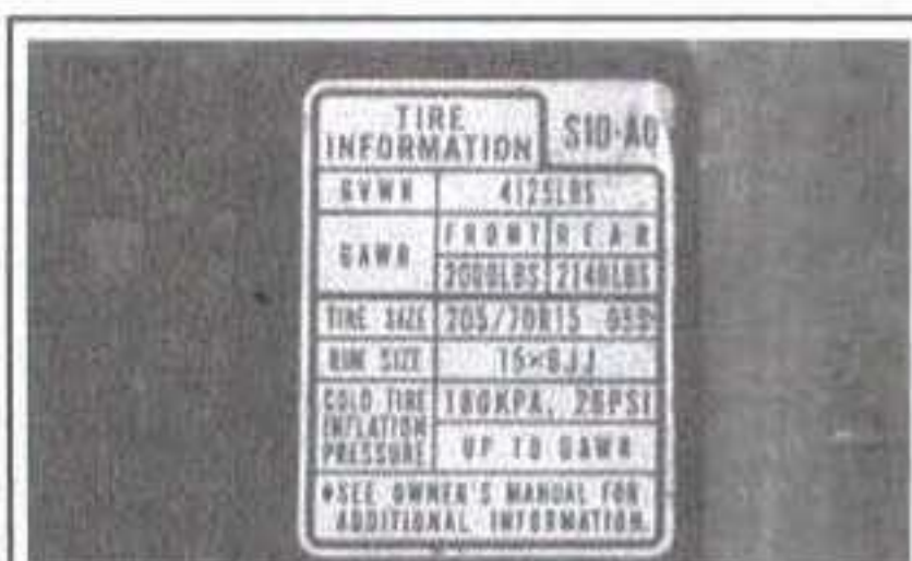
Рис. 144 Наклейка с рекомендуемыми размерами шин и давлением накачки расположена изнутри двери водителя
