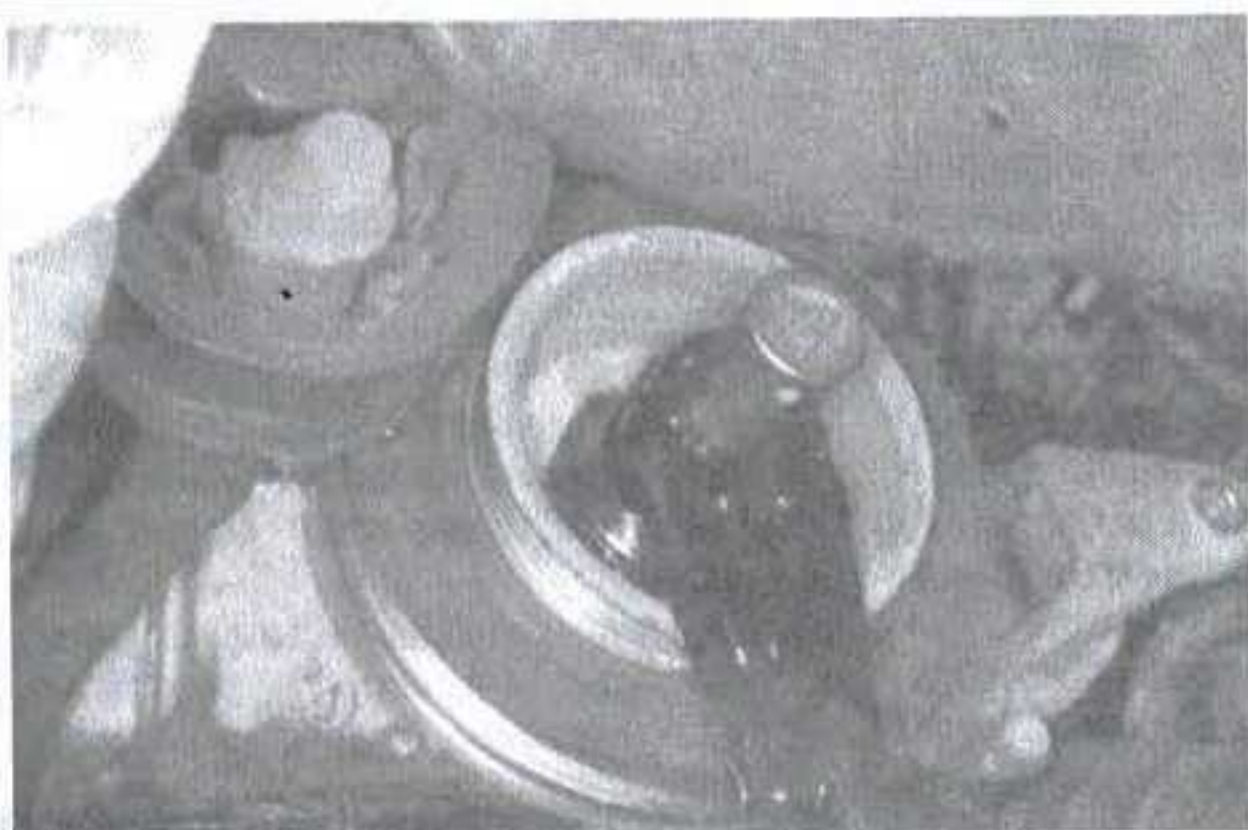
Рис. 59 ...накиньте на болт шкива коленчатого вала подходящую 1/2-дюймовую головку глубиной 19 мм через фиксатор
