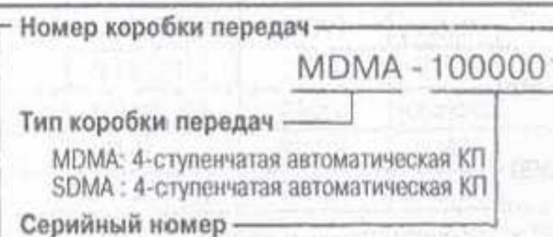
Рис. 38 Разбивка типового номера коробки передач—показан CR-V 1997г
