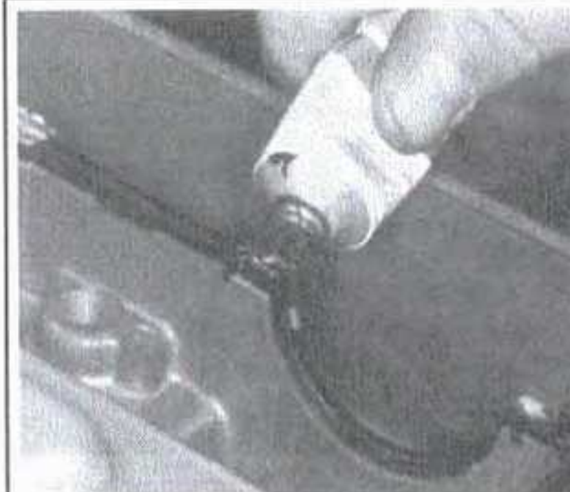
Рис. 15 При сборке нанесите незатвердеваемый герметик по всем углам серповидных участков прокладки клапанной крышки
