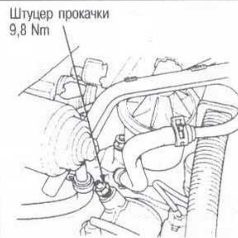
Рис. 28 Штуцер прокачки системы охлаждения расположен возле корпуса термостата на моделях Odyssey с 4-цилиндровыми двигателями
