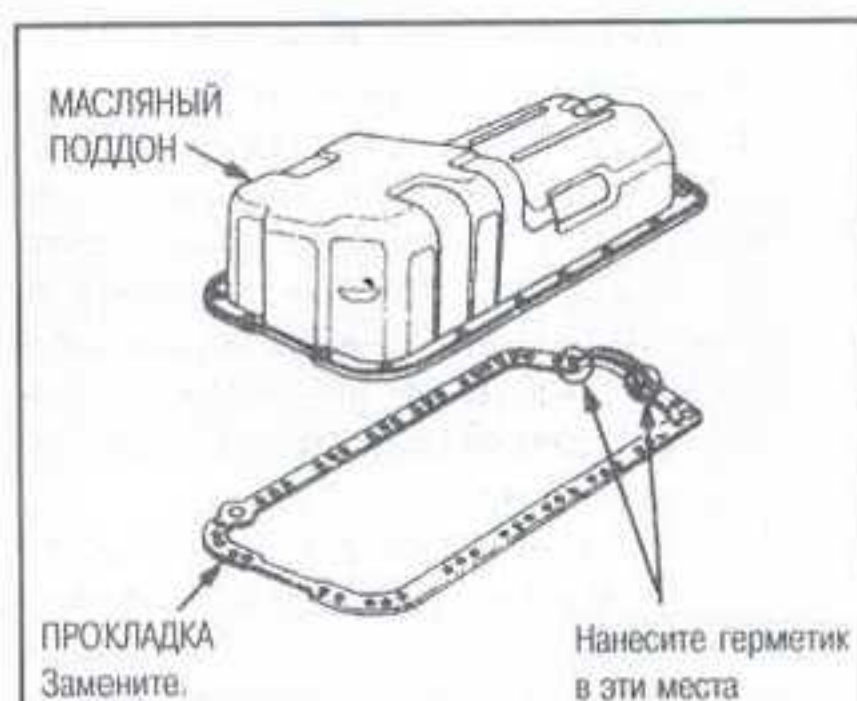
Рис. 45 Установка прокладки масляного поддона - модели CR-V и 4-цилиндровые модели Odyssey
