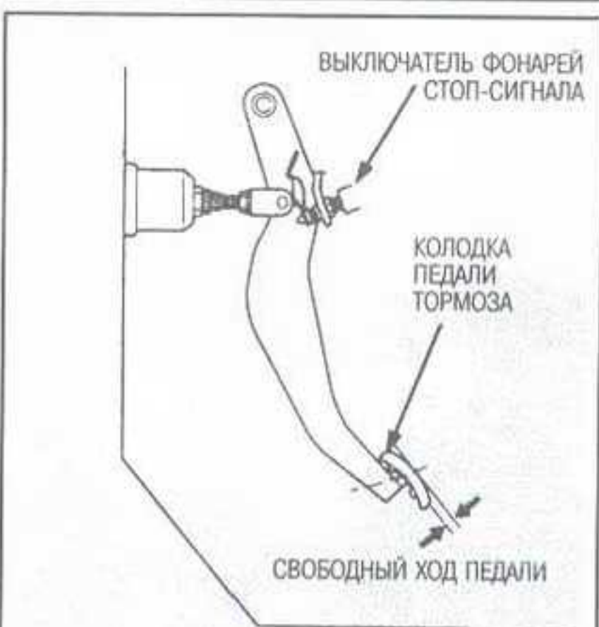
Рис. 3 Свободный ход педали тормоза регулируется перемещением выключателя фонарей стоп-сигнала — показана модель CR-V
