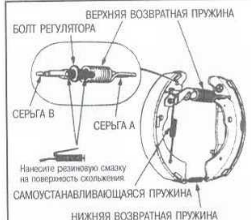
Рис. 61 Нанесите подходящую смазку для резины на ось и резьбовой участок болта регулятора — показана модель CR-V
