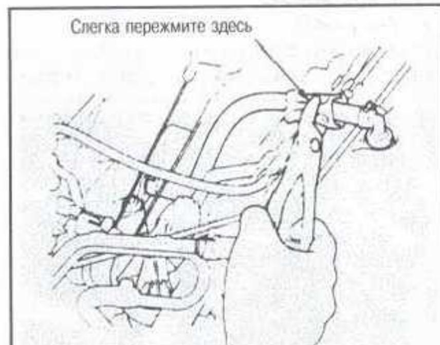
Рис. 2 Пока прогретый двигатель работает на оборотах холостого хода, при пережимании шланга клапана PCV, должен слышаться щелкающий звук
