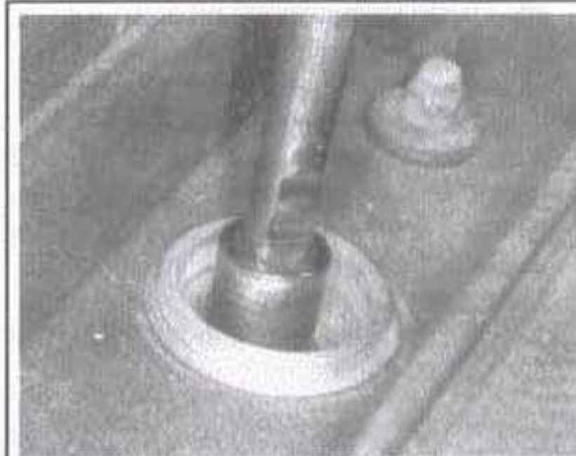
Рис. 91 В зависимости от плотности посадки головки и двигателя осторожно вытяните свечу зажигания из цилиндра
