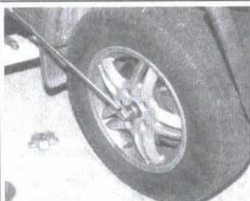
Рис. 32 Сняв центральный колпак, ослабьте и открутите фланцевую гайку полуоси
