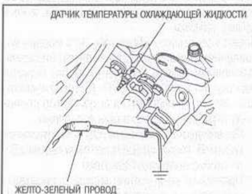
Рис. 39 Испытание указателя температуры охлаждающей жидкости — показана модель CR-V
