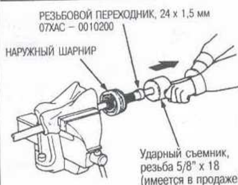
Рис. 26 Снятие наружного шарнира на автомобилях 1998 г.в. или позднее требует применения подходящего ударного съемника и переходника. Если их нет, разберите внутренние компоненты и замените чехол
