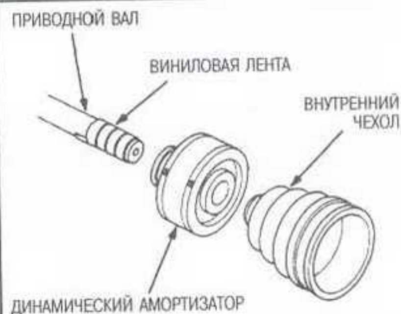
Рис. 24 При снятии компонентов с ведущей оси оберните шлицы виниловой лентой во избежание повреждения чехла или амортизатора
