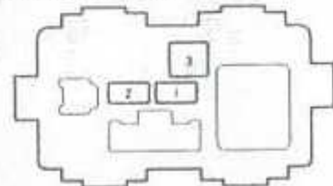
Рис. 60 Панель плавких предохранителей под капотом и типовая панель плавких предохранителей системы ABS на моделях CR-V
