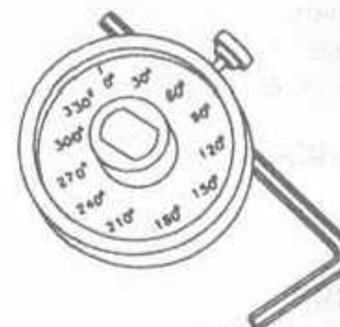
Рис. 31 Некоторые спецификации требуют применения динамометрического ключа-угломера (механического транспортира)
