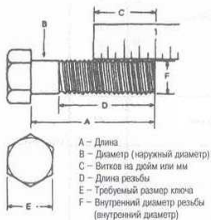
Рис. 22 Размеры резьбовой крепежной детали определяются по этим измерениям
