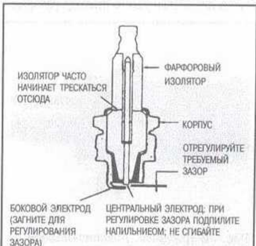
Рис. 85 Свеча зажигания в разрезе
