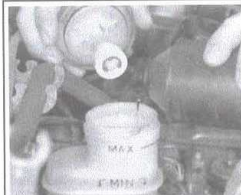
Рис. 175 Долейте тормозную жидкость DOT 3 до уровня MAX. Не проливайте тормозную жидкость, т.к. она может испортить окрашенные поверхности
