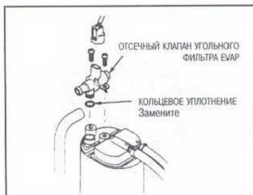
Рис. 7 Отсечный клапан устанавливается сверху угольного фильтра - модели CR-V 1998-99 г.в.
