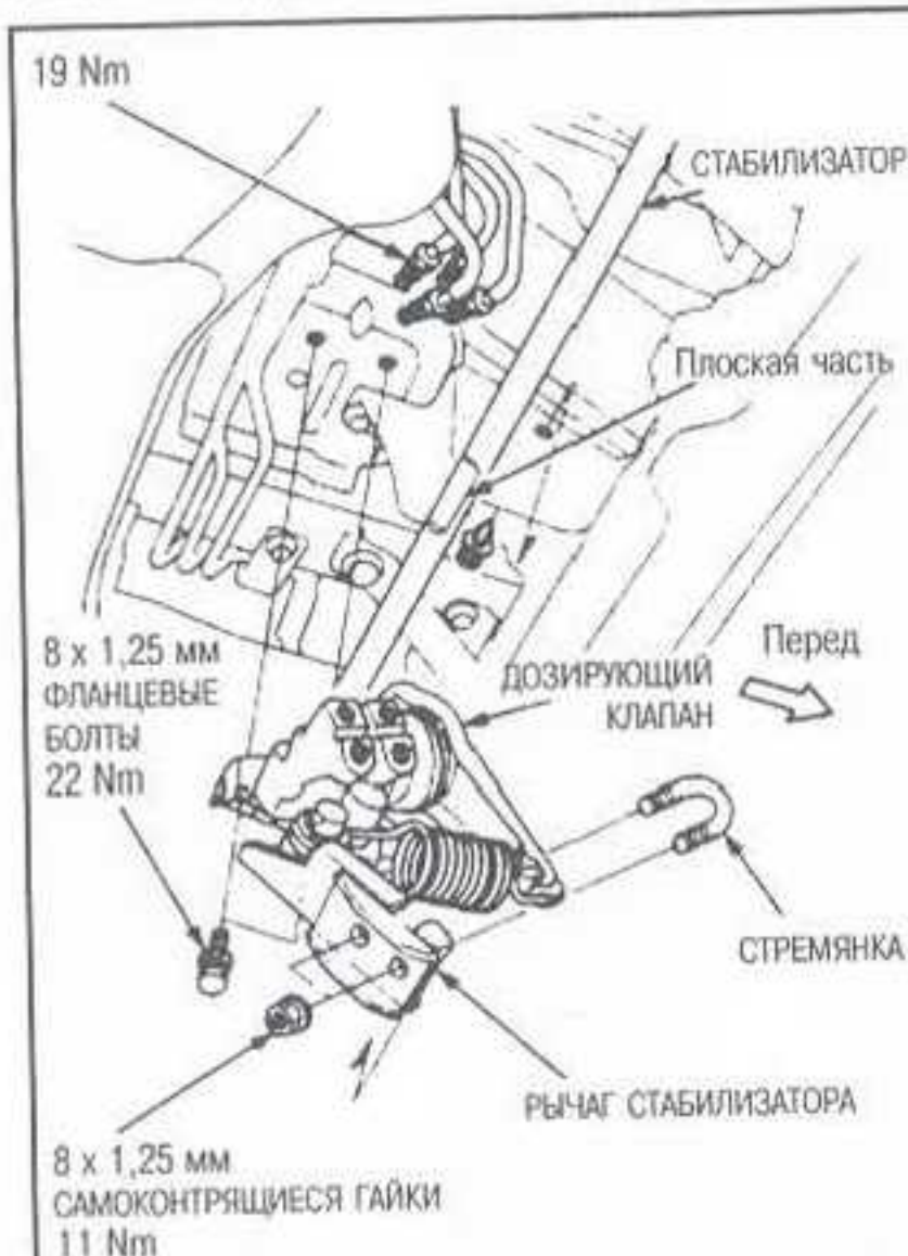
Рис. 9 Дозирующий клапан (LSPV) и смежные компоненты - 4-цилиндровые модели Odyssey
