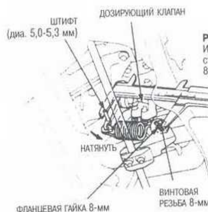
Рис. 11 Использование штангенциркуля с нониусом для измерения расстояния от вставленного штифта до винтовой резьбы 8-мм
