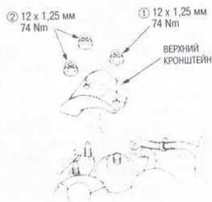
Рис. 5 Порядок затяжки верхнего кронштейна - модели CR-V
