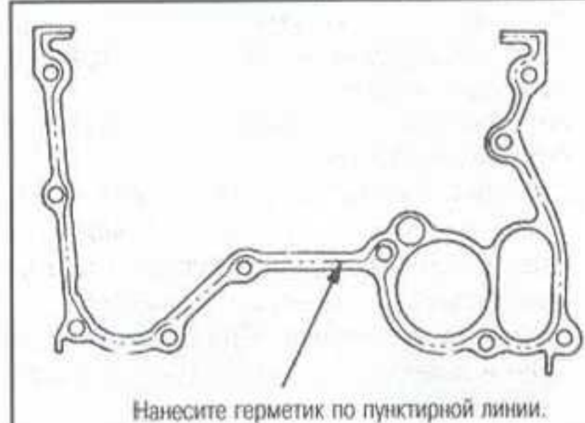
Рис. 52 Нанесите герметик на корпус масляного насоса, как показано на рисунке - 4-цилиндровые двигатели моделей Odyssey
