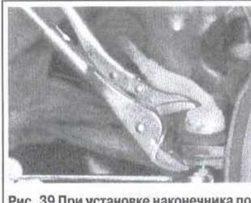
Рис. 39 При установке наконечника поперечной рулевой тяги в поворотный кулак, удерживайте при помощи клещей конусную ось на месте от свободного проворачивания
