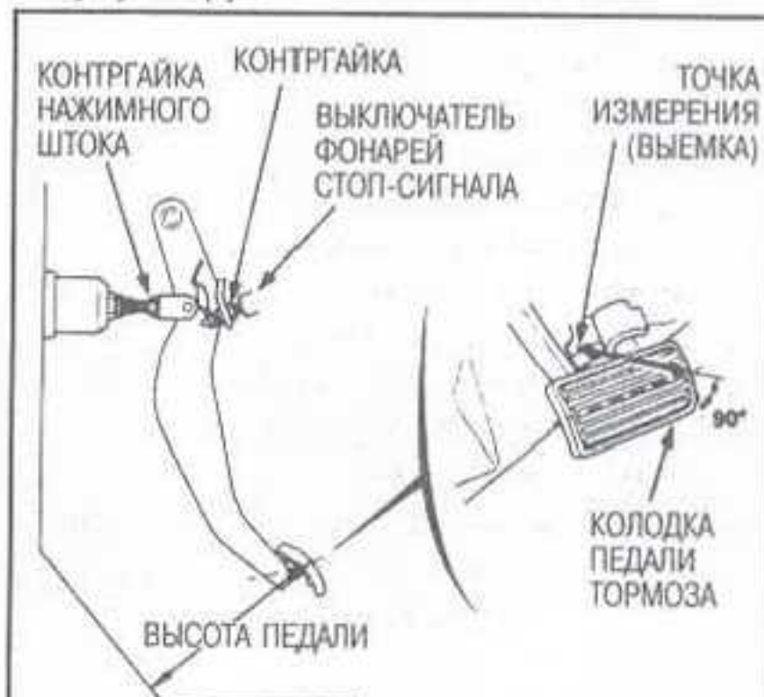
Рис. 2 Резьбовой шток используется для регулирования высоты педали тормоза — показана модель CR-V
