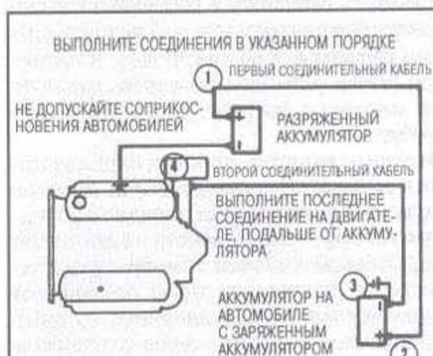
Рис. 191 Подсоедините соединительные кабели к аккумуляторам и двигателю в указанном порядке
