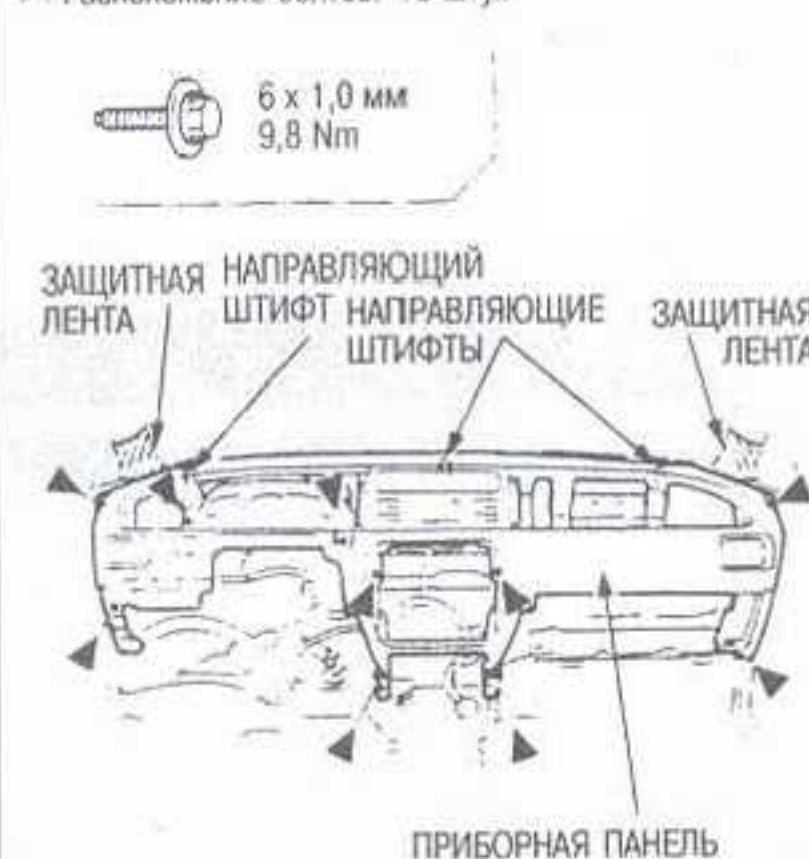
Рис. 23 Тип крепежных деталей и их расположение для снятия/установки приборной панели — показана 4-цилиндровая модель Odyssey
