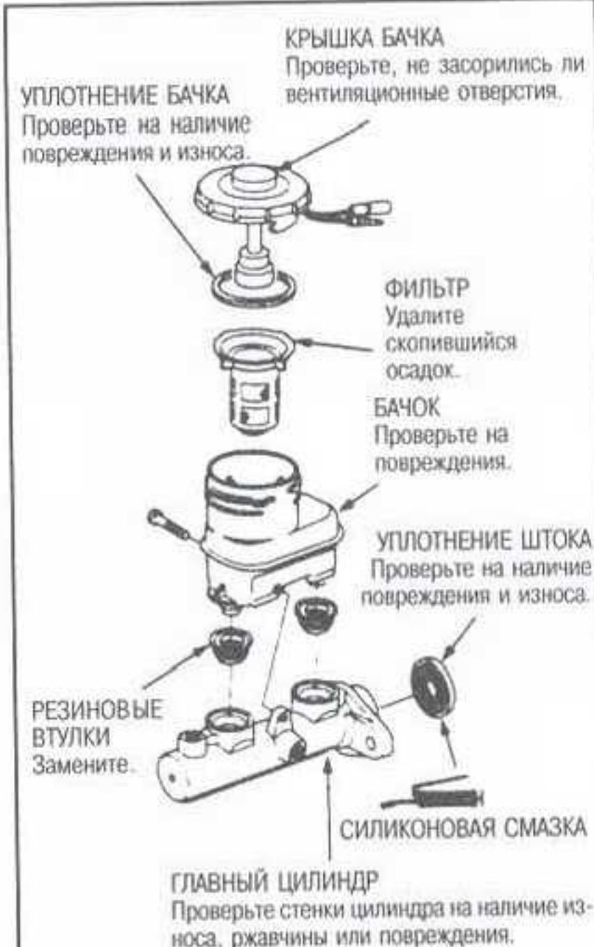
Рис. 7 Типовой главный цилиндр тормозной системы и смежные компоненты — показана модель CR-V
