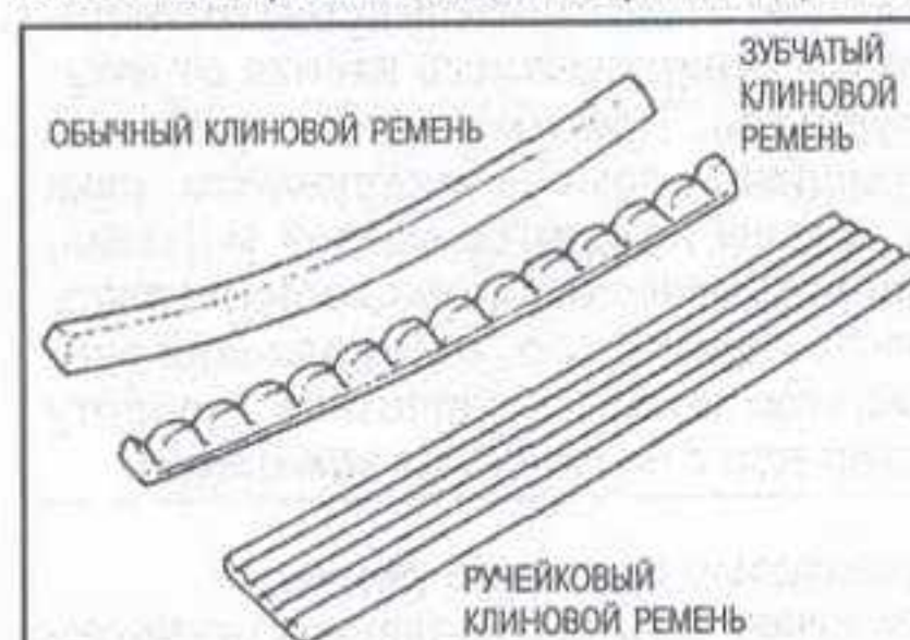
Рис. 63 В современных автомобилях применяются ремни привода дополнительного оборудования 3 типов. Петлевой ремень очень похож на клиновой ручейковый ремень
