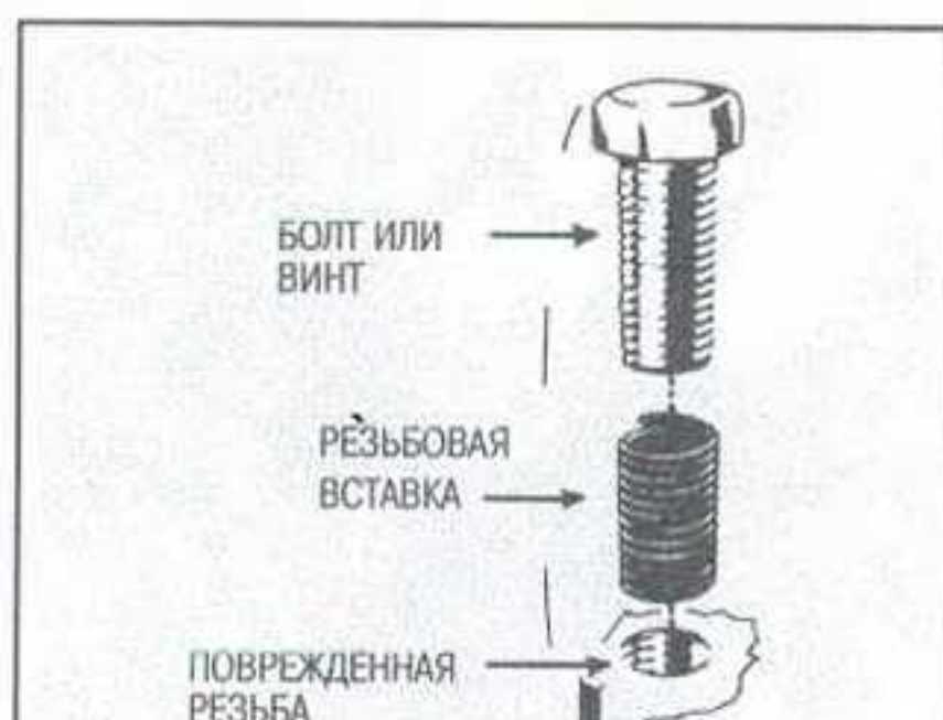
Рис. 123 Поврежденную резьбу в отверстии под болт можно заменить резьбовыми вставками
