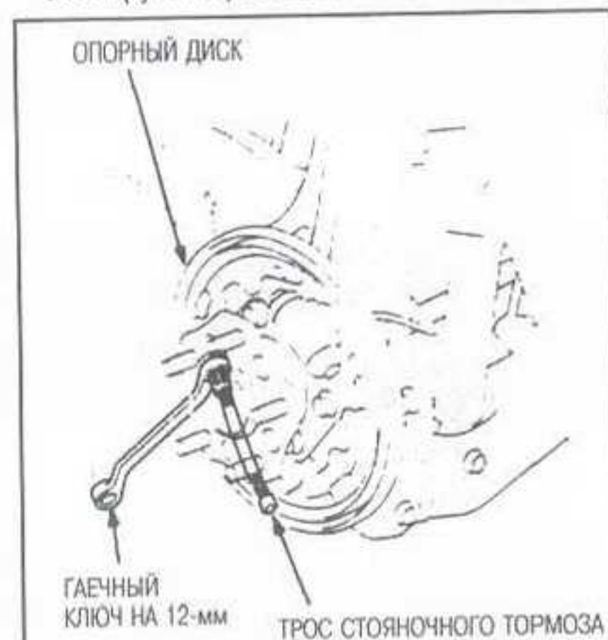
Рис. 80 Снимите трос стояночного тормоза с опорного диска при помощи 12-мм коленчатого гаечного ключа
