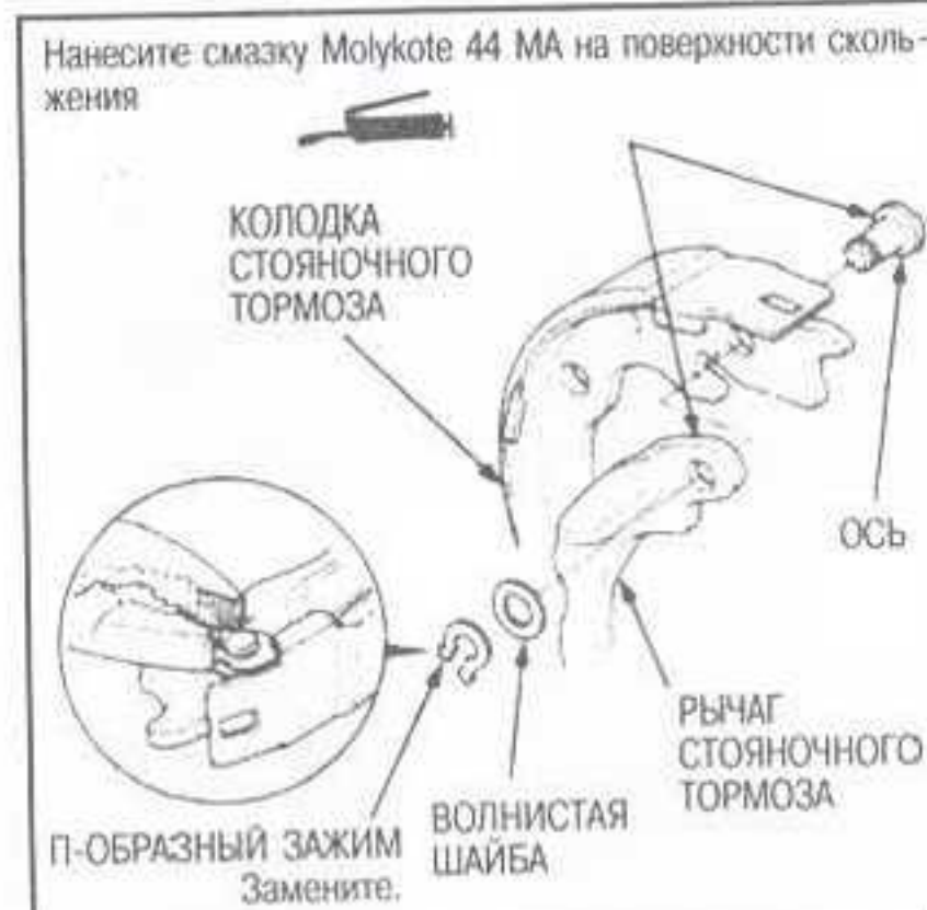
Рис. 88 Рычаг крепится к тормозной колодке при помощи оси и П-образного зажима
