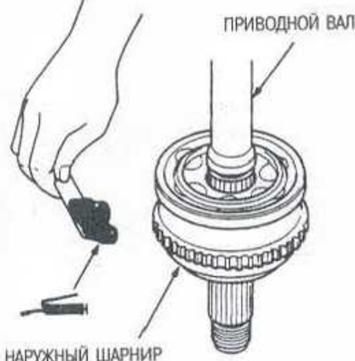
Рис. 29 Набейте наружный ШРУС в сборе рекомендуемой смазкой при помощи лопаточки шириной 50 мм
