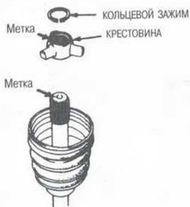
Рис. 23 Крестовина крепится на шлицевой ведущей оси при помощи кольцевого зажима. При повторной сборке поставьте новый кольцевой зажим
