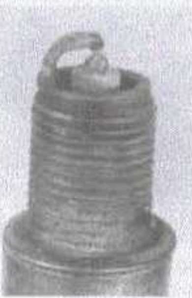
Рис. 92 Осмотрите свечи зажигания для определения режима работы двигателя
