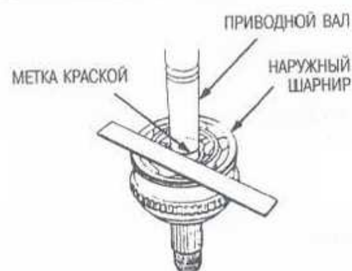
Рис. 22 При снятии роликов с крестовины пометьте их расположение и расположение крестовины относительно шлицевой оси для обеспечения правильной сборки
