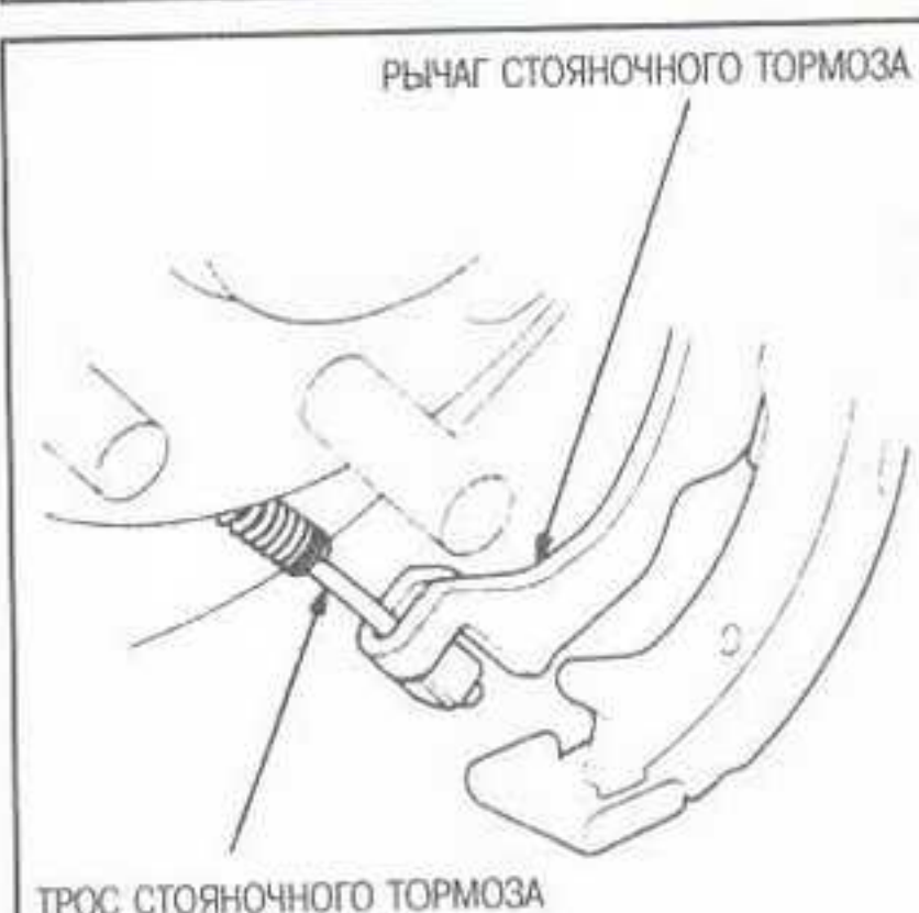
Рис. 87 Трос стояночного тормоза крепится к рычагу, который качается на тормозной колодке
