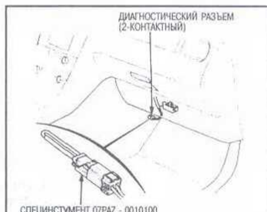
Рис. 39 На моделях Odyssey 1995 диагностический разъем служит для получения доступа к кодам по миганию сигнальной лампы. Вместо специнструмента можно воспользоваться канцелярской скрепкой, осторожно вставив ее в разъем со стороны жгута, чтобы временно перемкнуть оба провода
