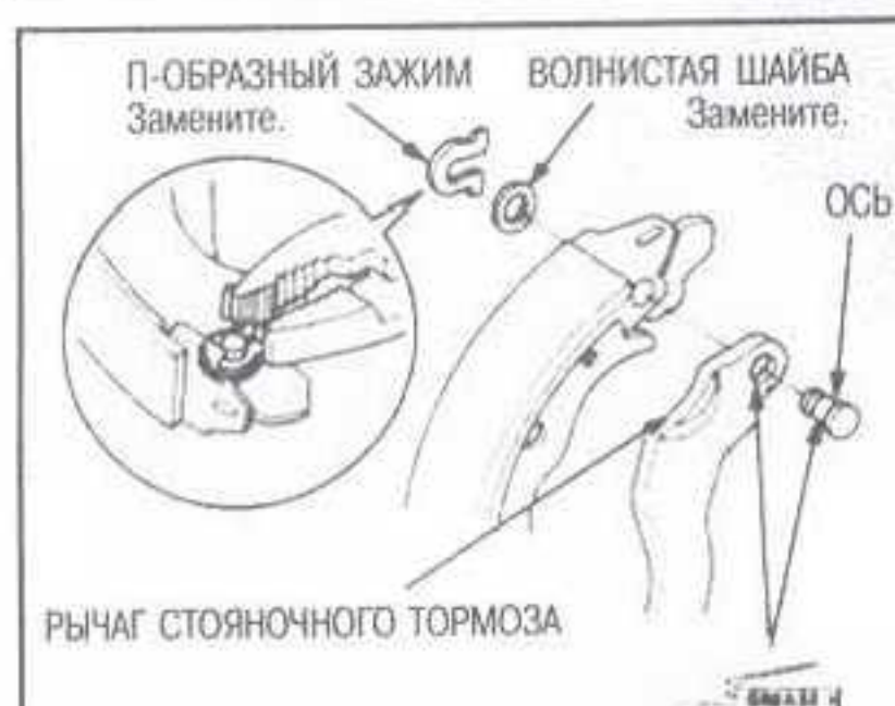
Рис. 56 Снимите трос стояночного тормоза с рычага при помощи плоскогубцев — показана модель CR-V
