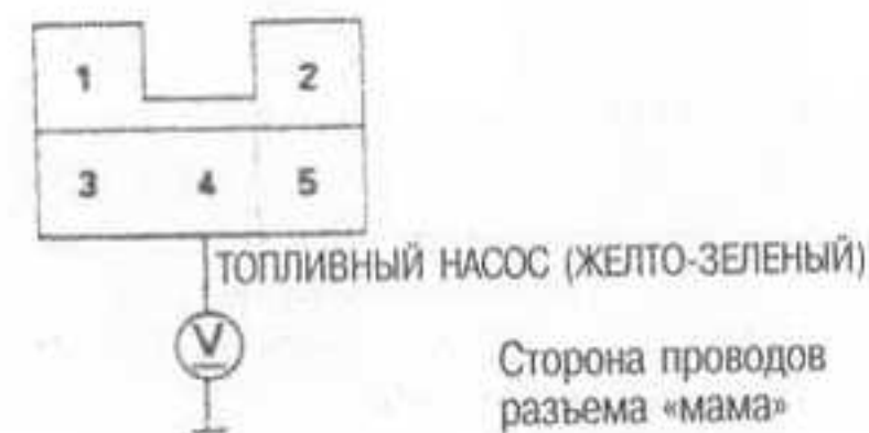
Рис. 22 На моделях CR-V электропитание на топливный насос подается от главного реле системы PGM-FI на контакт № 4
