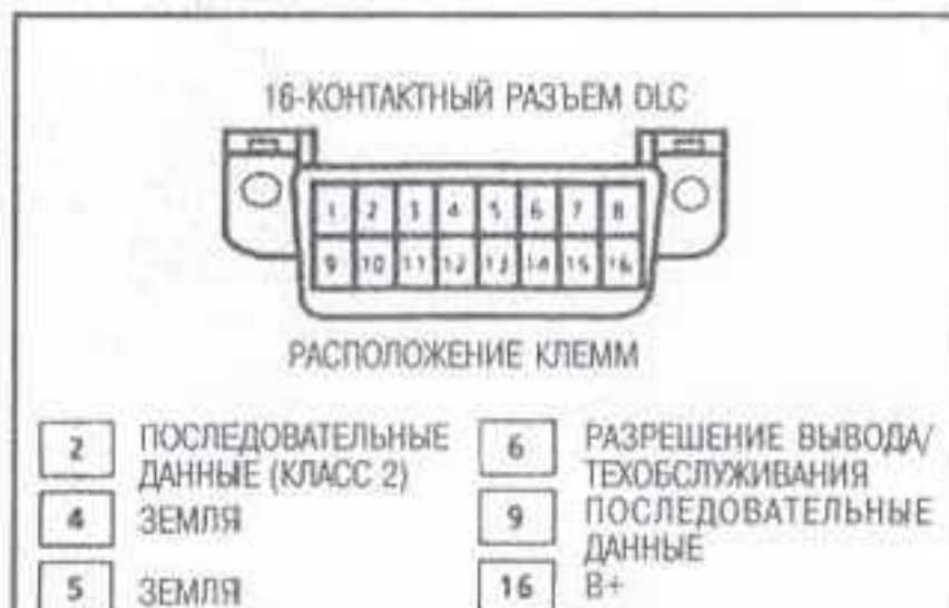
Рис. 40 16-контактный разъем DLC входит в стандартную комплектацию автомобилей, соответствующих требованиям системы бортовой диагностики версии II (OBD II)
