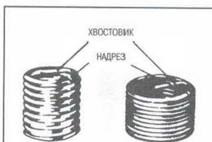
Рис. 124 Стандартная ремонтная резьбовая вставка (слева) и резьбовая вставка под свечу зажигания
