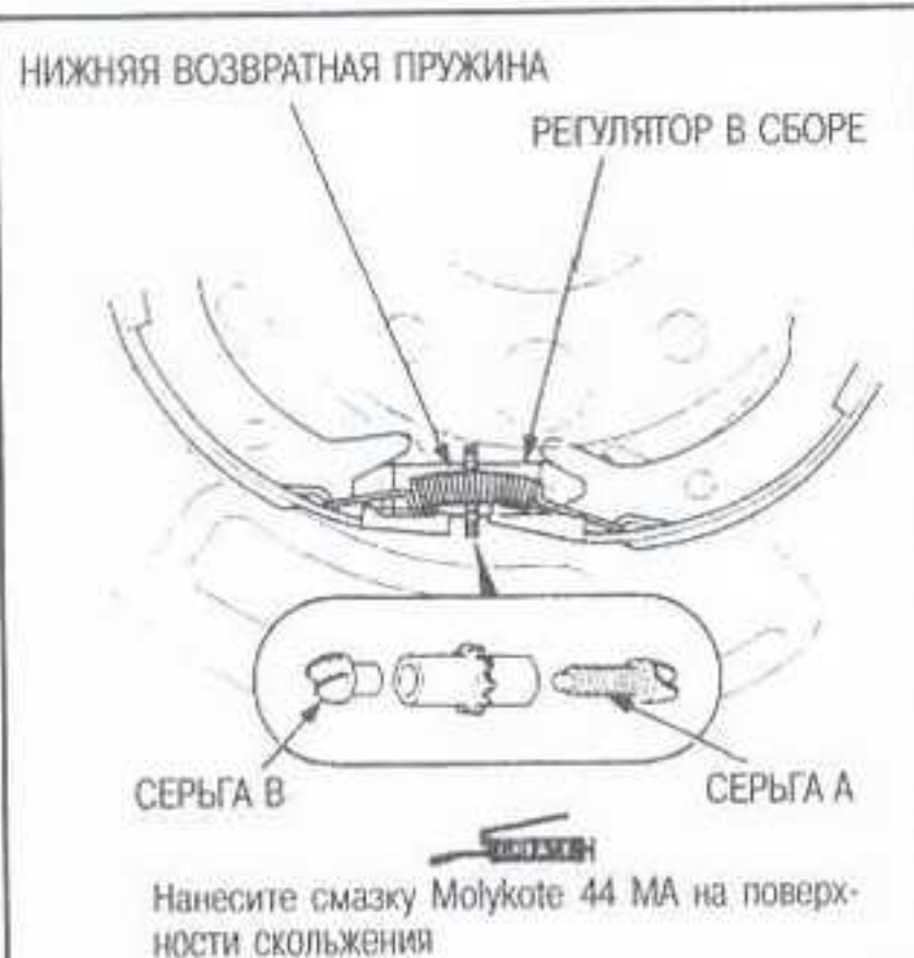
Рис. 91 Нанесите высокотемпературную смазку для тормозов на поверхности скольжения регулятора стояночного тормоза
