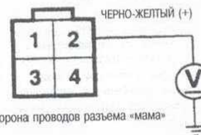
Рис. 24 На 2,3 л моделях Odyssey электропитание на топливный насос подается от главного реле системы PGM-FI на контакт № 2
