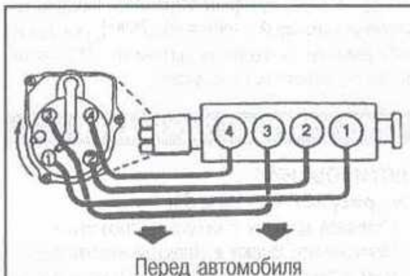
Рис. 22 Порядок работы цилиндров двигателя 2,3 л: 1-3-4-2 Направление вращения распределителя: по часовой стрелке
