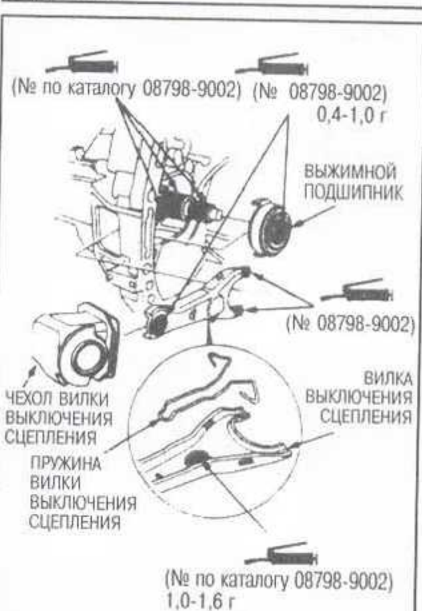
Рис. 54 Для плавной работы механизмов выключения сцепления нанесите подходящую высокотемпературную консистентную смазку на эти компоненты
