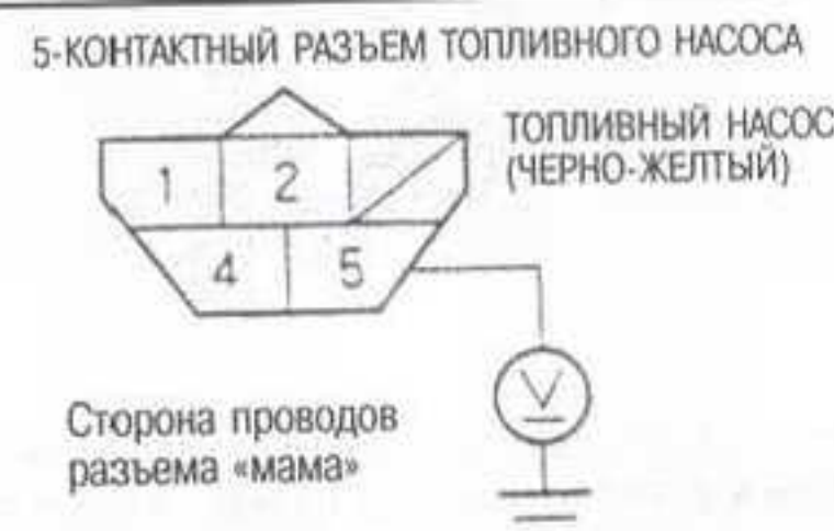
Рис. 25 На моделях Odyssey V6 электропитание на топливный насос подается от главного реле системы PGM-FI на контакт № 5
