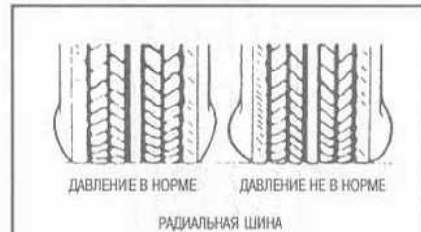
Рис. 142 У радиальных шин имеется характерное вздутие на боковинах; не пытайтесь измерить давление по внешнему виду шины. Воспользуйтесь качественным манометром.
