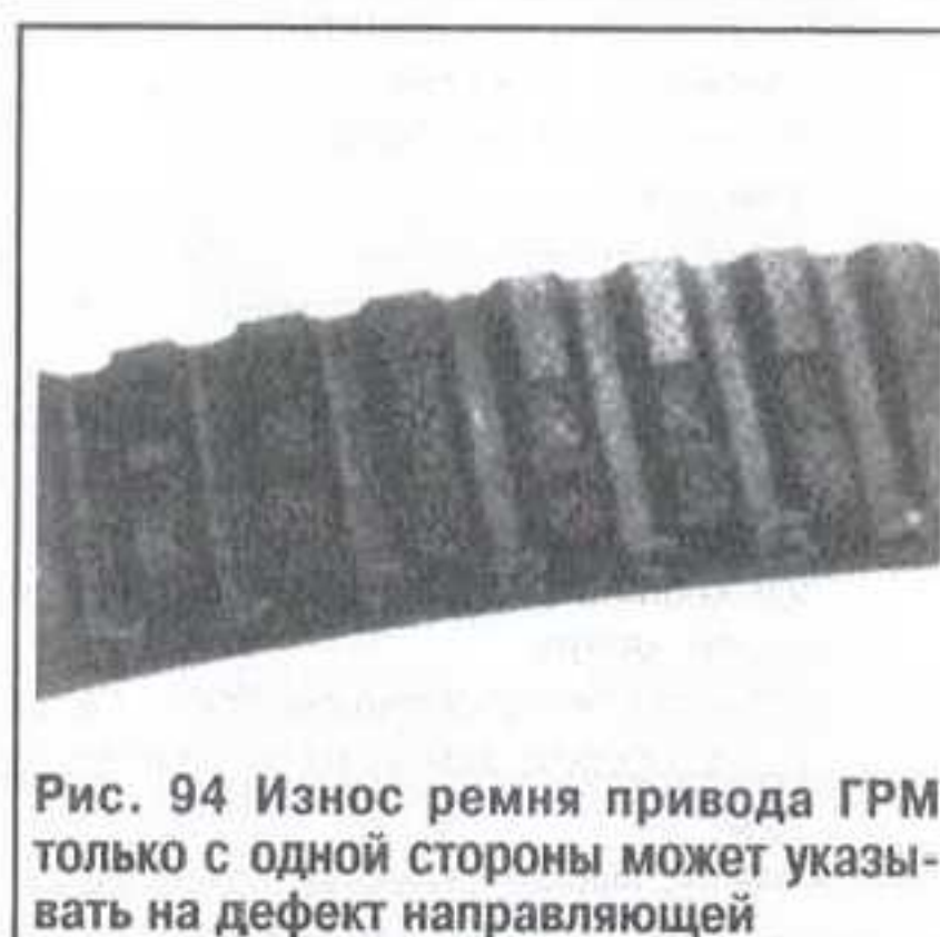
Рис. 91 Ремень может быть поврежден только с одной стороны; в этом случае вероятная причина скорее всего в направляющей
