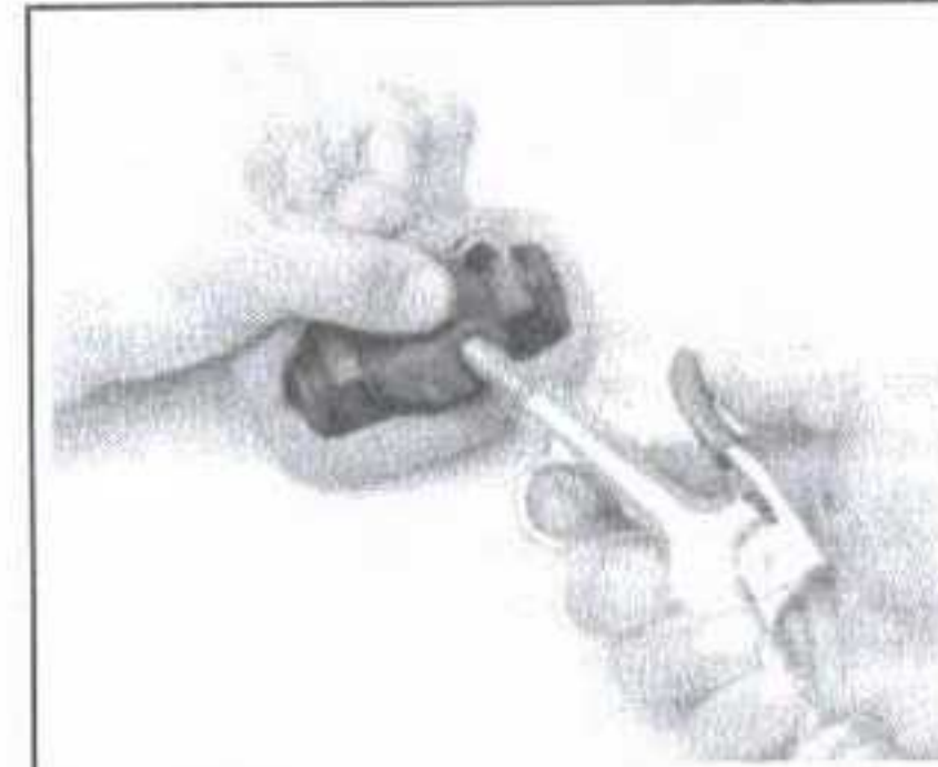
Рис. 71 Для извлечения поршней и уплотнений можно воспользоваться сжатым воздухом
