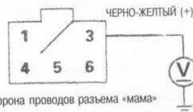
Рис. 23 На 2,2 л моделях Odyssey электропитание на топливный насос подается от главного реле системы PGM-FI на контакт № 3
