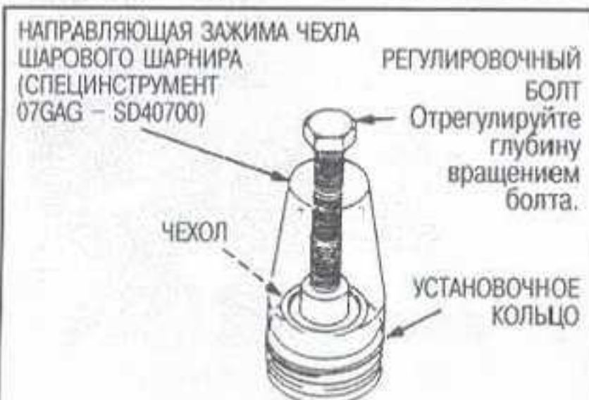
Рис. 25 ...затем на шаровой шарнир надевается чехол и ставится зажим. Отрегулируйте положение зажима на чехле шарового шарнира перед установкой поворотного кулака
