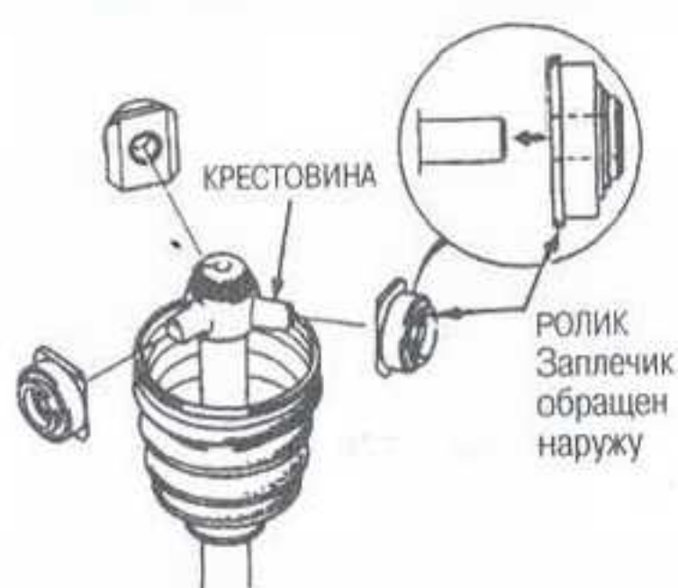
Рис. 22 При снятии роликов с крестовины пометьте их расположение и расположение крестовины относительно шлицевой оси для обеспечения правильной сборки
