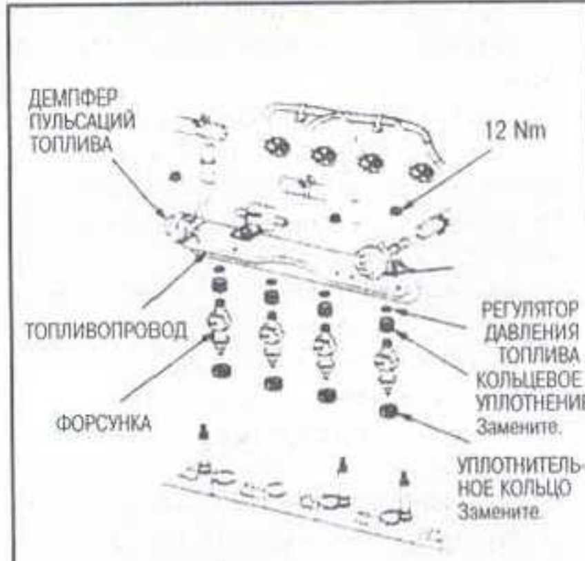
Рис. 31 Распределительный топливопровод и форсунки — показана модель CR-V 1999
