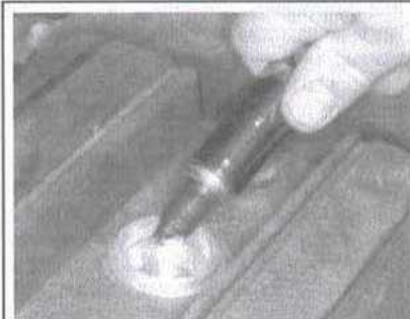
Рис. 90 Надевайте головку на свечу без перекоса; в противном случае возможно повреждение керамического изолятора, что весьма осложнит снятие
