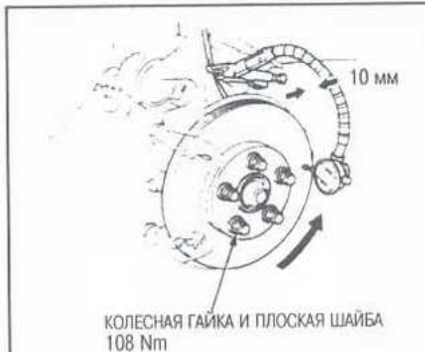
Рис. 49 Измеряйте биение тормозного диска индикатором
