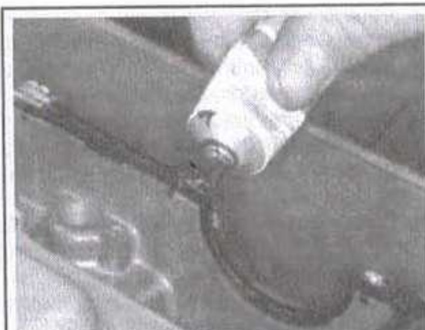
Рис. 112 На каждый угол прокладки клапанной крышки следует нанести незатвердевающий герметик. Перед нанесением герметика убедитесь, что прокладка и поверхность под прокладку головки цилиндров чистые и сухие
