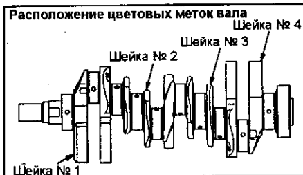
Серия 6G7 - Тип "1" маркировки вала.
