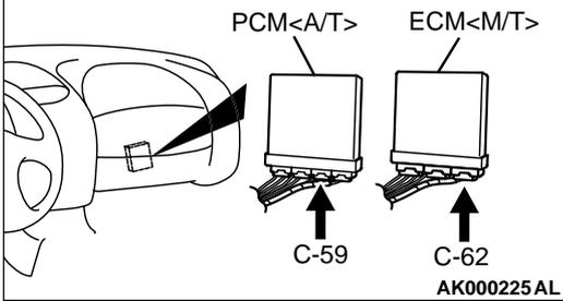
**STEP 4. Check connector C-62 at ECM <M/T> or connector C-59 at PCM <A/T> for damage.**
