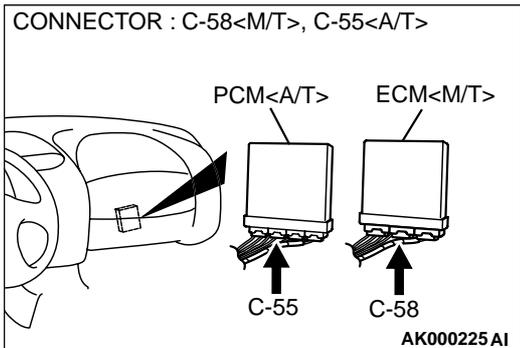
**STEP 14. Check connector C-58 at ECM <M/T> or connector C-55 at PCM <A/T> for damage.**
