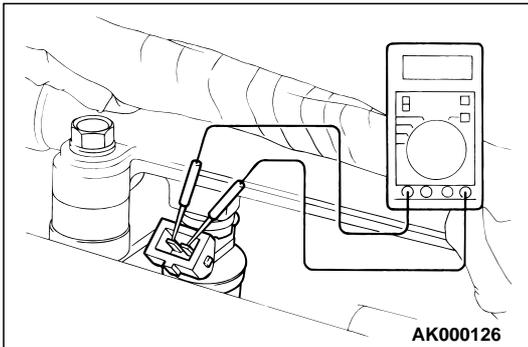
**IDLE AIR CONTROL MOTOR (STEPPER MOTOR) CHECK**
