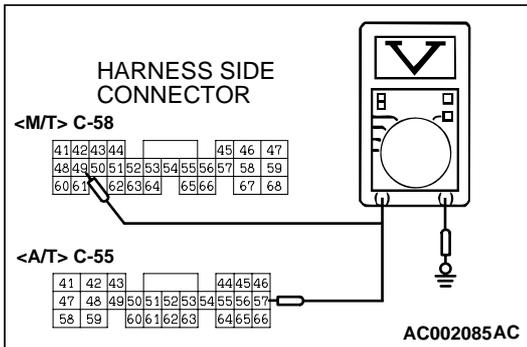
**STEP 16. Check ECM connector C-58 <M/T> or PCM connector C-55 <A/T> for damage.**
