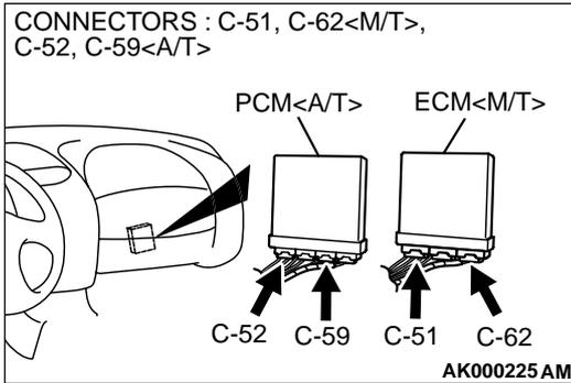
**STEP 2. Check the circuit at ECM connector C-51 <M/T> or PCM connector C-52 <A/T>.**
