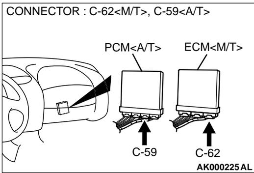
**STEP 3. Check connector C-62 at ECM <M/T> or connector C-59 at PCM <A/T> for damage.**
