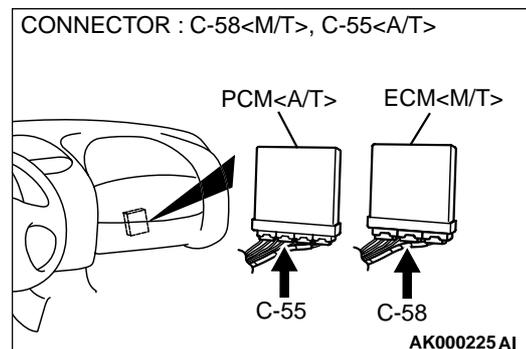
**STEP 16. Check connector C-58 at ECM <M/T> or connector C-55 at PCM <A/T> for damage.**
