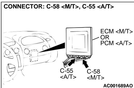
**STEP 12. Check ECM connector C-58 <M/T> or PCM connector C-55 <A/T> for damage.**
