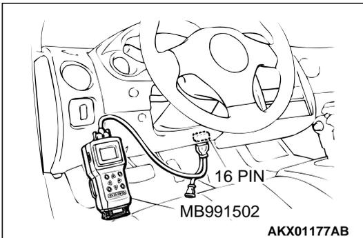
**DTC P0500: Vehicle Speed Sensor Malfunction <A/T>**
