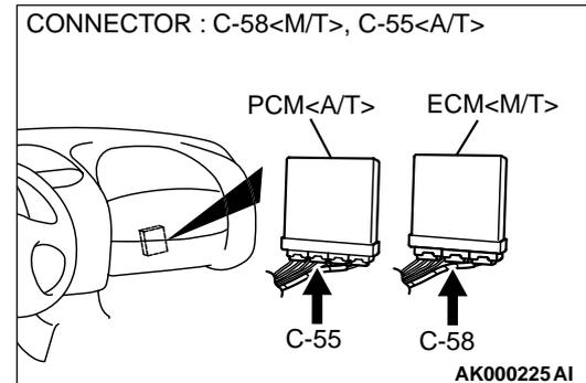
**STEP 9. Check connector C-58 at ECM <M/T> or connector C-55 at PCM <A/T> for damage.**
