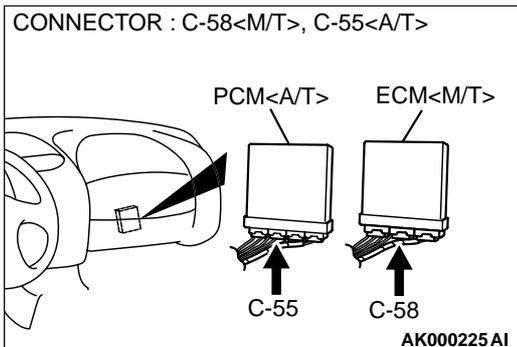
**STEP 9. Check connector C-58 at ECM <M/T> or connector C-55 at PCM <A/T> for damage.**
