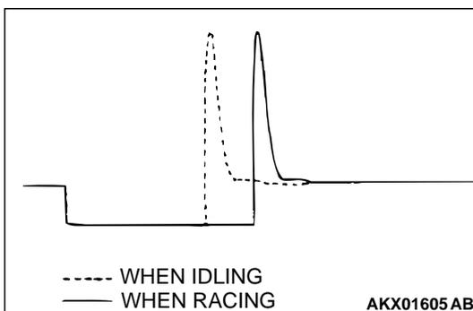
**IDLE AIR CONTROL MOTOR (STEPPER MOTOR)**
