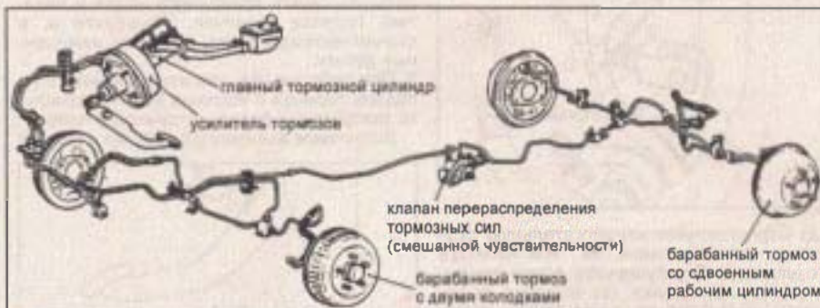
2WD (с клапаном смешанной чувствительности).
