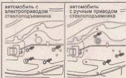
7. Снимите переднюю направляющую стекла. Отвернуть болты, крепящие переднюю направляющую стекла, и затем вынуть ее через нишу в каркасе двери.
