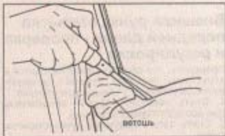
4. Снимите стекло передней двери. а) Опустить стекло полностью. б) Отвернуть болты, крепящие направляющую стеклоподъемника.
