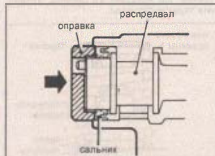
1 - сальник, 2 - штифт, 3 - распределительный вал.
