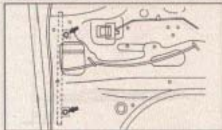
8. Снимите направляющую стекла. Отвернуть болт, крепящий направляющую стекла и затем вынуть направляющую.
