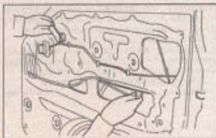
в) Осторожно поднять стекло. г) Наклонить стекло и извлечь ролик из направляющей. Освободить стекло от роликов.
