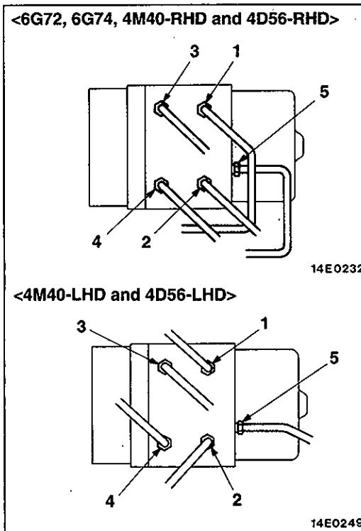
**INSTALLATION SERVICE POINT****1. BRAKE TUBE CONNECTION**
