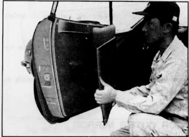
Fig. BF-26 Removing door finish
