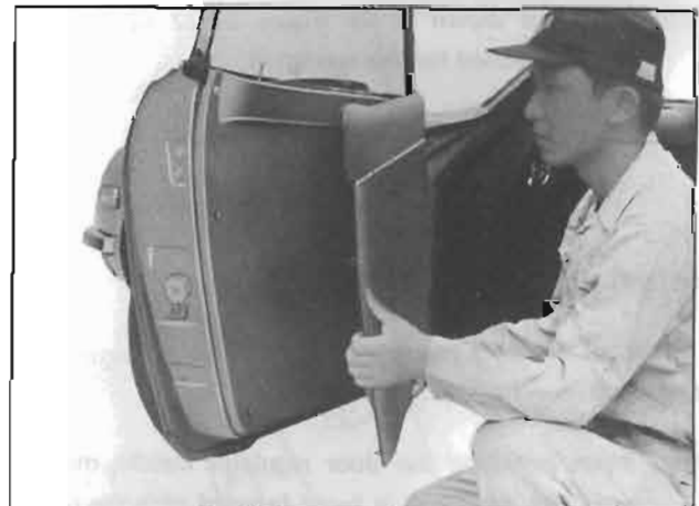
Fig. BF-29 Removing door finish
