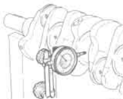
Fig. EM-49 Checking crankshaft bend
