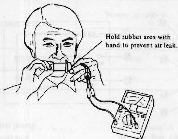
Fig. EF-62 Checking altitude switch
