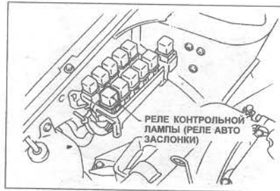
Рис. 3.27 Расположение реле контрольной лампы/автоматической заслонки (Глава 17)
