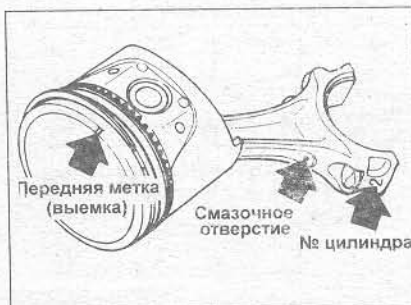
Рис. 1.34 Установка сборки поршень-шатун (Глава 18)
