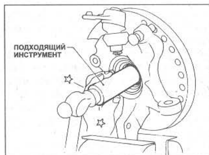
Рис. 10.5 Снятие ступицы с крепежного элемента (Глава 4)
