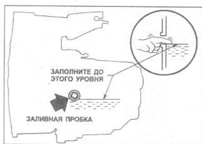
Рис. 6.1 Проверка уровня трансмиссионного масла - модели 1.6 литров (Глава 2)
