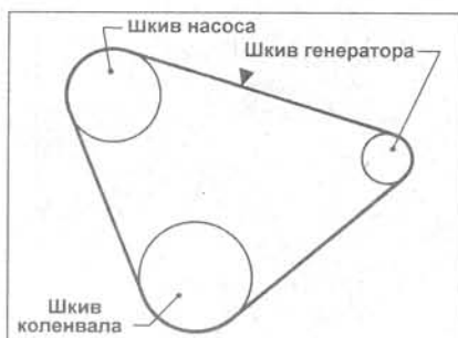
Рис. 2.5 Проверка натяжения приводного ремня - 1.6L, 1.6LS без усилителя рулевого управления (Глава 7)
