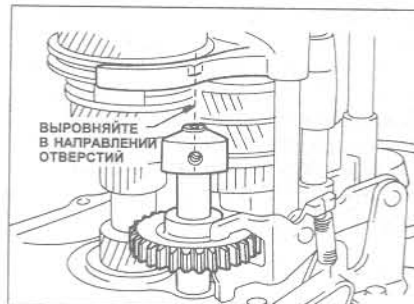
Рис. 6.40 Правильное выравнивание промежуточного вала заднего хода (Глава 14)
