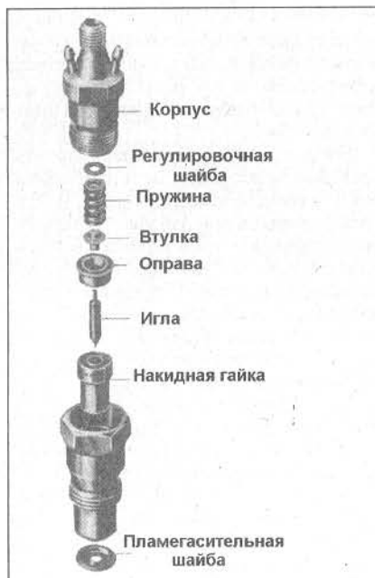
Рис.1.44 Детали топливной форсунки (Глава 37)
