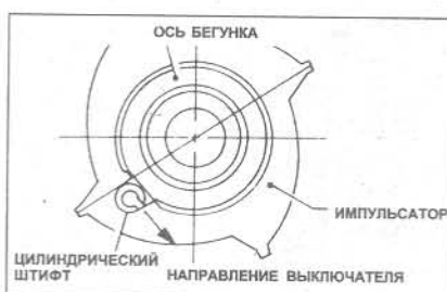
Рис. 4.8 Правильное расположение цилиндрического штифта в импульсаторе (Глава 4)
