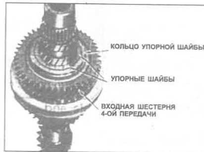
Рис. 6.35 Установка упорных шайб и кольца шестерни 40й передачи (Глава 14)
