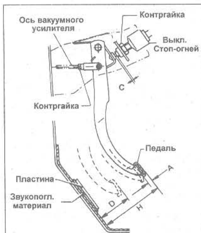
Рис. 9.3 Детали регулировки тормозной педали (Глава 2) См. Спецификации для фактических размеров
