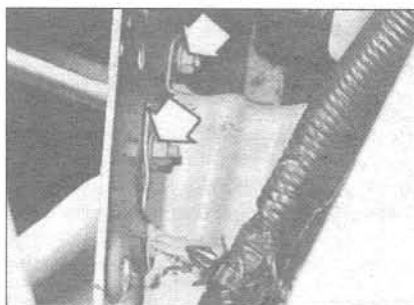
12.5В Монтажные гайки переднего бампера (отмечены стрелками)
