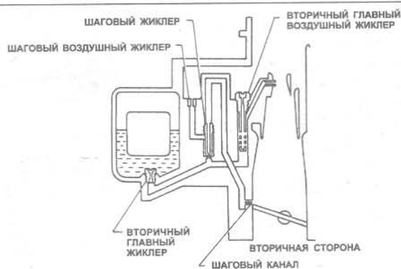
Рис. 3.11 Шаговая система карбюратора - типичная (Глава 16)
