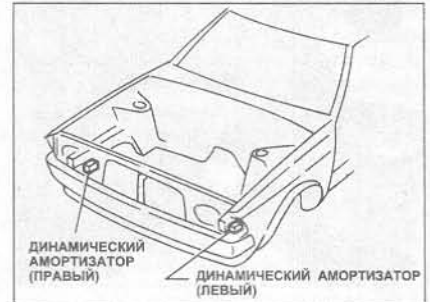
Рис. 1.24 Расположение динамических амортизаторов - автоматическая трансмиссия (Глава 10)
