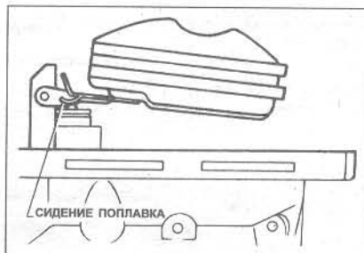
Рис. 3.19 Расположение сидения поплавка - модели 1.6 и 1.8 литров (Глава 17)
