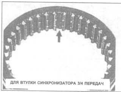
Рис. 6.34 Расположение вставки пружины на втулке синхронизатора 3/4 передач (Глава 14)
