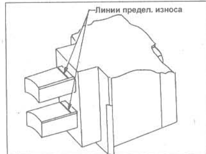
Рис. 12.2 Метки предельного износа щеток генератора (Глава 6)
