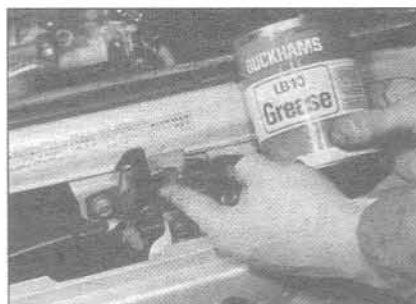
4.2 Смажьте механизм выпуска капота и дверные замки
