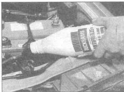
2.2В Дополните в радиатор, если расширительный бачок оказался пустым
