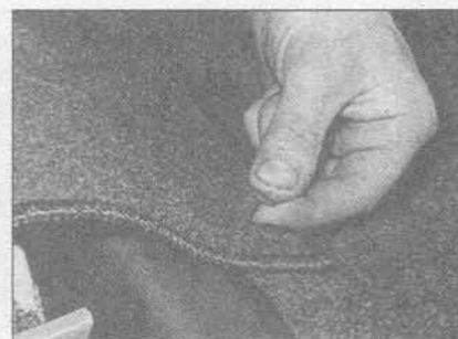
34.9 Покрытие заднего сидения прикреплено к полу багажного отделения монтажными скобами
