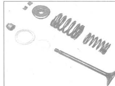
17.11 Компоненты клапана - в порядке сборки
