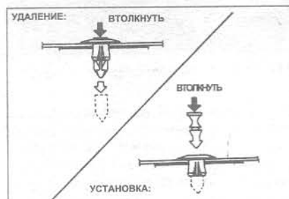
Рис. 11.5 Детали крепления переднего спойлера (Глава 11)
