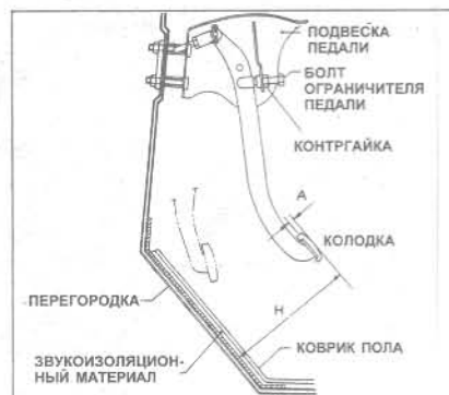
Рис. 5.3 Детали регулировки сцепления, у педали (Глава 2)
