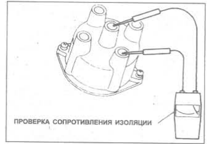
Рис. 4.4 Проверка изоляции крышки прерывателя-распределителя (Глава 4)
