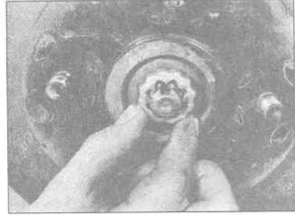
12.3 Снимите крышку, извлеките штифт, достаньте кольцо блокирования
