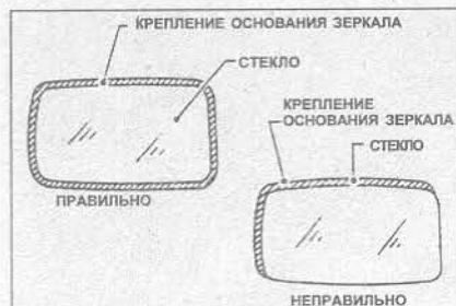
Рис. 11.20 Выступающее крепление должно охватывать стеклянные грани равномерно (Глава 32)
