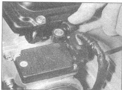
41.17 Регулировочный винт смеси холостого хода под заглушкой в измерителе воздушного потока
