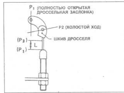
Рис. 7.7 Проверка движения тросика понижения (Глава 5) "L" = 39 - 43 мм Для P1 и P2 см. текст
