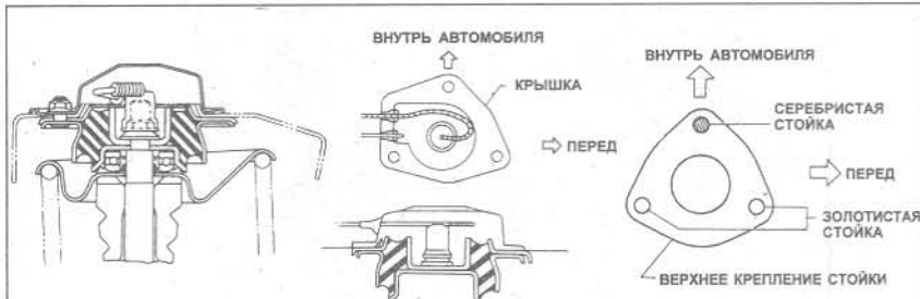
Рис. 10.13 Детали верхнего крепления регулируемой стойки подвески (Глава 6)
