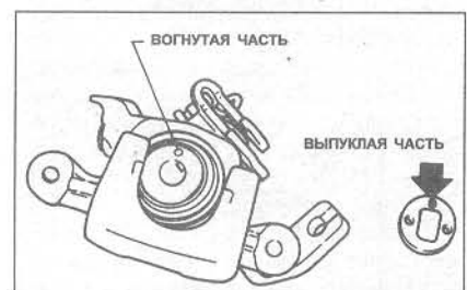
Рис. 9.25 Правильное совмещение стопорной пластины с корпусом суппорта (Глава 25)
