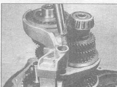
10.58 Смазкой зафиксируйте цилиндрическую пружину на валу вилки смещения
