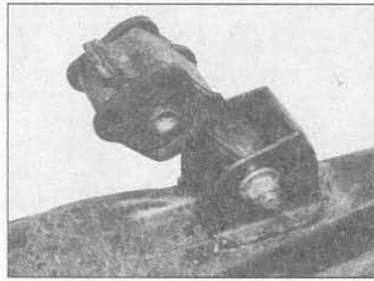
10.6 Замените буферный стержень, если он жестко двигается
