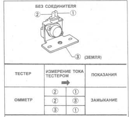
Рис. 4.18 Прозвонка транзистора мощности (Глава 14)
