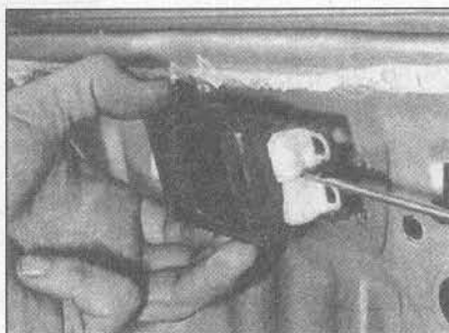
26.20 Снятие внутренней ручки двери
