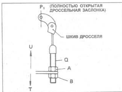
Рис. 7.6 Регулировка тросика понижения (Глава 5) Значения см. в тексте
