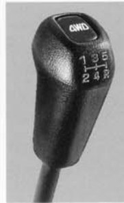
Schalthebel für 4-Rad-Antrieb und 5-Gang-Getriebe
