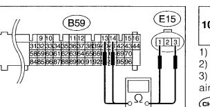
CHECK HARNESS BETWEEN ECM AND IDLE 10AP5 AIR CONTROL SOLENOID VALVE CONNEC-TOR.
